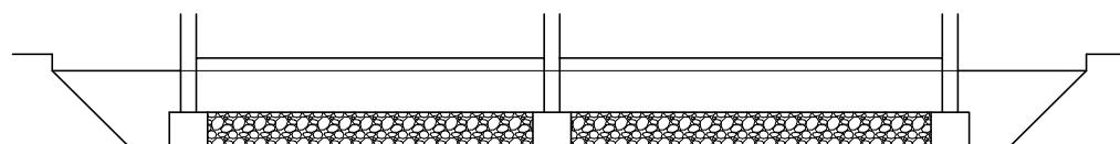
$V_{z1} - \text{gornj dio unutarnjeg zatrpanja} = 66.64 \text{ m}^3$
