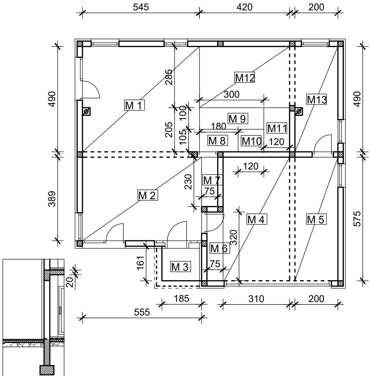
BETONIRANJE (debljina ab ploče d=20 cm)
