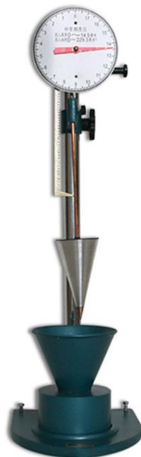
Slika 12, Aparatura za mjerenje konzistencije
