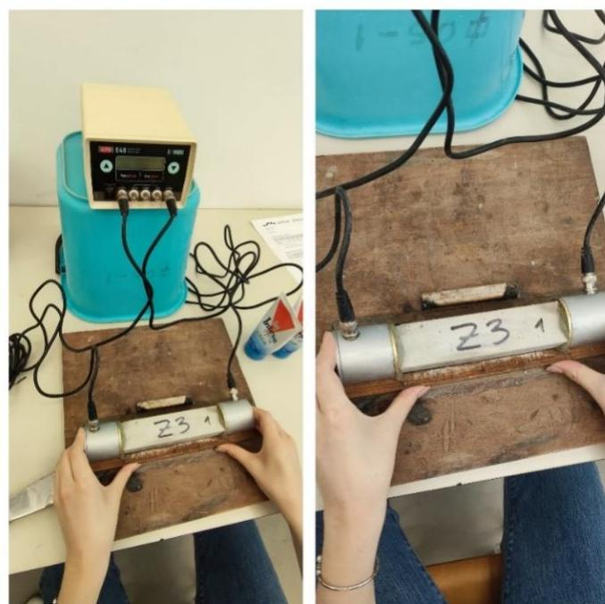
Slika 22, Ispitivanje ultrazvukom [slika iz laboratorija]
