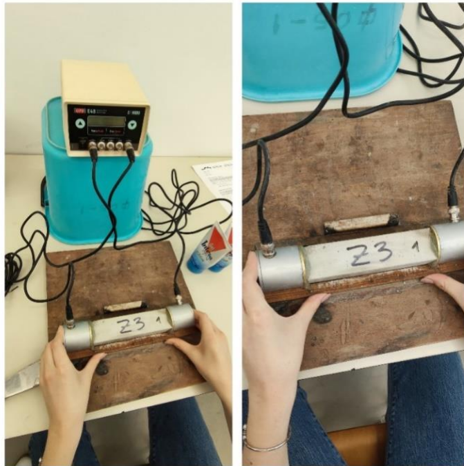
Slika 22, Ispitivanje ultrazvukom [slika iz laboratorija]
