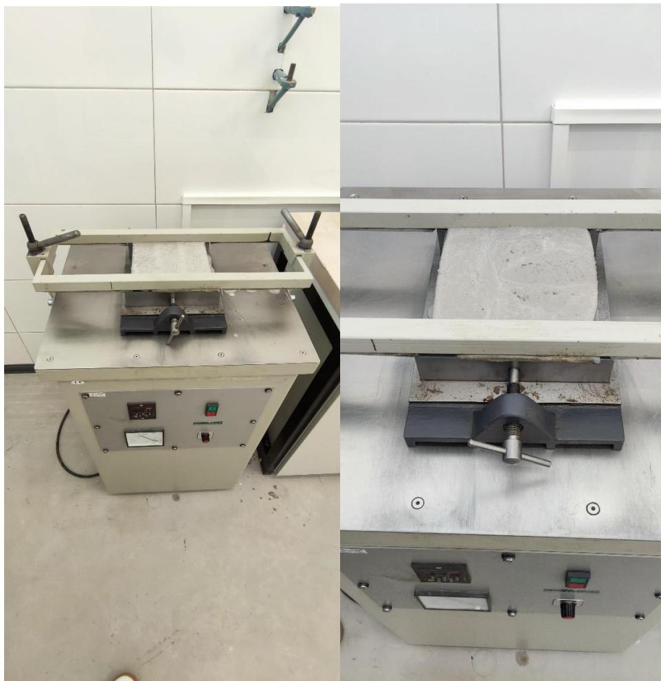
*Slika 18, Ugradnja morta u kalupe [slika iz laboratorija]*
