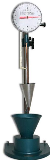
Slika 12, Aparatura za mjerjenje konzistencije
