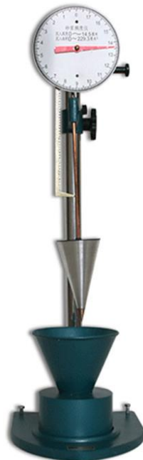
Slika 12, Aparatura za mjerenje konzistencije
