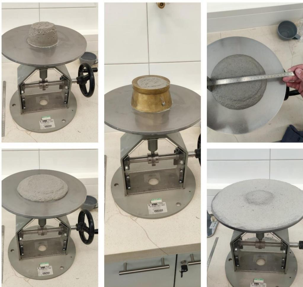
Slika 16, Ispitivanje obradivosti [slika iz laboratorija]
