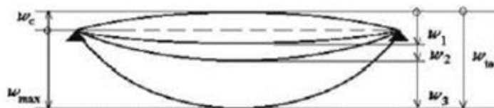
Slika 7.3 Prikaz progiba grede
