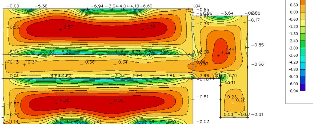
Slika 6.8 Potrebna površina armature  $A_s(\text{cm}^2/\text{m})$  u y smjeru
