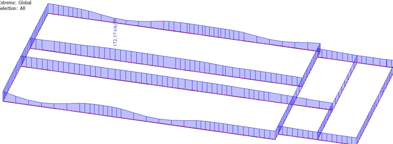
Slika 9.5 Linijske reakcije na mjestima oslanjanja zidova na temeljne trake (Kn/m) za kombinaciju GSN-1
