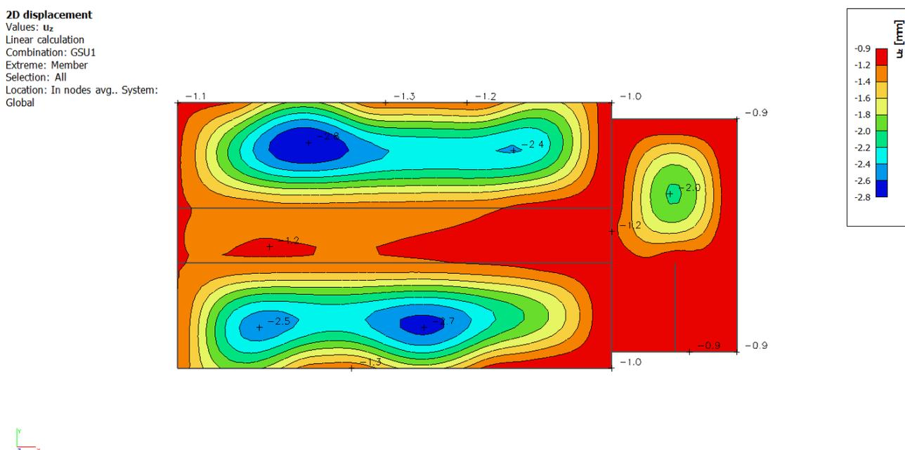
Slika 6.21 Progib ploče (mm) za kombinaciju GSU-1
