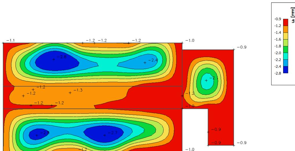
Slika 6.10 Progib ploče (mm) za kombinaciju GSU-2
