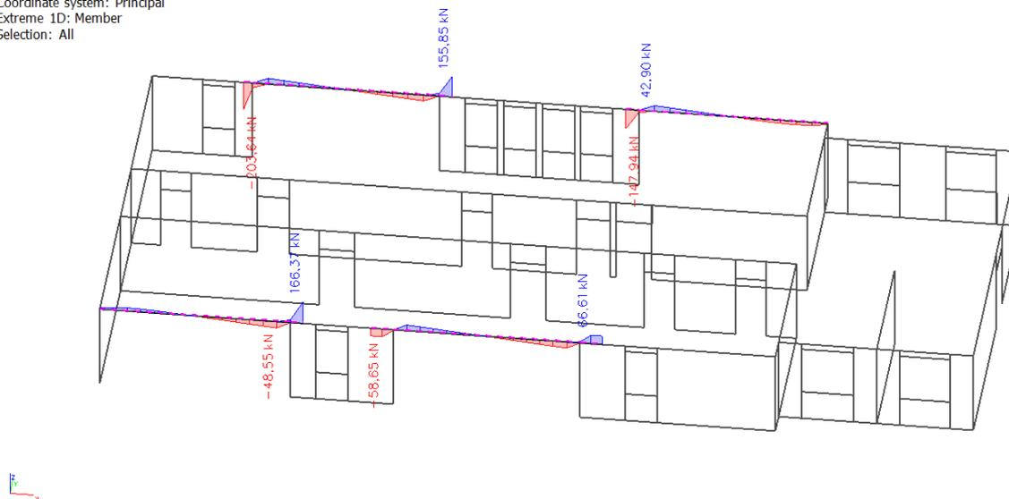
Slika 7.2 Poprečne sile  $V_{Ed,z}$  (kN/m) za GSN
