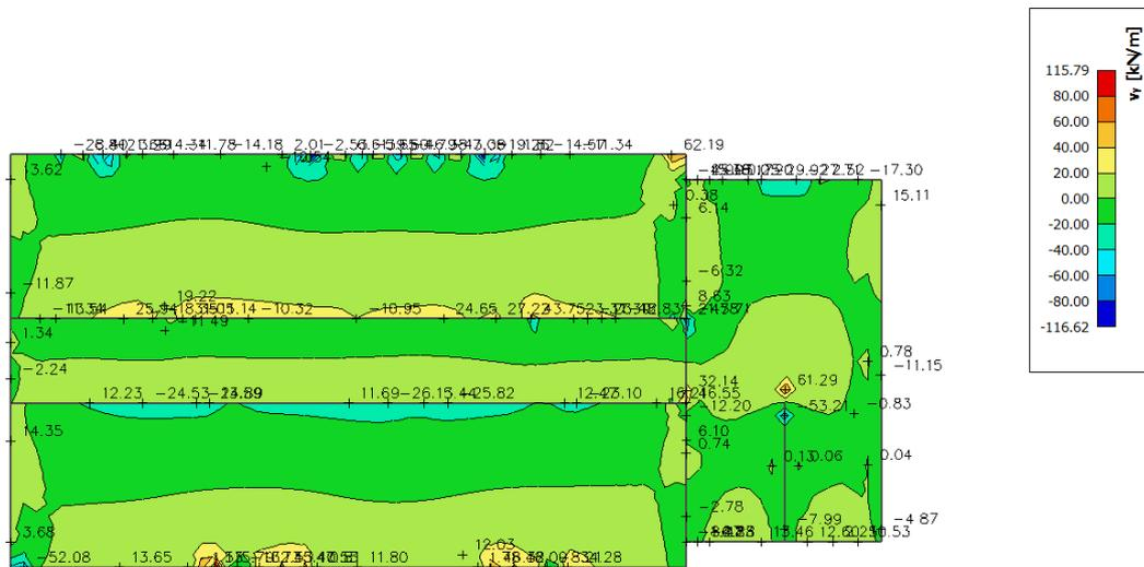
Slika 6.18 Poprečne sile  $V_{Ed,y}$  (kN/m) za GSN
