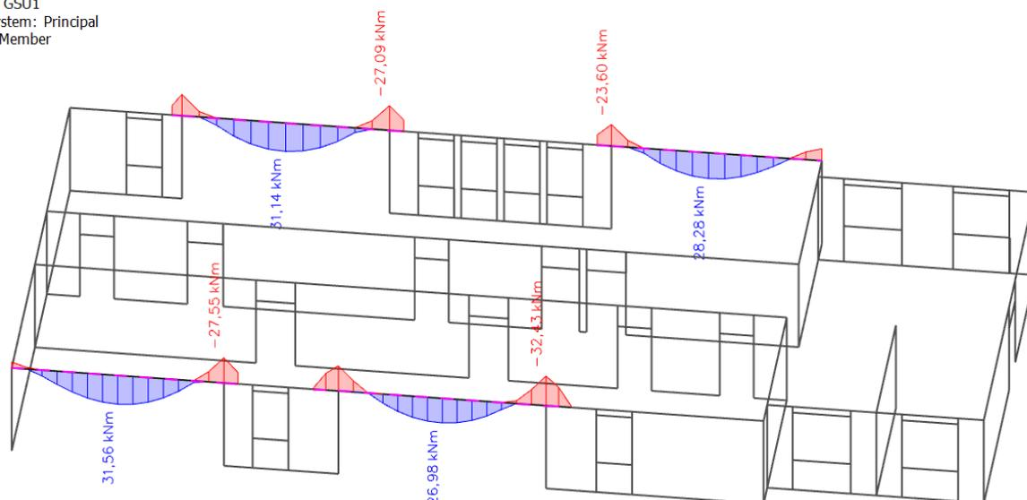
Slika 7.9 Moment savijanja  $M_{Ed,y}$  (kNm) za GSU-1
