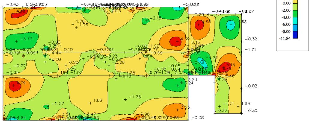
Slika 6.4 Moment savijanja  $M_{Ed,xy}$  (kNm/m) za GSN-1
