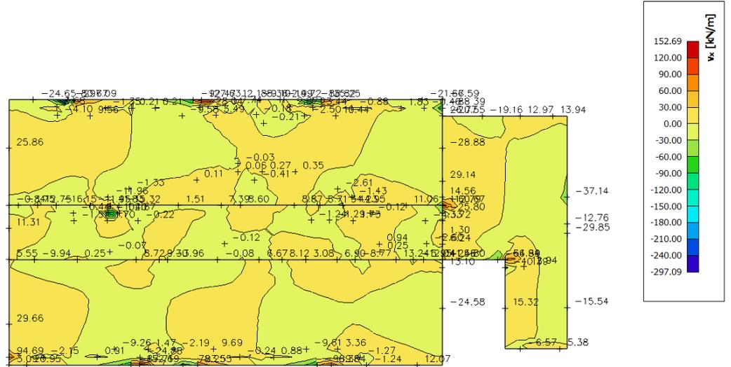
Slika 6.5 Poprečne sile  $V_{Ed,x}$  (kN/m) za GSN-1
