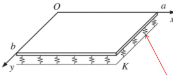
Slika 9.1 Međudjelovanje konstrukcija – tlo modelirano Winkler- ovim modelom
