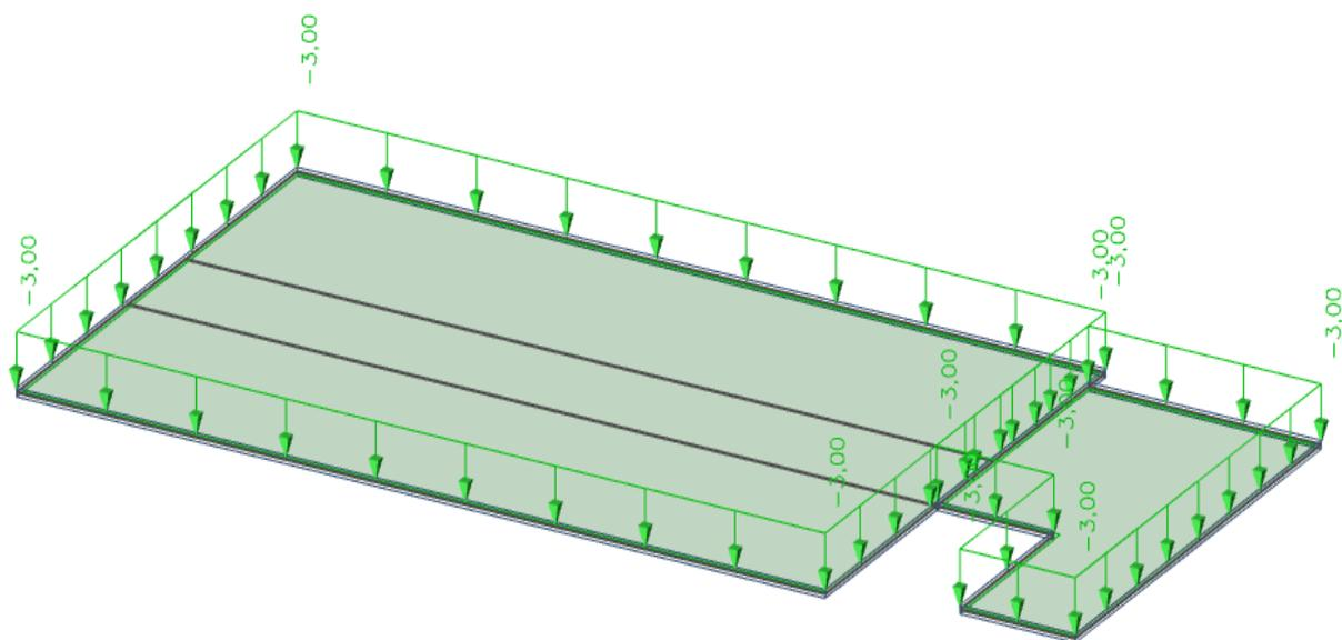
Slika 4.2.2 Promjenjivo djelovanje  $Q$  [ $\text{kN/m}^2$ ]
