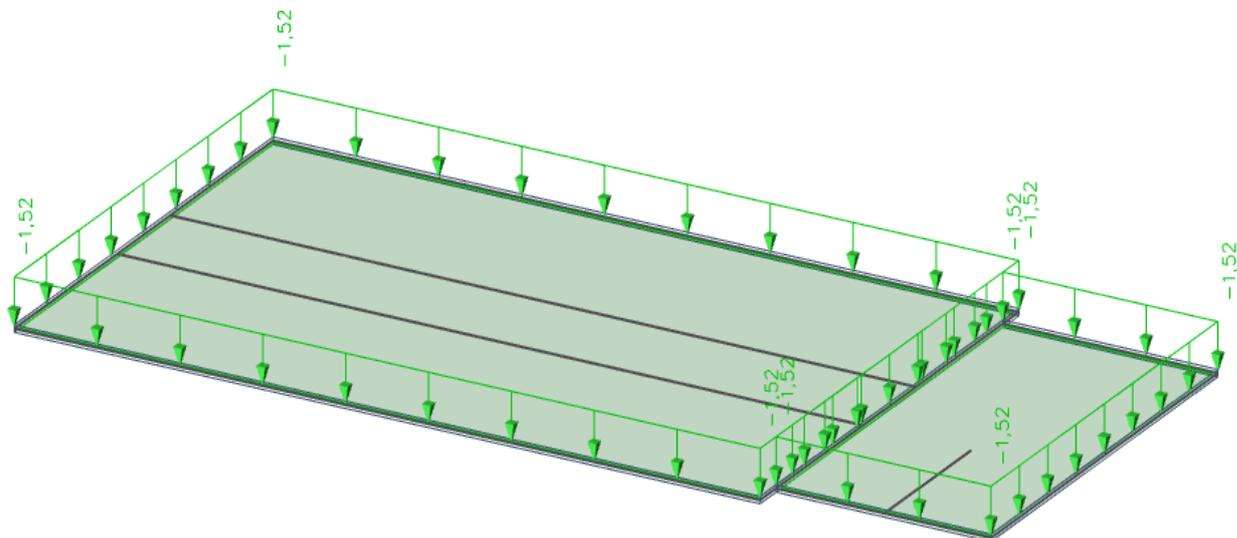
Slika 4.1.1 Dodatno stalno djelovanje  $G_1$  [ $\text{kN/m}^2$ ]
