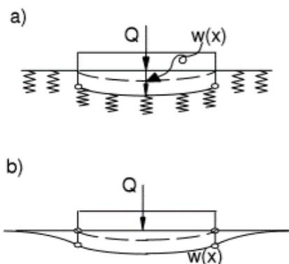
Slika 9.2 Winklerov model (a) i stvarni nosač (b)
