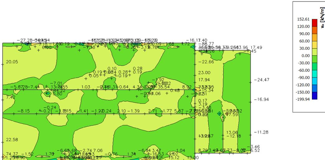
Slika 6.17 Poprečne sile  $V_{Ed,x}$  (kN/m) za GSN-1
