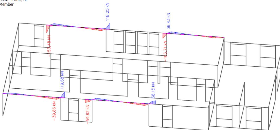
Slika 7.7 Poprečne sile  $V_{Ed,z}$  (kN/m) za GSN
