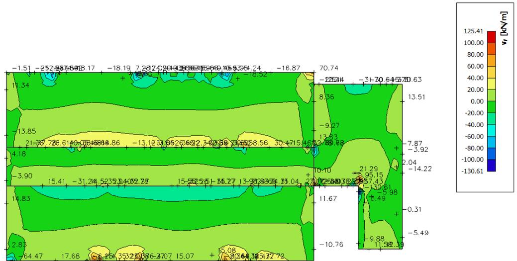
Slika 6.6 Poprečne sile  $V_{Ed,y}$  (kN/m) za GSN-1
