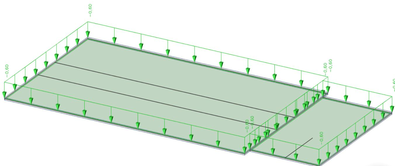
Slika 4.1.2 Promjenjivo djelovanje  $Q$  [ $\text{kN/m}^2$ ]
