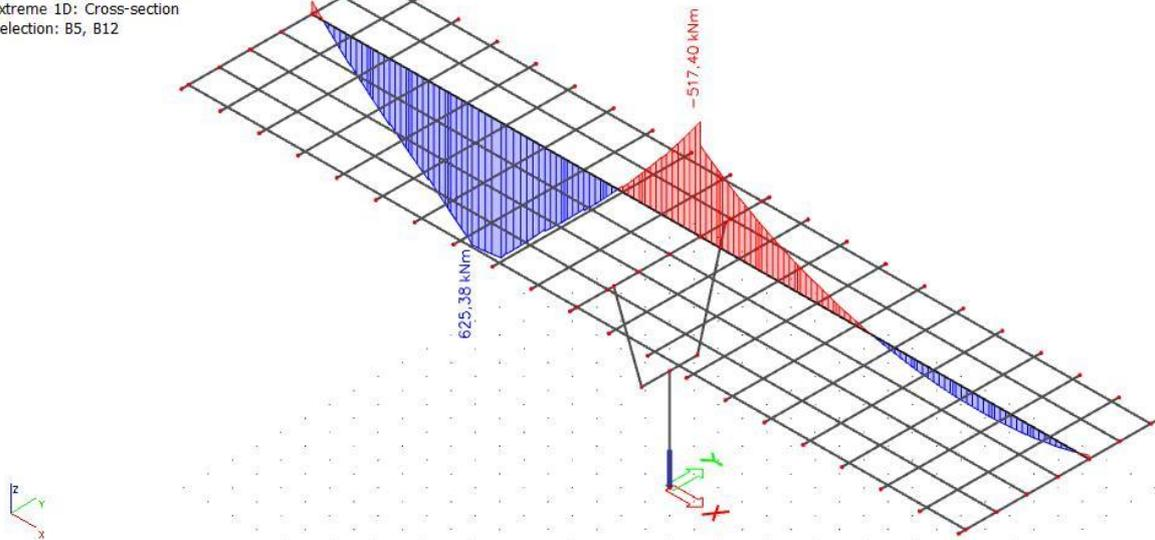
Slika 20. Pokretno – maksimalni moment nad stupom – momenti ( $M_y$ ) u kNm**1D internal forces**Values:  $V_z$
