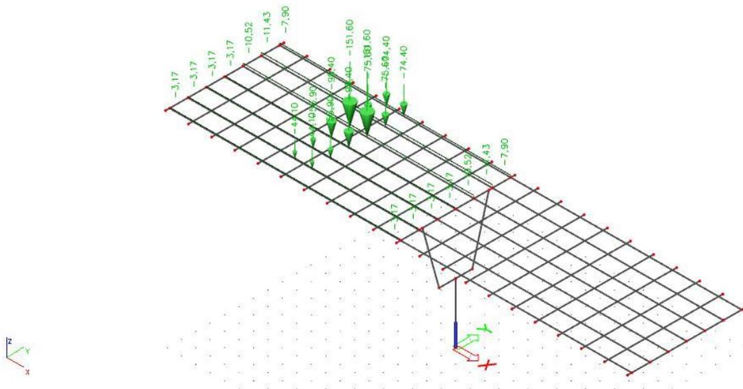
*Slika 14. Pokretno opterećenje za maksimalni moment u prvom polju*
