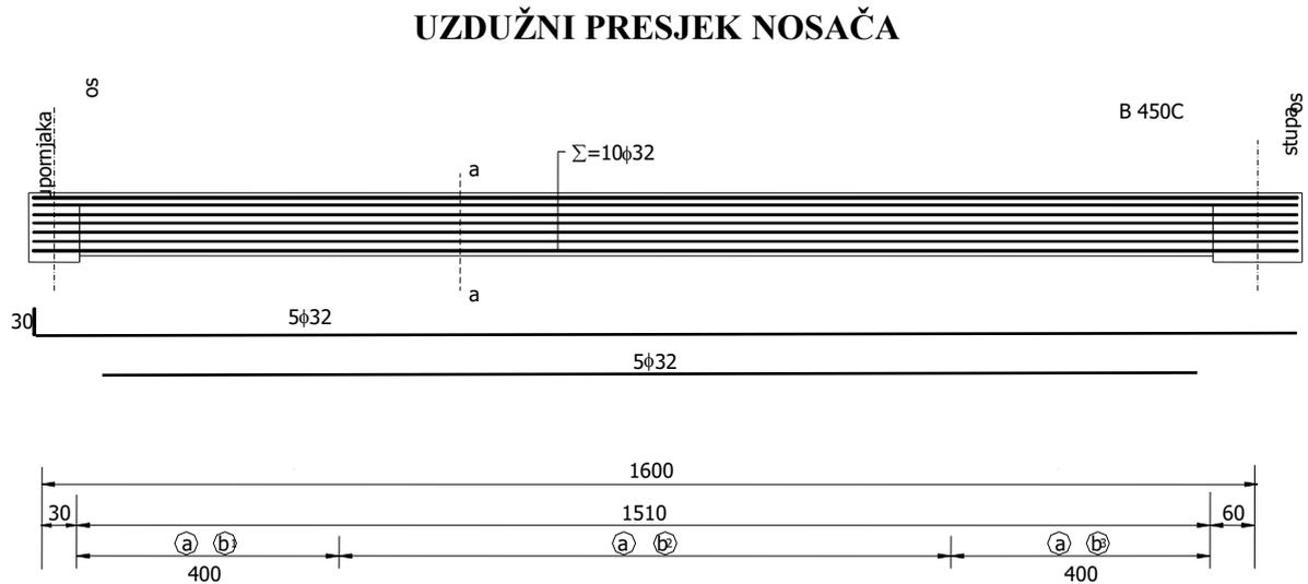
Slika 32. Prikaz armiranja uzdužnog nosača u polju
