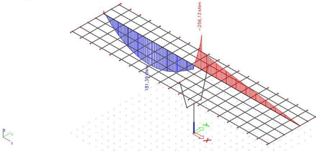
Slika 24. Pokretno – maksimalna poprečna sila pri stupu – momenti ( $M_y$ ) u kNm**1D internal forces**Values:  $V_z$
