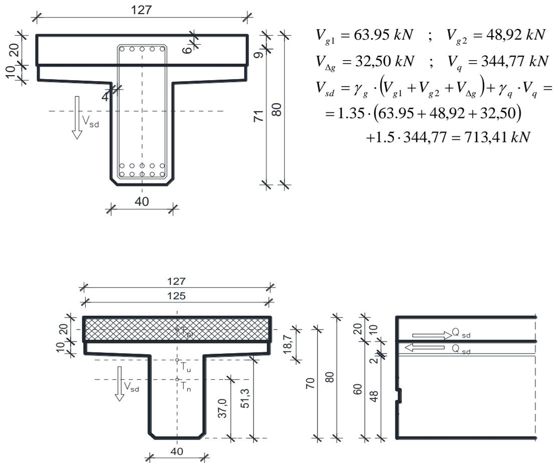
Slika 31. Poprečni presjek spregnutog T nosača
