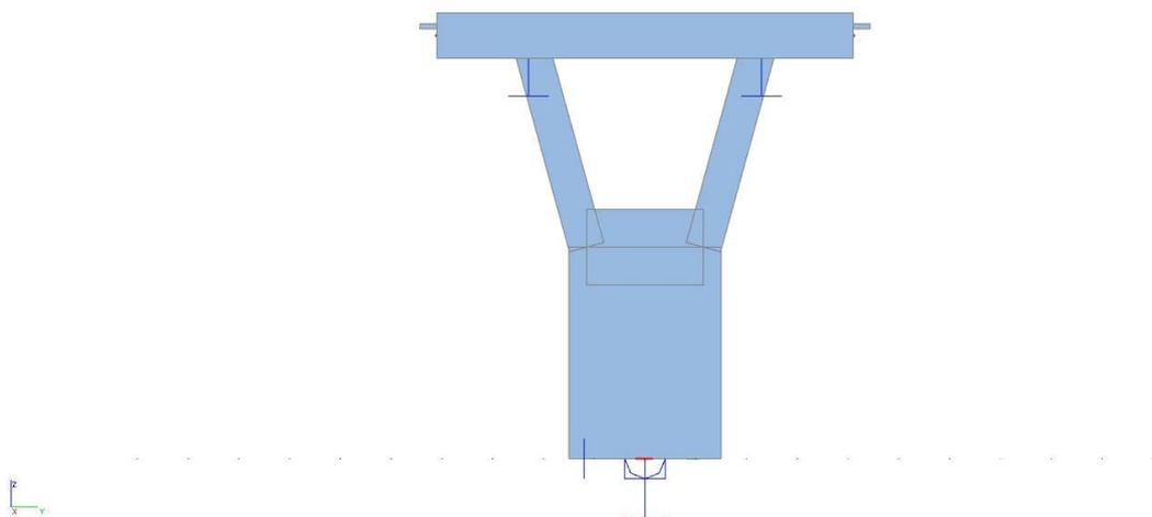
Za proračun rasponske konstrukcije na utjecaje ostalog stalnog tereta i prometnog opterećenja korišten je prostorni štapni model konstrukcije.
