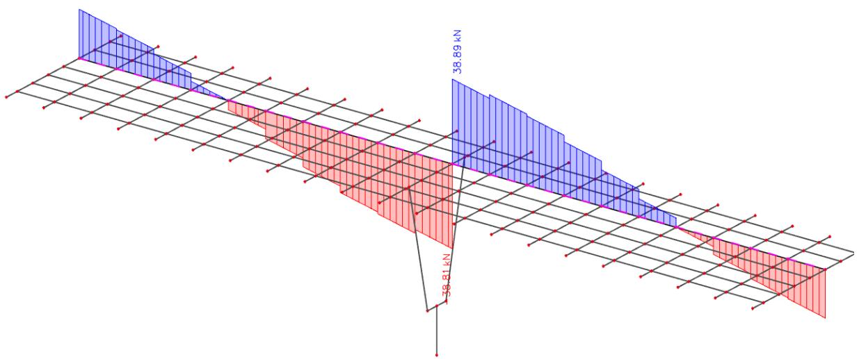
Slika 12. Dodatno stalno opterećenje – poprečne sile ( $V_z$ ) u kN
