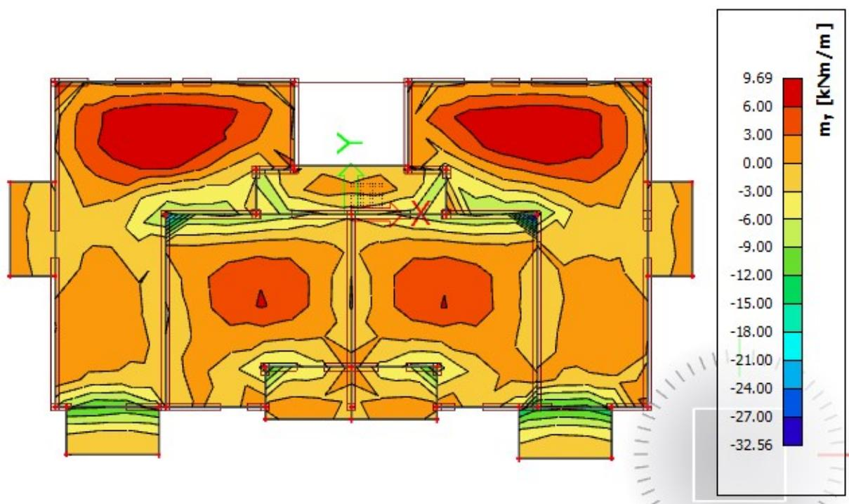
Slika 31  $M_{Sd,y}$  [ $\text{kNm/m}$ ] = računski momenti savijanja u smjeru lokalnih osi za  $q_{Sd}=1.0 \text{ G} + 1.0Q$
