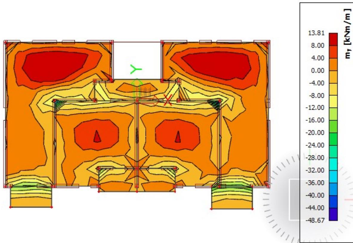
Slika 38  $M_{Sd,y}$  [kNm/m] = računski momenti savijanja u smjeru lokalnih osi za  $q_{Sd}=1.35 G + 1.5Q$
