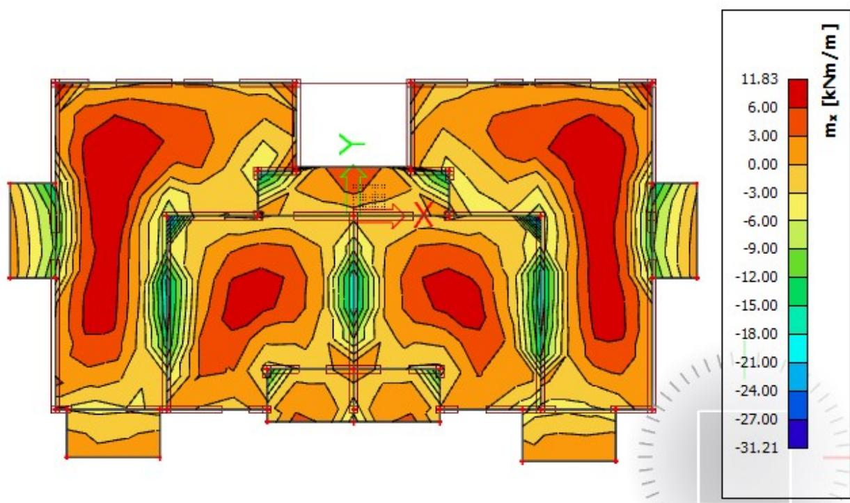
Slika 28  $M_{sd,x}$  [kNm/m] = računski momenti savijanja u smjeru lokalnih osi za  $q_{sd}=1.35 G + 1.5Q$
