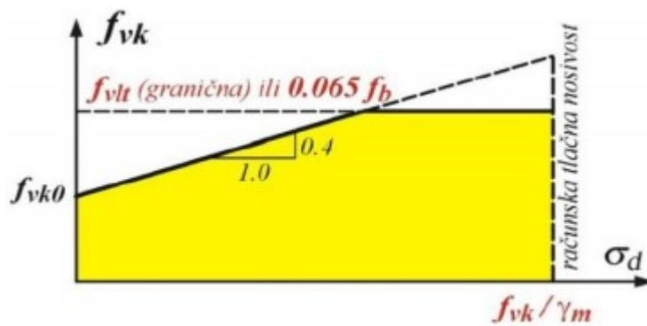
Slika 5 Ovisnost posmične čvrstoće i tlačnog naprezanja [1]
