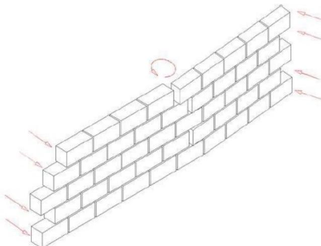
Slika 9 Ravnina otkazivanja paralelna vertikalnim sljubnicama  $f_{xk2}$  [1]
