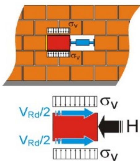
Slika 7 Ispitivanje posmične čvrstoće zida "in situ" [1]
