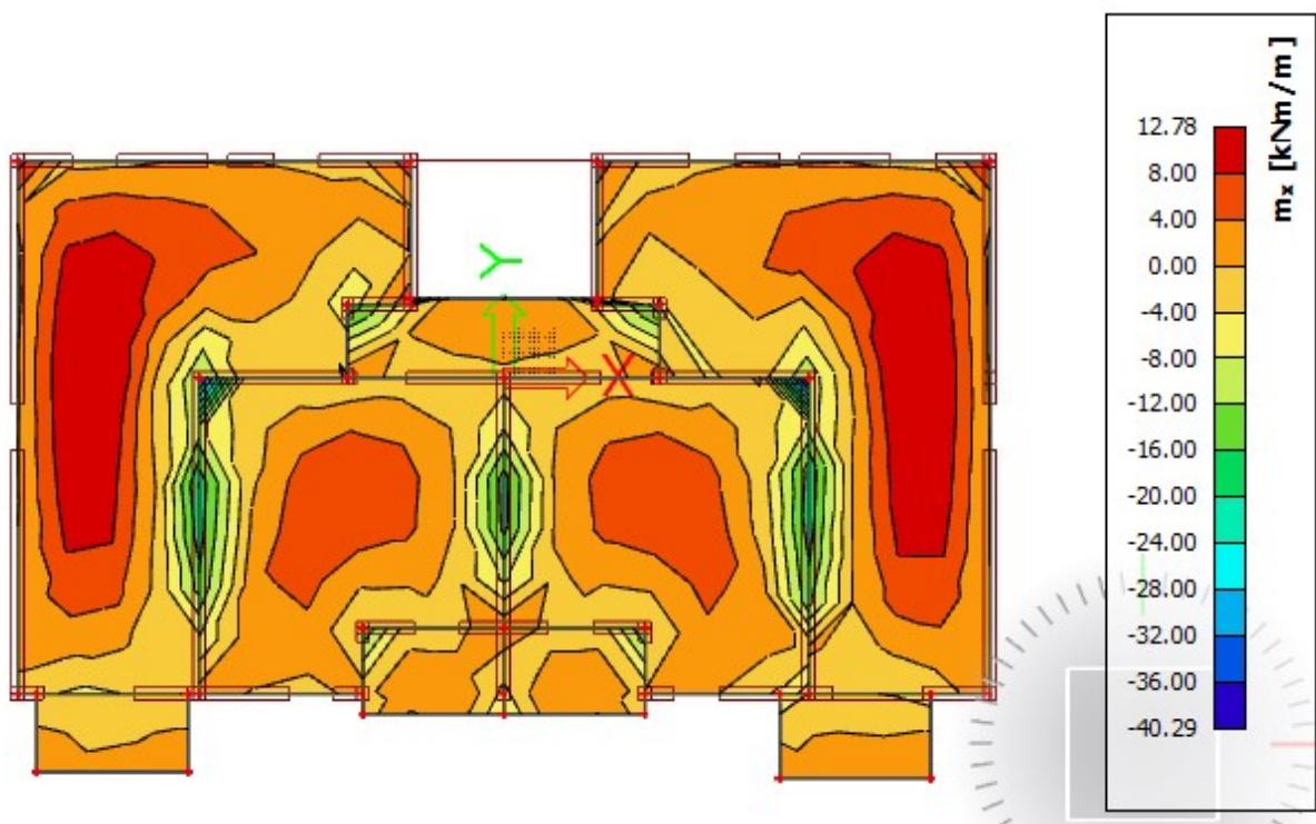
Slika 37  $M_{Sd,x}$  [kNm/m] = računski momenti savijanja u smjeru lokalnih osi za  $q_{Sd}=1.35 G + 1.5Q$
