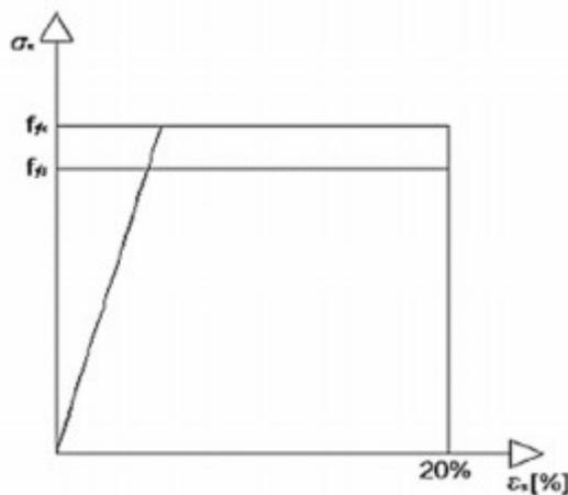
Slika 15 Radni dijagram čelika [3]
