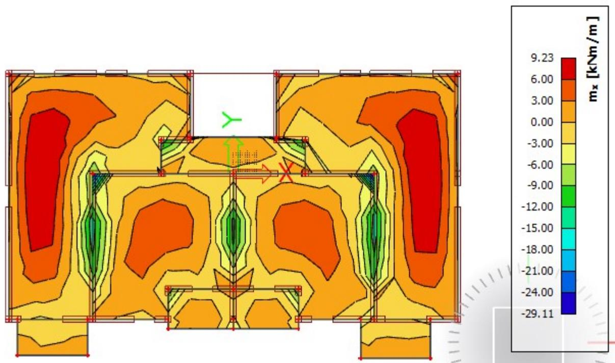
Slika 39  $M_{Sd,x}$  [ $\text{kNm}/\text{m}$ ] = računski momenti savijanja u smjeru lokalnih osi za  $q_{Sd}=1.0 \text{ G} + 1.0\text{Q}$
