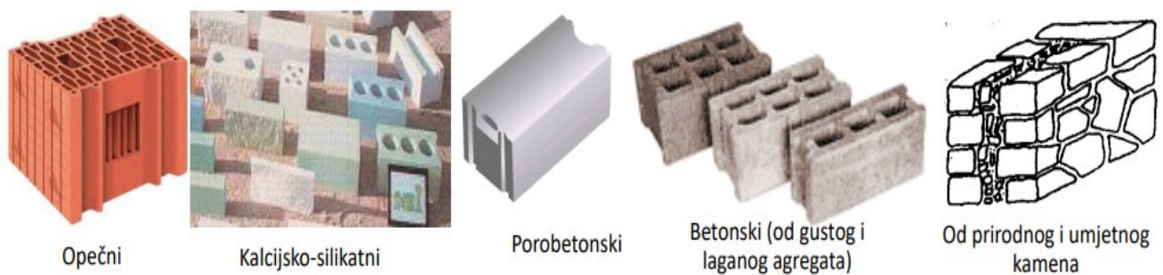
Slika 1 Neke vrste zidnih elemenata[1]
