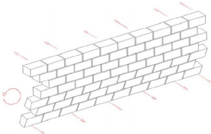
Slika 8 Ravnina otkazivanja paralelna horizontalnim sljubnicama  $f_{xk1}$  [1]
