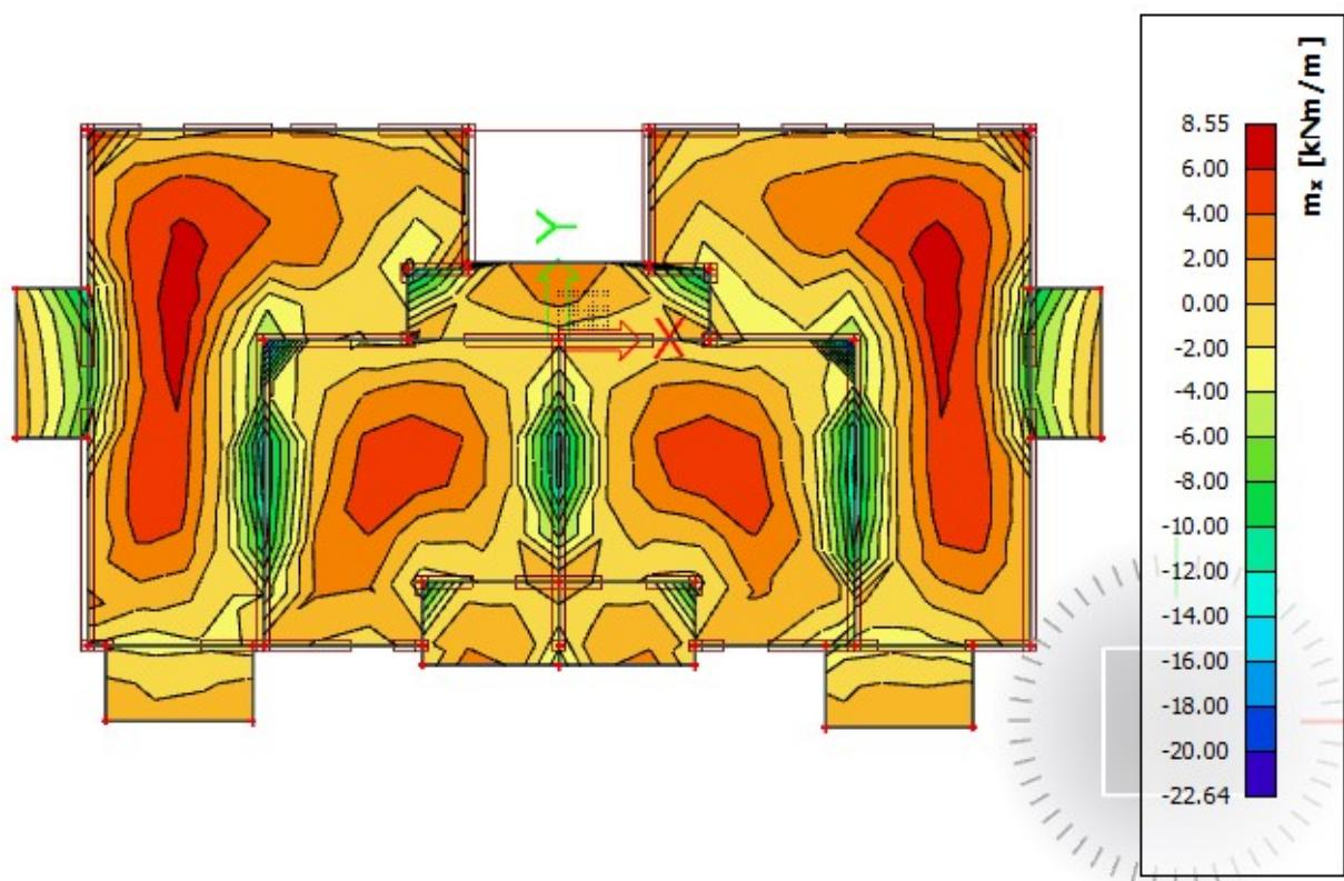
Slika 30  $M_{Sd,x}$  [ $\text{kNm/m}$ ] = računski momenti savijanja u smjeru lokalnih osi za  $q_{Sd}=1.0 \text{ G} + 1.0Q$
