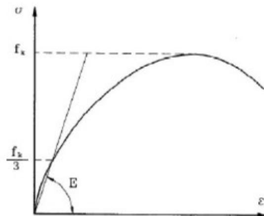
Slika 11 Dijagram naprezanja - relativna deformacija [1]
