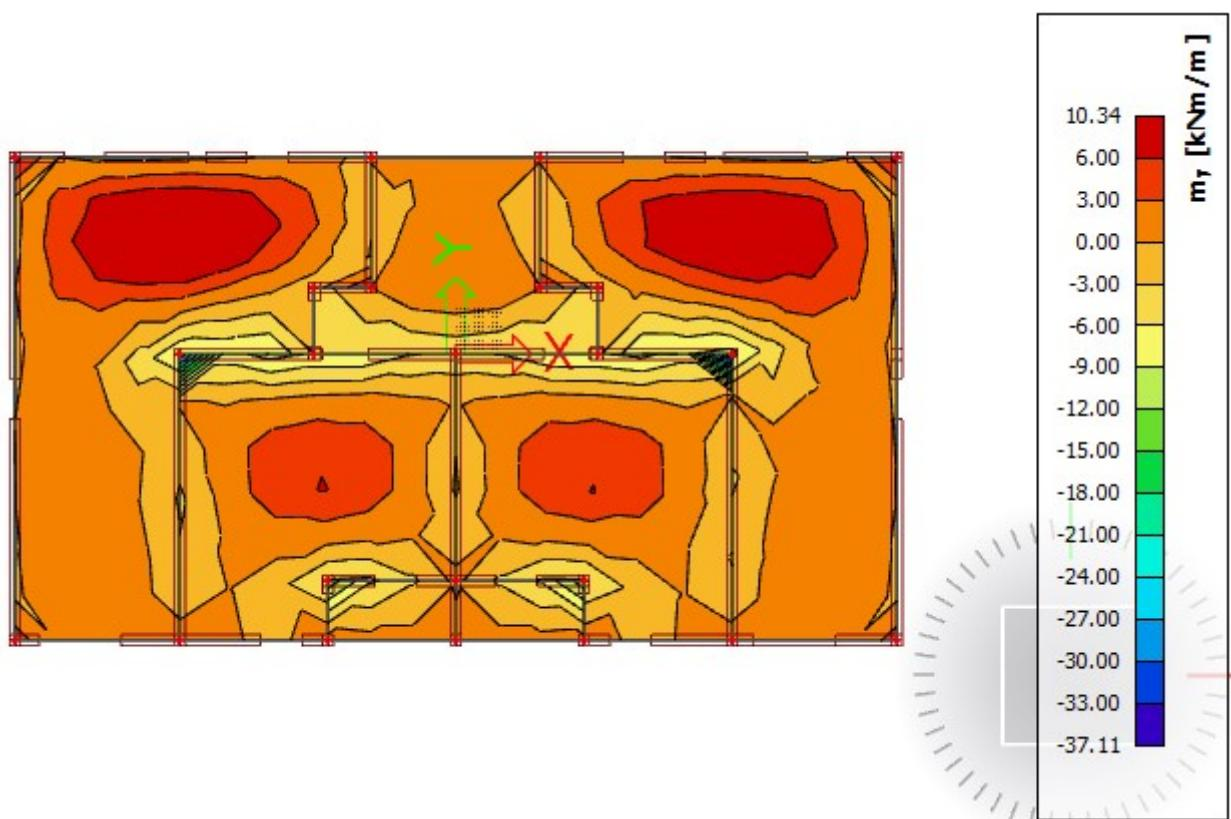
Slika 49  $M_{sd,y}$  [ $\text{kNm}/\text{m}$ ] = računski momenti savijanja u smjeru lokalnih osi za  $q_{Sd}=1.0 \text{ G} + 1.0 \text{ Q}$
