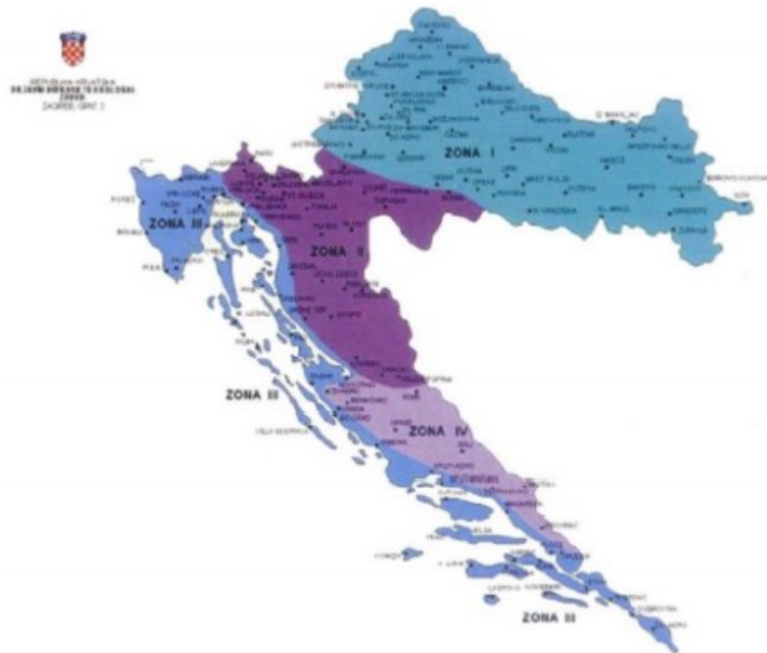
Slika 16 Podjela RH na zone opterećenja snijegom
