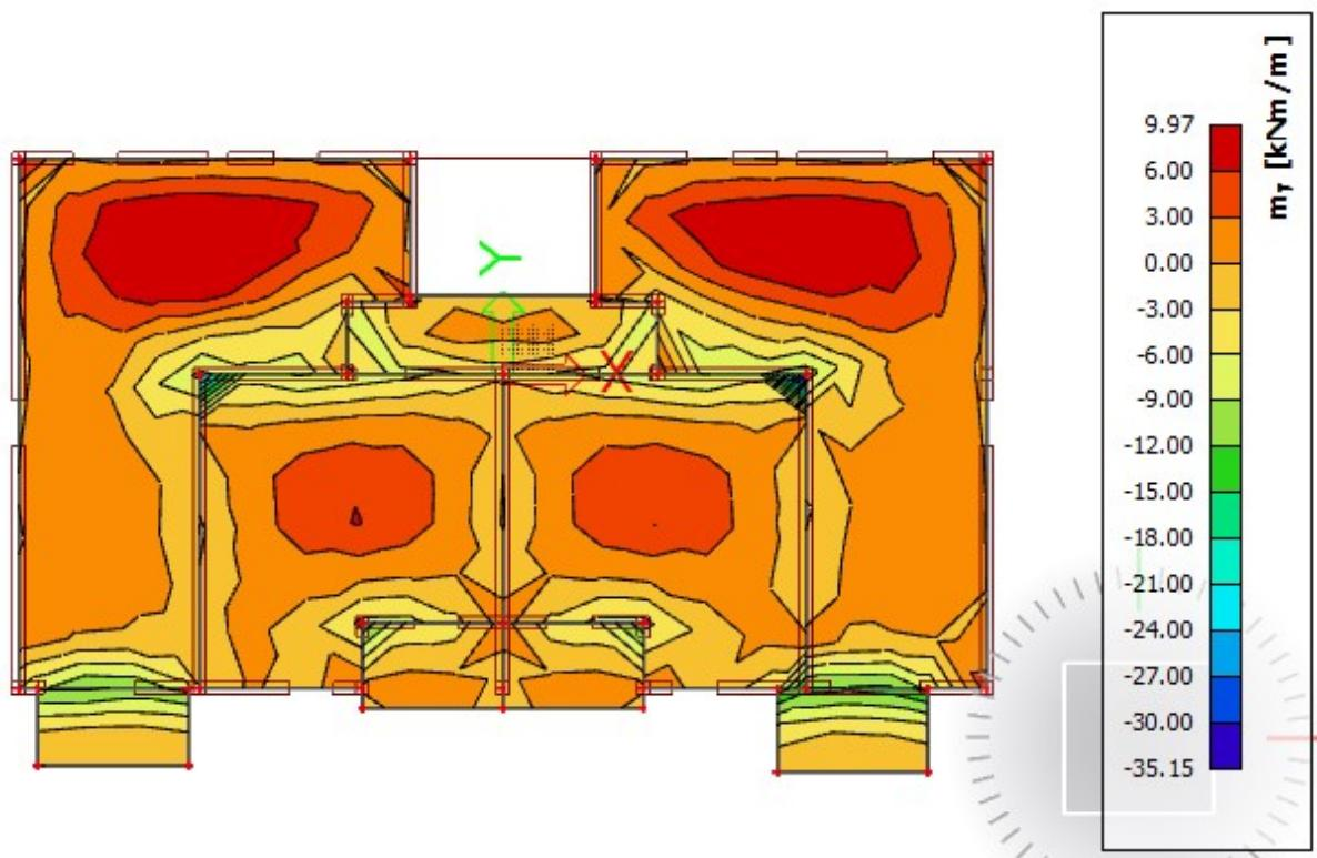
Slika 40  $M_{Sd,y}$  [ $\text{kNm}/\text{m}$ ] = računski momenti savijanja u smjeru lokalnih osi za  $q_{Sd}=1.0 \text{ G} + 1.0\text{Q}$
