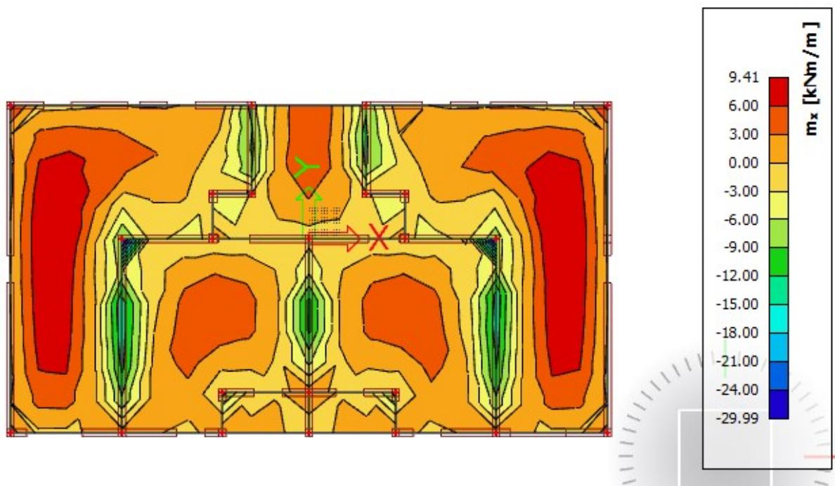
Slika 48  $M_{sd,x}$  [ $\text{kNm}/\text{m}$ ] = računski momenti savijanja u smjeru lokalnih osi za  $q_{Sd}=1.0 \text{ G} + 1.0 \text{ Q}$
