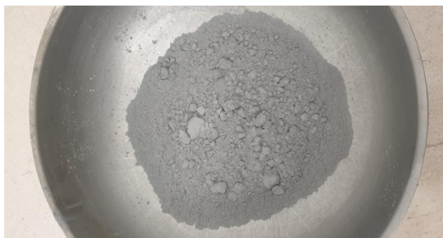
Slika 11. Upotrijebljen leteći pepeo u svrhu ispitivanja
