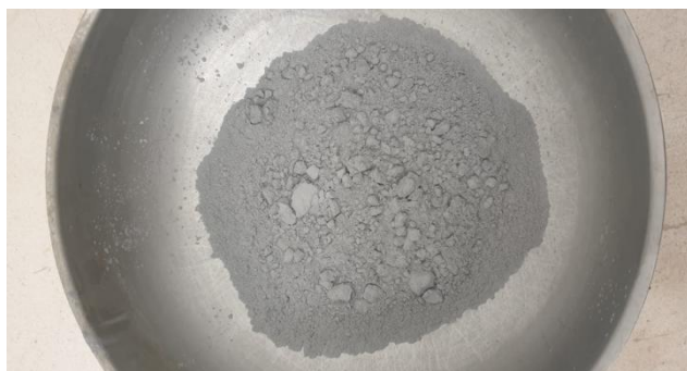
Slika 11. Upotrijebljen leteći pepeo u svrhu ispitivanja
