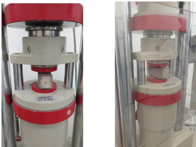
Slika 21. Uređaj za ispitivanje tlačne čvrstoće
