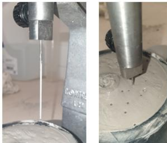
Slika 27. Ispitivanje vremena vezanja paste Vicatovom iglom
