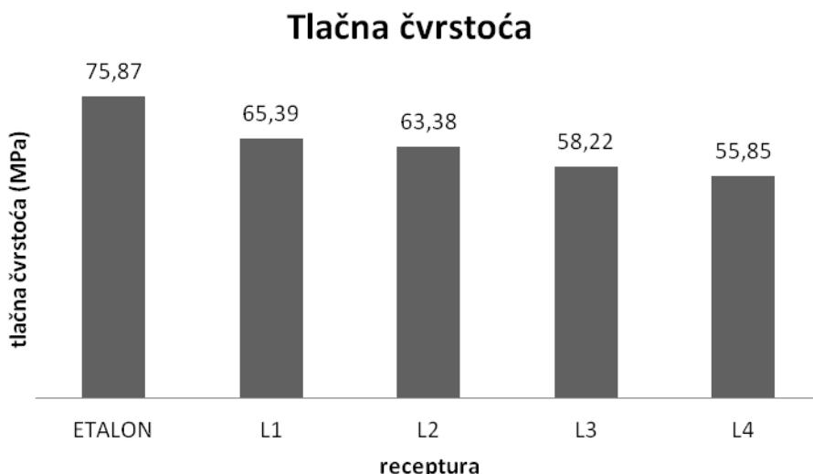
Slika 43. Grafički prikaz tlačne čvrstoće za pojedinu recepturu
