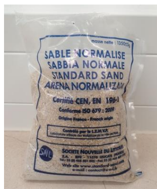
Slika 6. Standardni pijesak CEN (ISO standardni pijesak)
