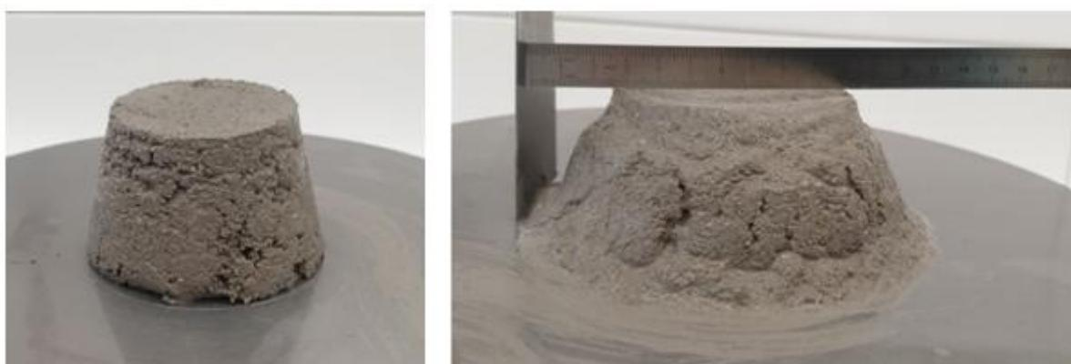
Slika 33. Obradljivost uzorka L3
