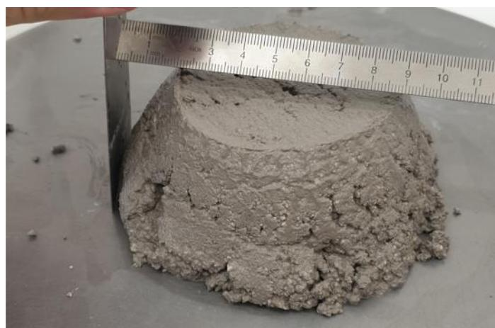
Slika 47. Obradljivost uzorka T2
