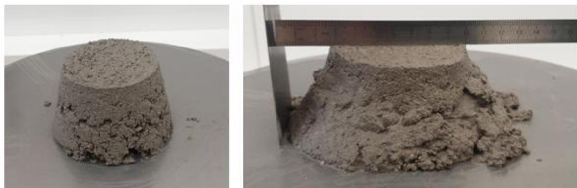
Slika 34. Obradljivost uzorka L4
