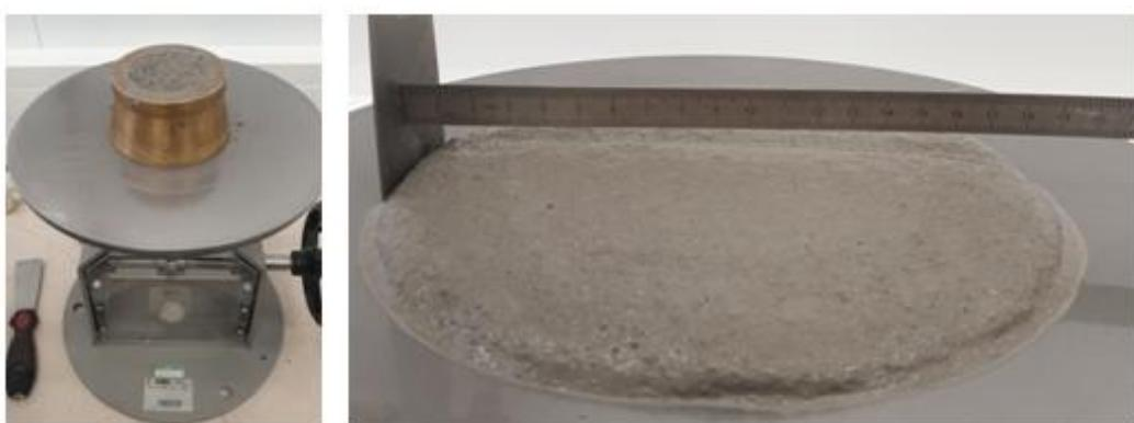
Slika 31. Obradljivost uzorka L1
