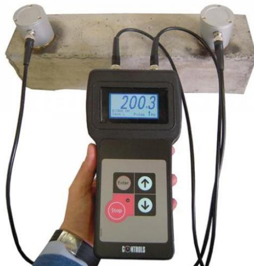
Slika 17.Uređaj za ispitivanje ultrazvuka (proizvođač Controls)
