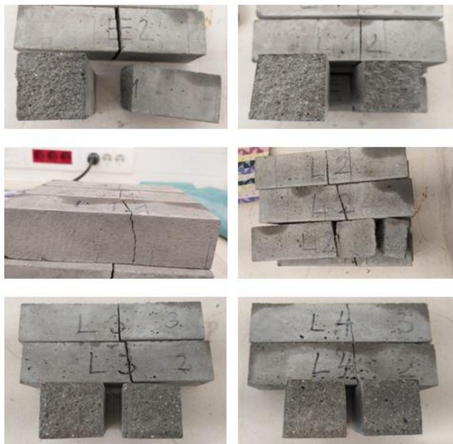
Slika 41. Uzorci nakon ispitivanja čvrstoće
