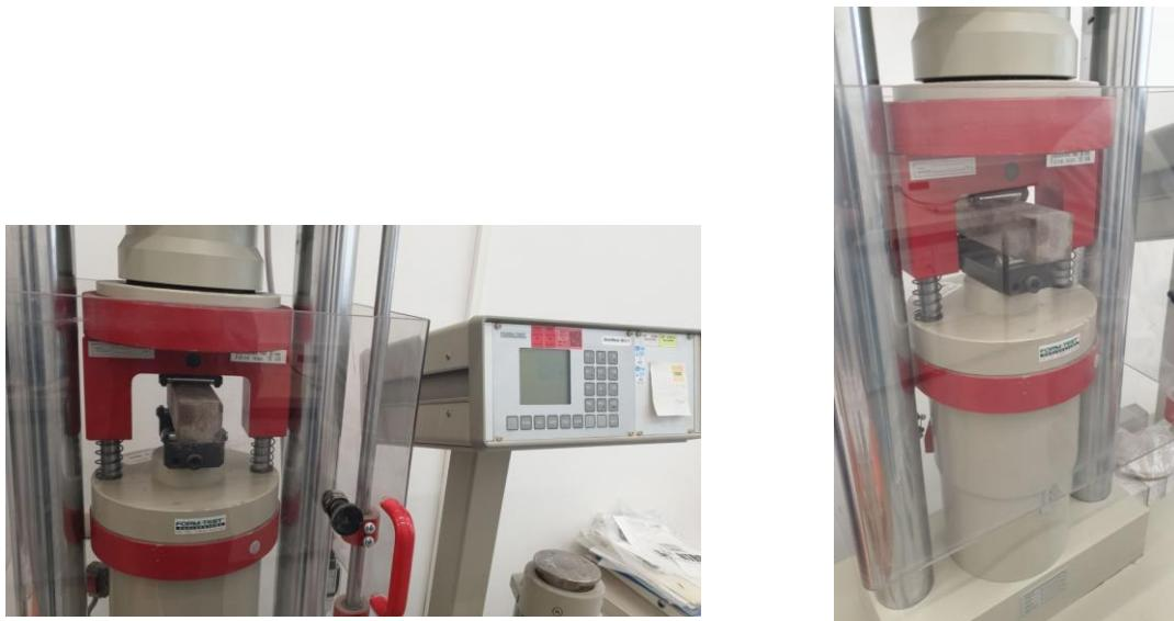
Slika 19. Uredaj za ispitivanje savojne čvrstoće
