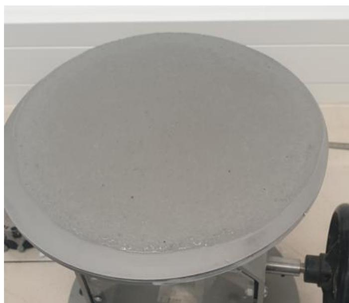
Slika 50. Obradljivost uzorka T6
