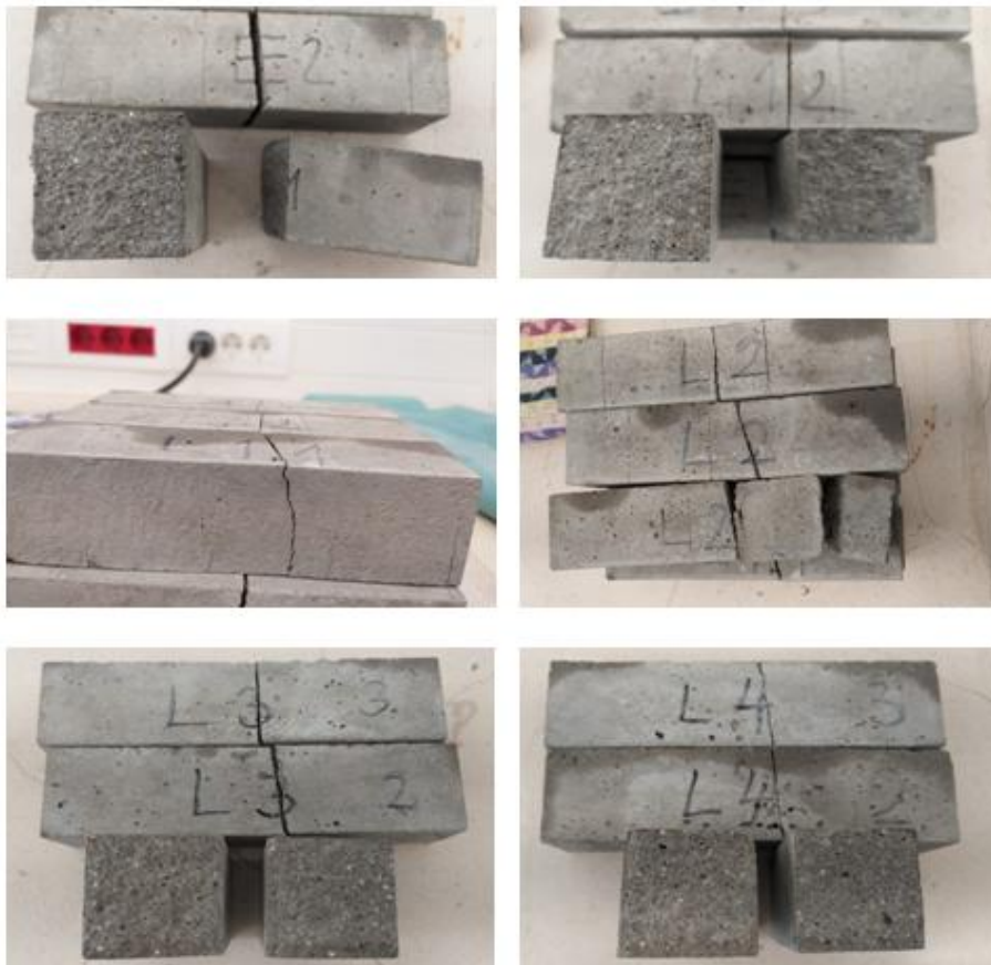
Slika 41. Uzorci nakon ispitivanja čvrstoće
