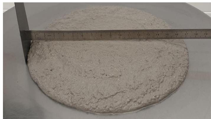
Slika 46. Obradljivost uzorka T1
