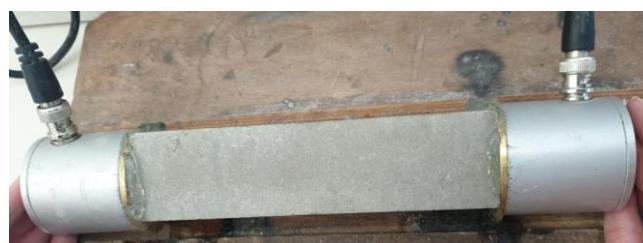
Slika 38. Ispitivanje ultrazvuka
