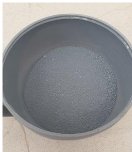
Slika 9. Upotrijebljena silikatna prašina u svrhu ispitivanja
