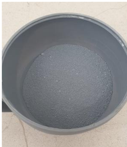
Slika 9. Upotrijebljena silikatna prašina u svrhu ispitivanja
