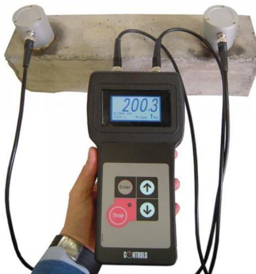
Slika 17. Uređaj za ispitivanje ultrazvuka (proizvođač Controls)
