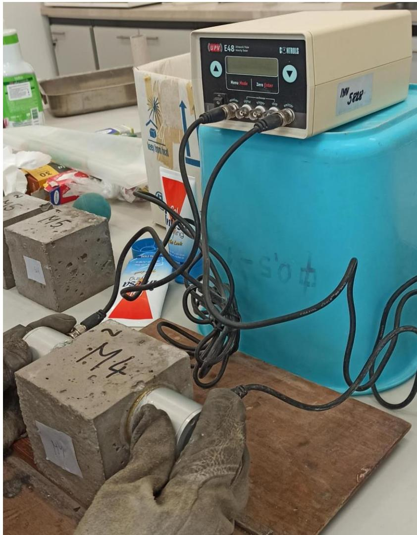
*Slika 48 Primjer ispitivanja ultrazvučne brzine impulsa*
