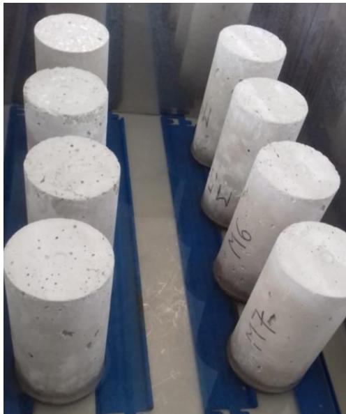
*Slika 47 Primjer ispitivanja vodoupojnosti*
