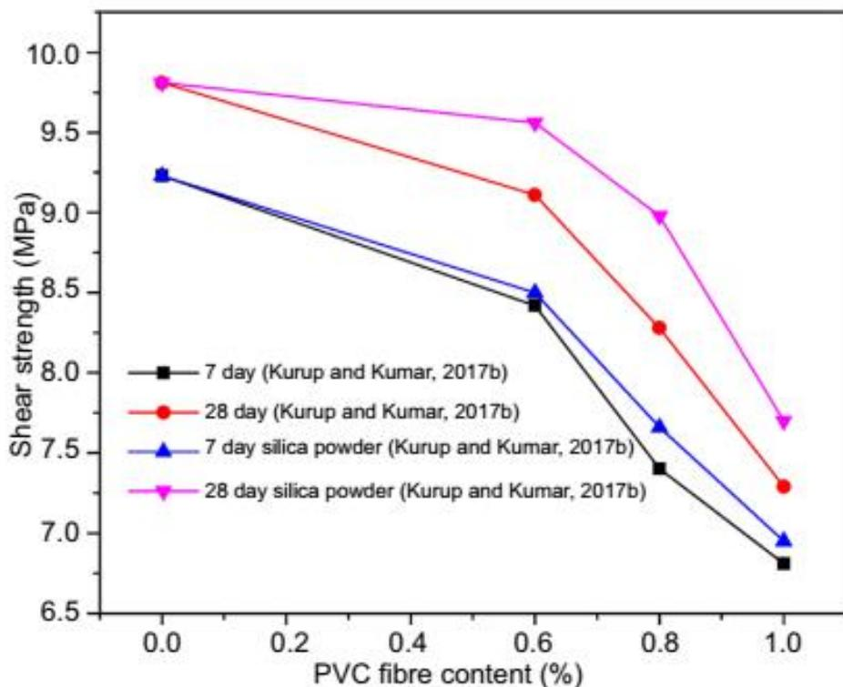
*Slika 29 Utjecaj PVC vlakana na posmičnu čvrstoću betona [2]*
