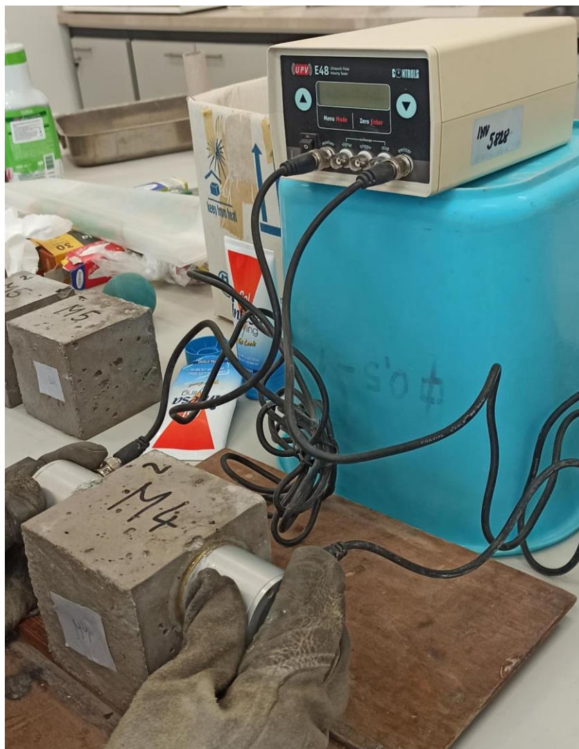
Slika 48 Primjer ispitivanja ultrazvučne brzine impulsa
