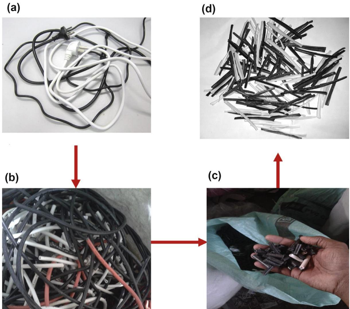
*Slika 19 Postupak proizvodnje PVC vlakana od e-otpada. (a) Odbačeni električni PVC kabeli. (b) PVC vlakna. (C) Vanjska ovojnica PVC kabela nakon oporabe metala. (d) Vanjska ovojnica PVC-a izrezana na male dužine. [2]*
