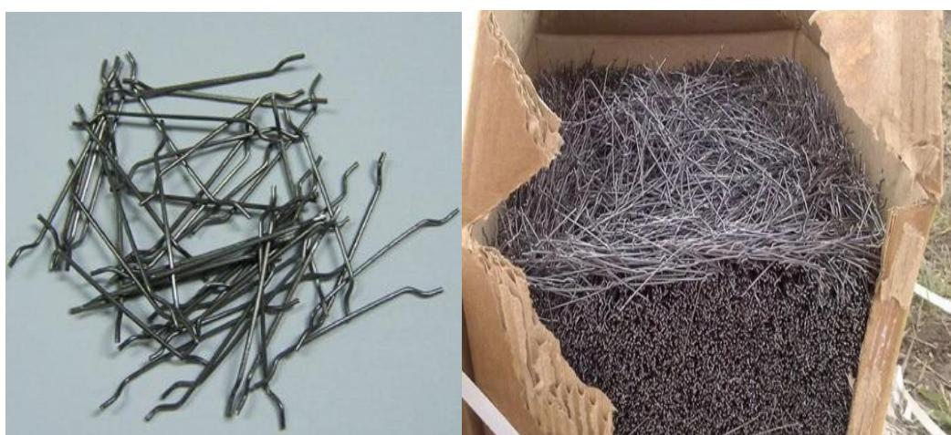
*Slika 9 Čelična vlakna [8,13]*
