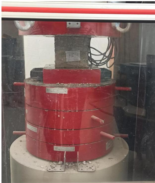
*Slika 45 Primjer ispitivanja tlačne čvrstoće*
