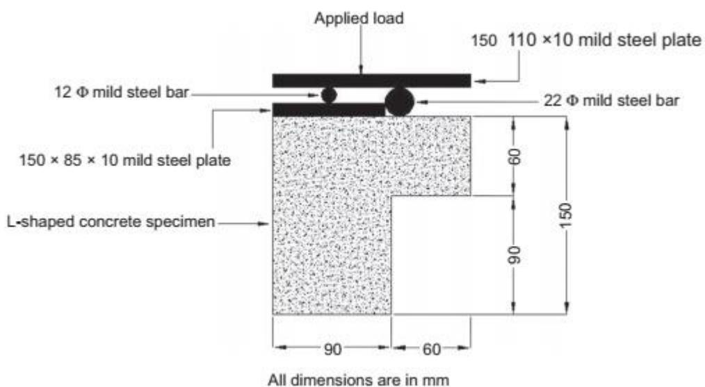
*Slika 28 Tipični plan postava za ispitivanje posmične čvrstoće [2]*
