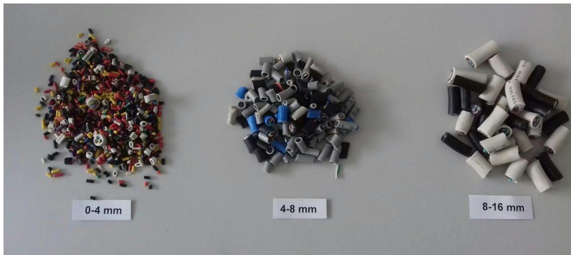
Slika 37 PVC kabeli korišteni za mješavine M1 – M6
