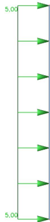
Slika 120. Korisno opterećenje na zid bazena
