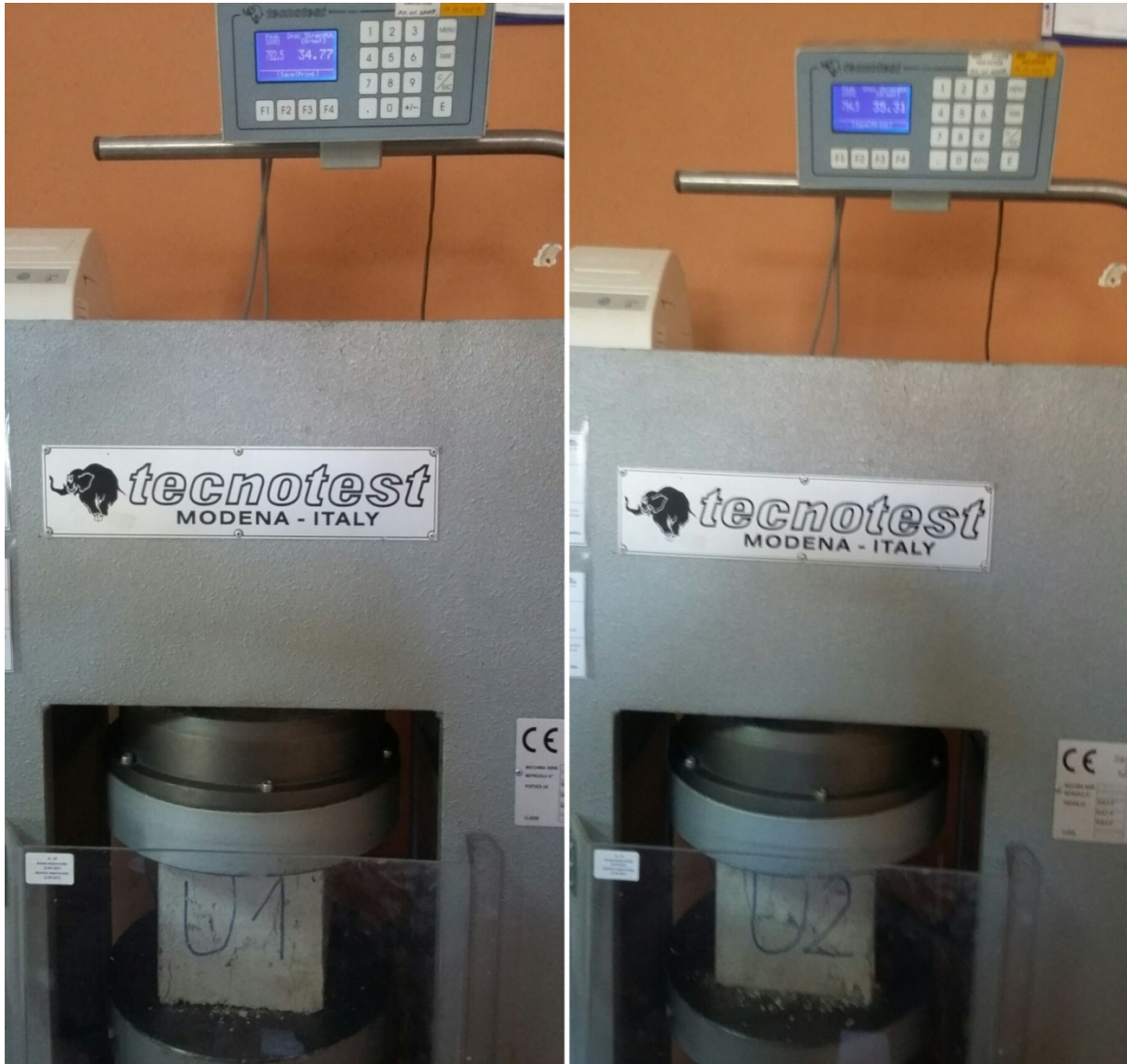
Fotografija 2.7: Uzorci U1 i U2 prilikom ispitivanja tlačne čvrstoće
