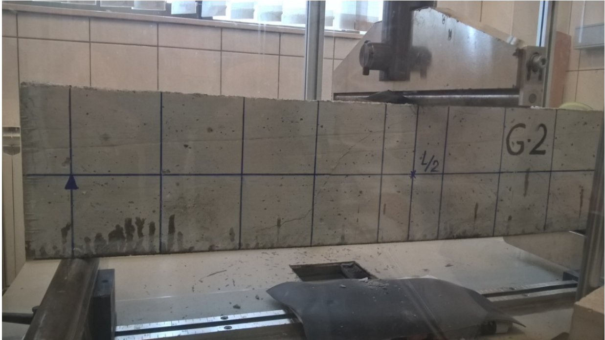
Fotografija 4.12: Pojava pukotina na gredi G2 (ojačana karbonskom trakom)
