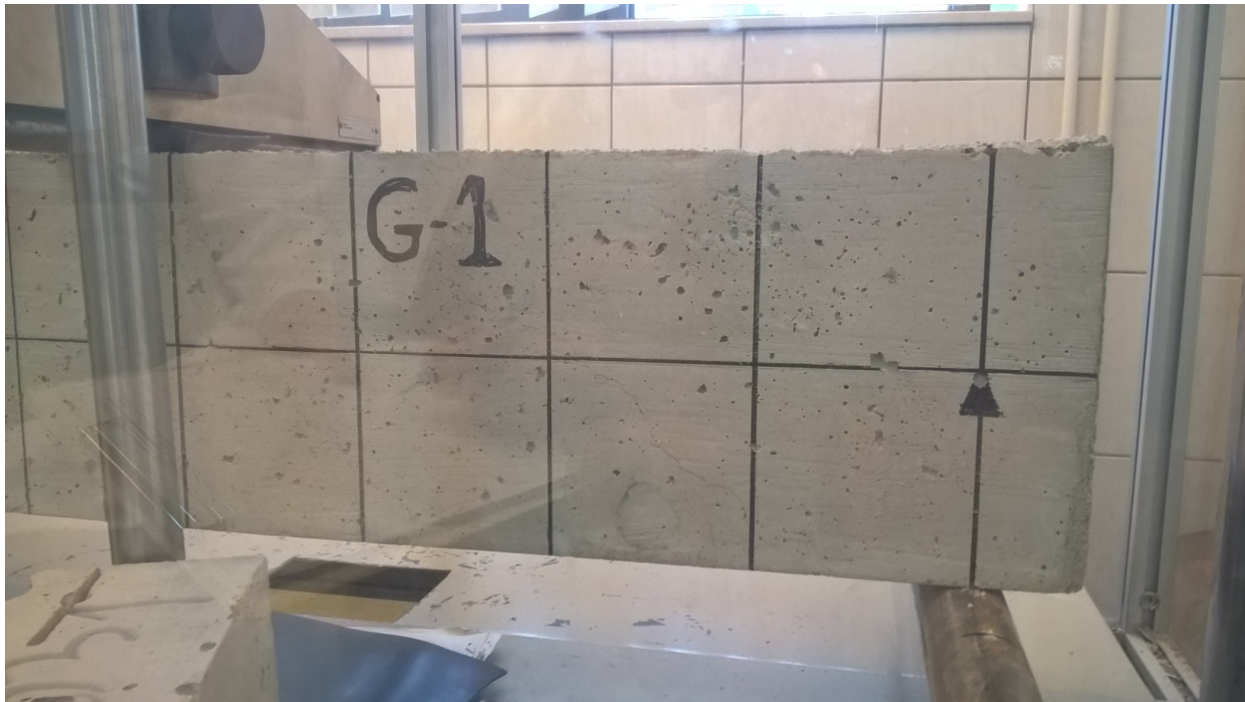
Fotografija 4.8: Pojava prvih pukotina na gredi G1
