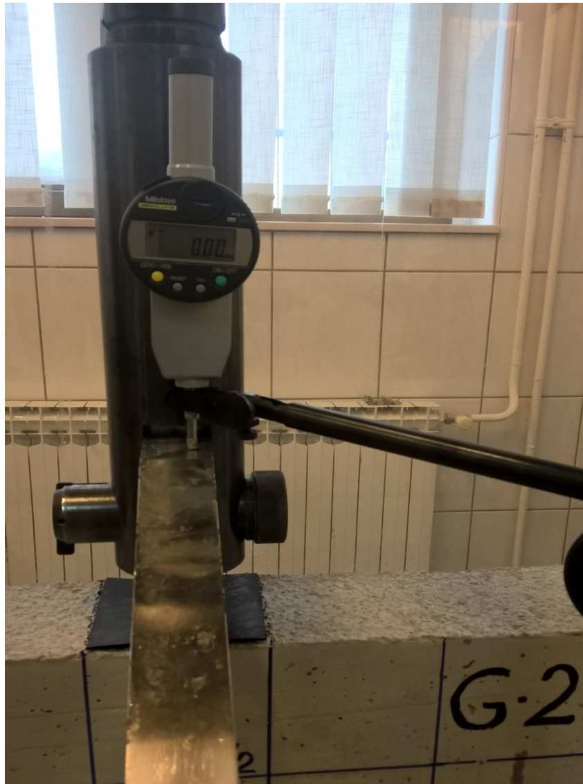
Fotografija 4.6: Slika postavljanja i nuliranja mikroure
