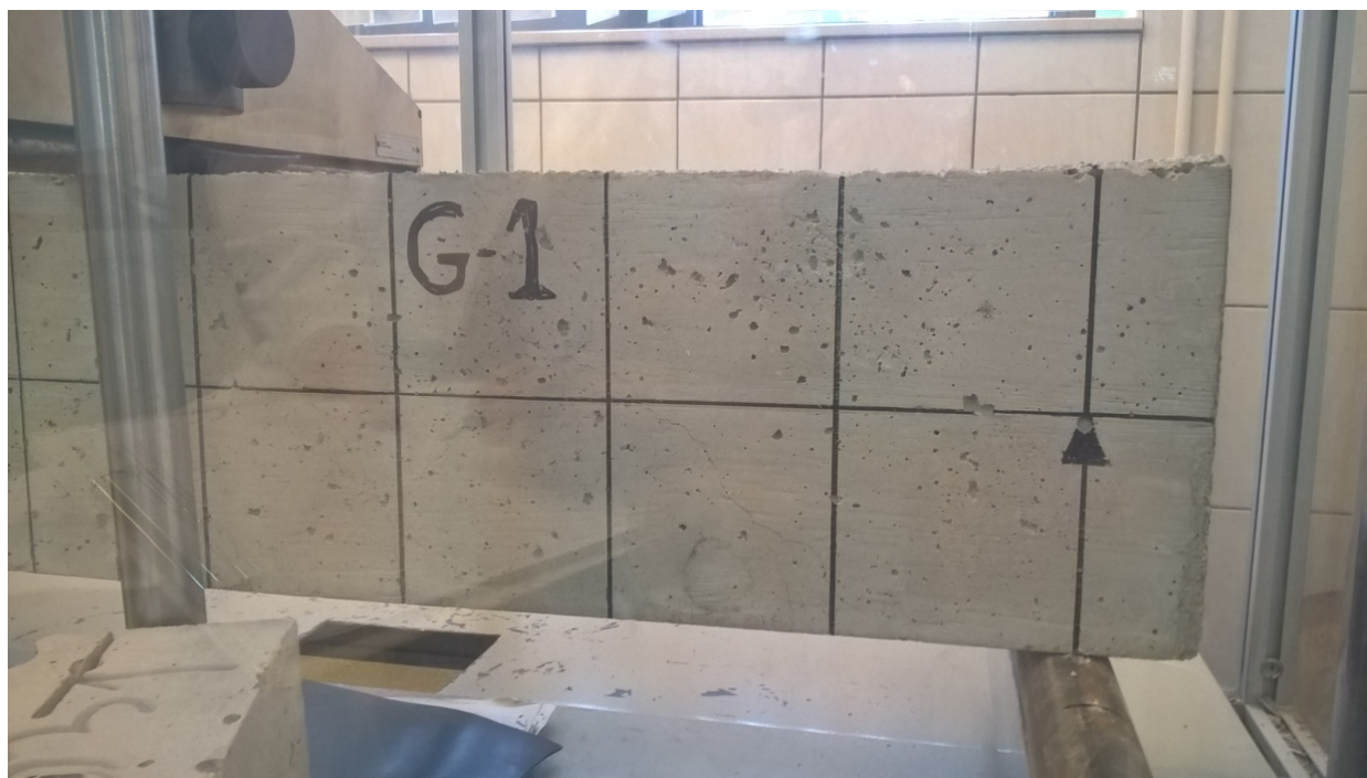
Fotografija 4.8: Pojava prvih pukotina na gredi G1
