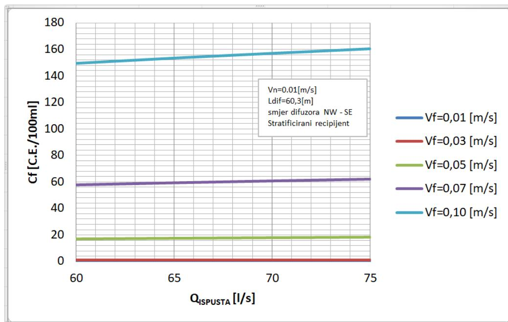
Slika 4.11. Utjecaj brzine morskih struja u dalekoj zoni podmorskog ispusta na koncentraciju E.C. na udaljenosti  $300 \text{ m}$  od obale
