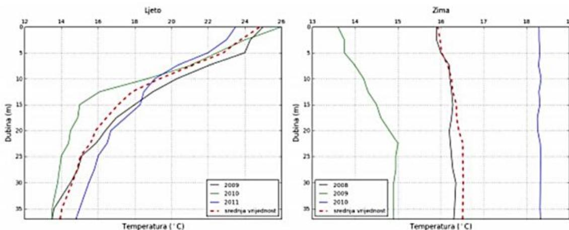
Slika 4.3. Vertikalna stratifikacija temperature – postaja P7
