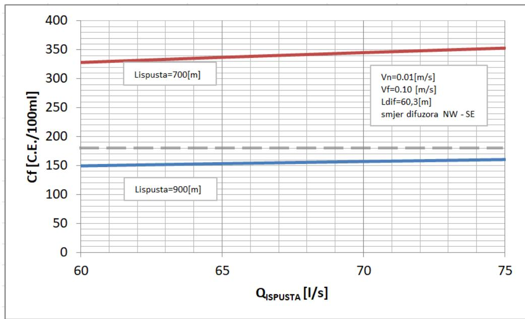
Slika 4.14. Izbor povećanja duljine cijevi podmorskog ispusta
