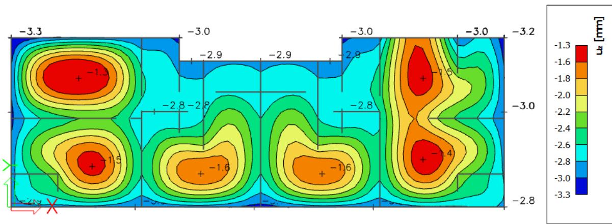
Slika 54. Slijeganje ploče (mm) za kombinaciju GSU3
