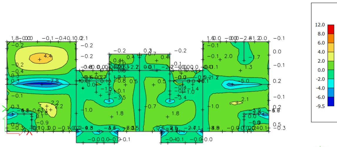
Slika 31. Armatura u ploči smjer  $As,y-y$  ( $\text{cm}^2/\text{m}$ ) za GSN1
