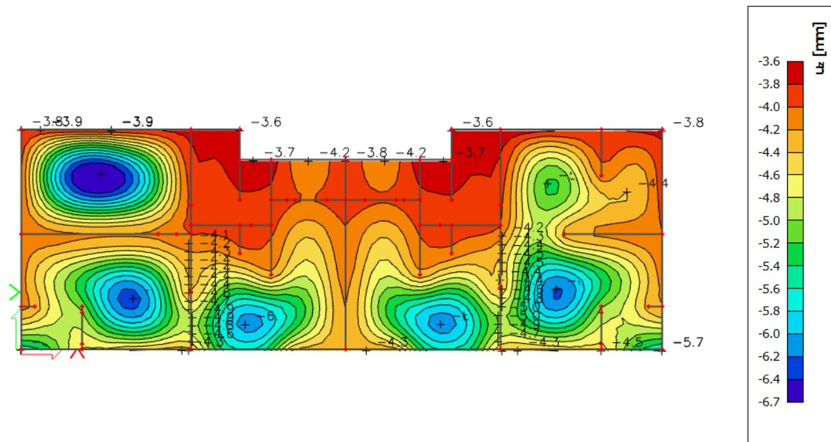
Slika 46. Progib krovne ploče (mm) za kombinaciju GSU3
