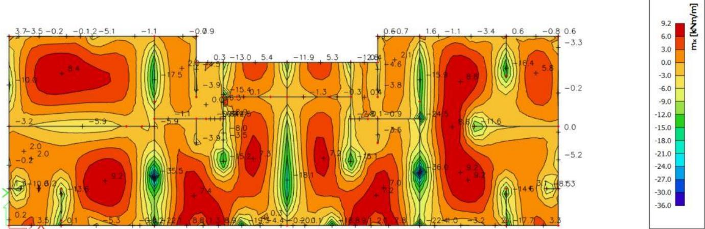
Slika 47. Moment savijanja  $M_{Ed,x}$  (kNm/m) za GSU2
