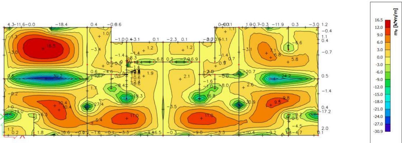
Slika 48. Moment savijanja  $M_{Ed,y}$  (kNm/m) za GSU2
