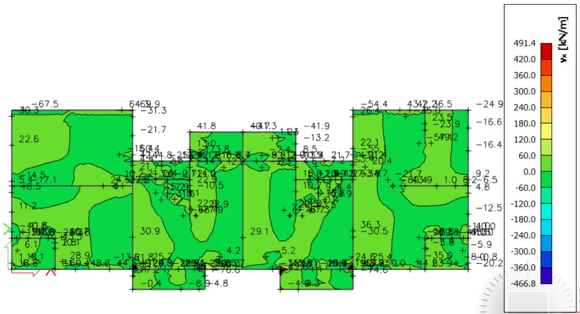
Slika 28. Poprečne sile  $VS_{d,x}$  [kNm/m] za GSN1
