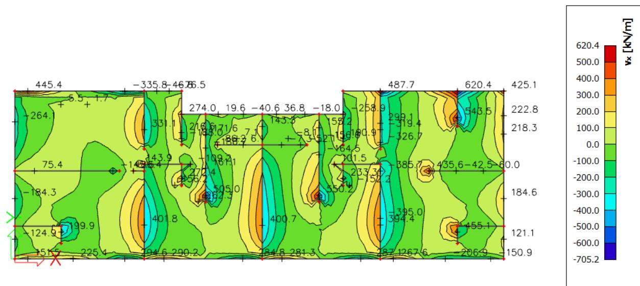
Slika 51. Poprečne sile  $V_{Ed,x}$  [ $\text{kNm/m}$ ] za GSN1
