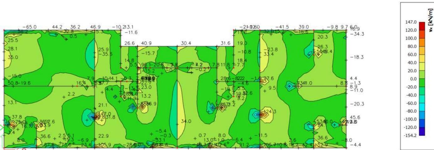
Slika 41. Poprečne sile  $V_{sd,x}$  [kNm/m] za GSN1
