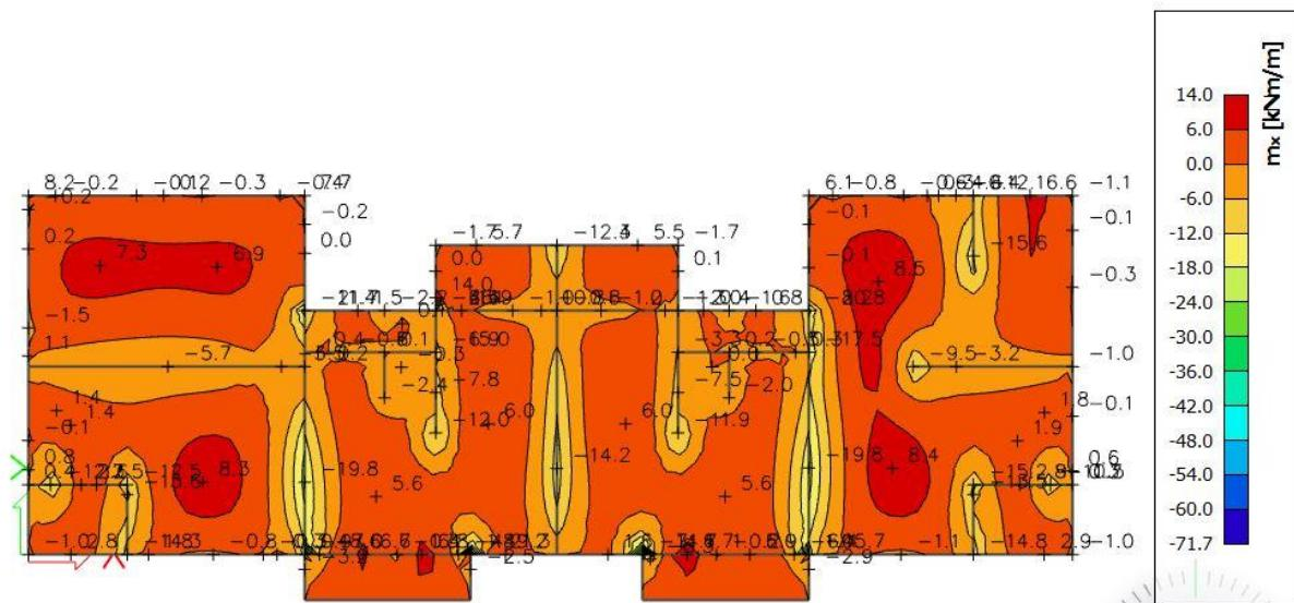
Slika 36. Moment savijanja  $M_{Ed,y}$  (kNm/m) za GSU3
