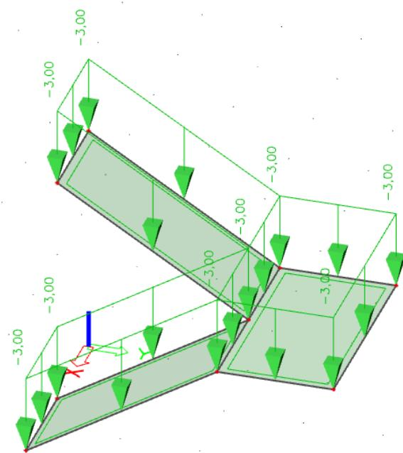
Slika 60. Prikaz pokretnog opterećenja  $Q$  na modelu stubišta
