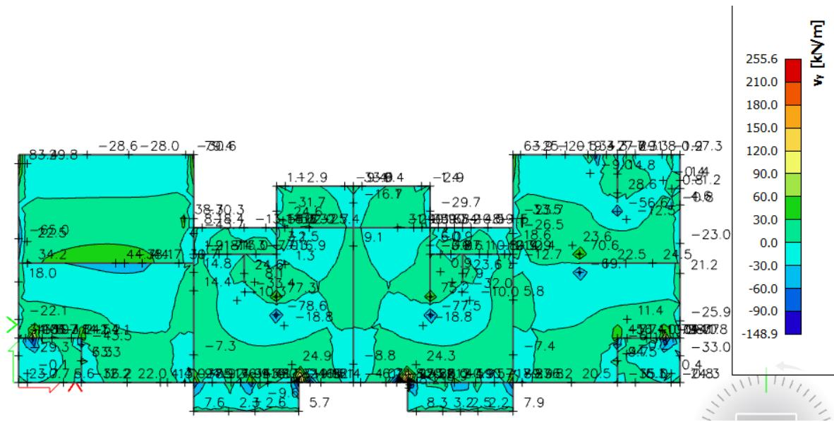
Slika 29. Poprečne sile  $VS_{d,y}$  [kNm/m] za GSN1
