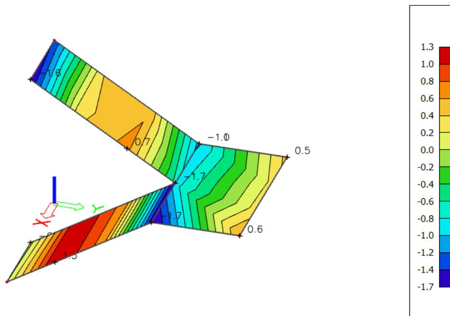
Slika 63. Armatura u stubištu smjer As,y-y (cm<sup>2</sup>/m) za GSN
