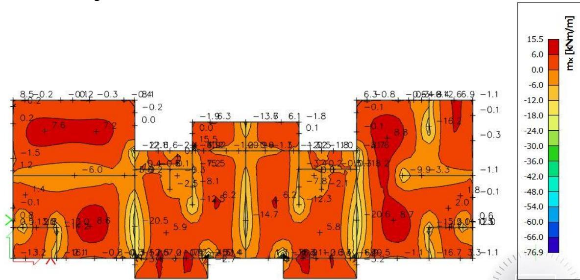
Slika 35. Moment savijanja  $M_{Ed,x}$  (kNm/m) za GSU2
