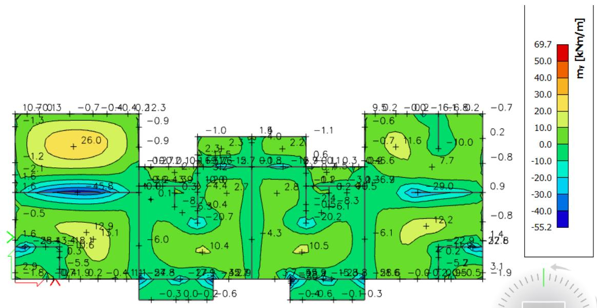
Slika 27. Momenti savijanja  $MS_{d,y}$  [kNm/m] za GSN1
