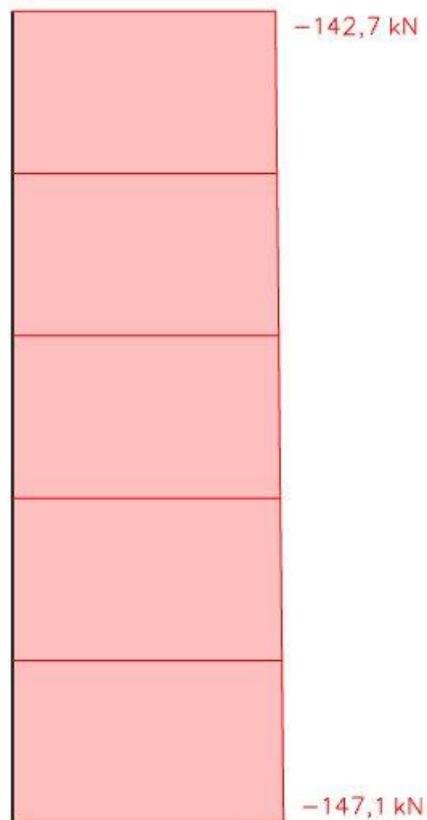
Slika 66. Uzdužne sile u stupu za kombinaciju GSU2
