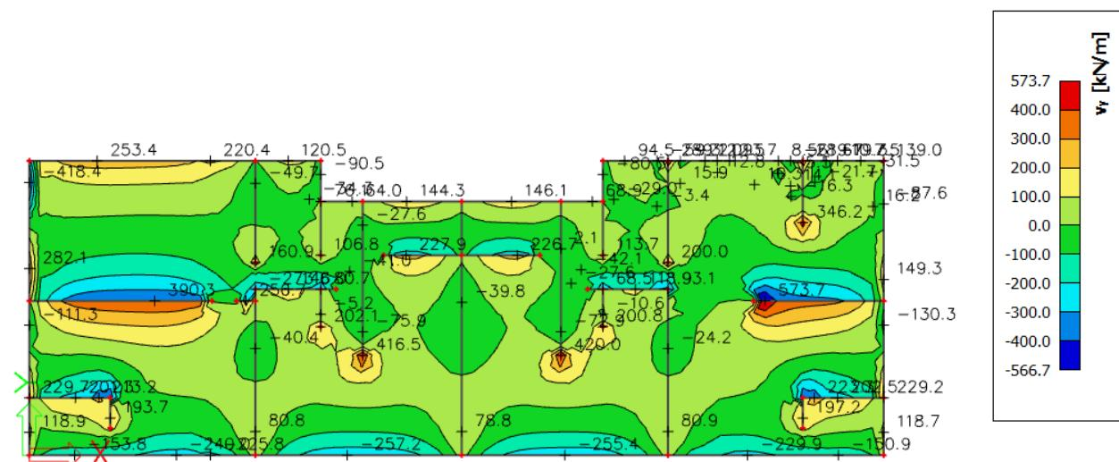
Slika 52. Poprečne sile  $V_{Ed,y}$  [ $\text{kNm/m}$ ] za GSN1
