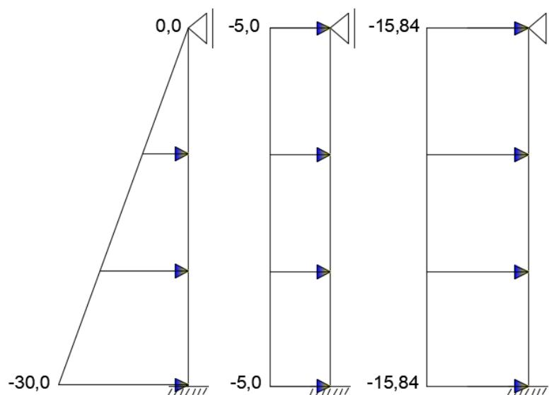
Slika 73. Prikaz modela podrumskog zida opterećenog stalnim, promjenjivim i potresnim opterećenjem
