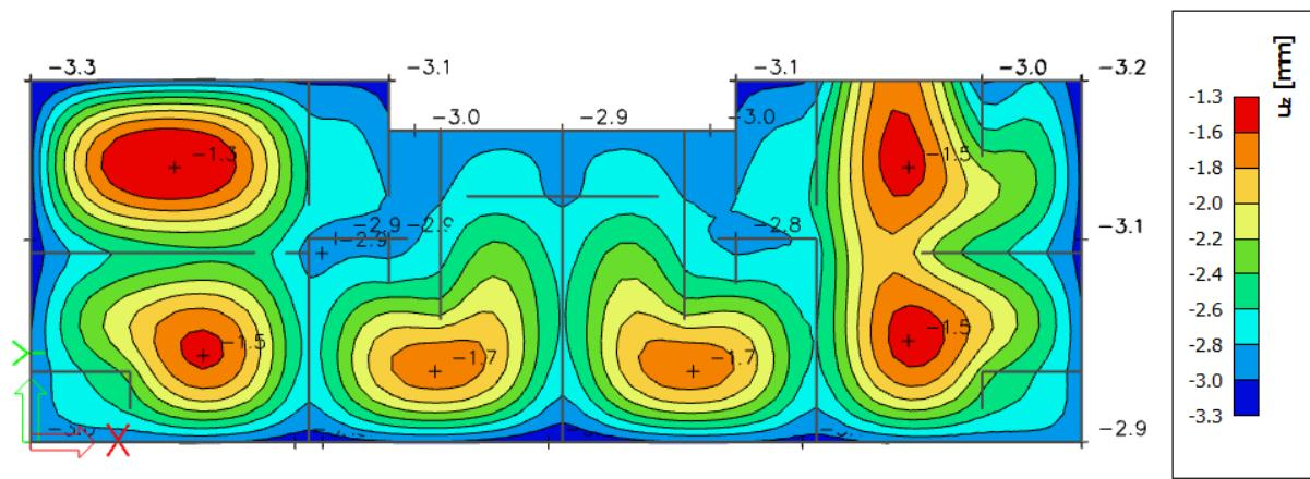
Slika 53. Slijeganje ploče (mm) za kombinaciju GSU2
