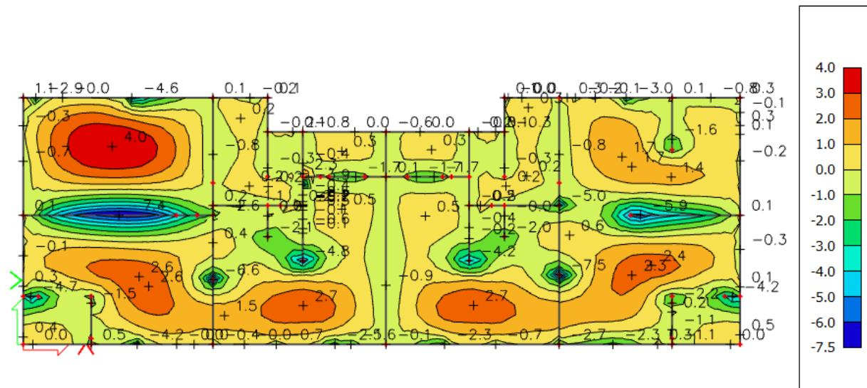
Slika 44. Armatura u ploči smjer As,y-y ( $\text{cm}^2/\text{m}$ ) za GSNI
