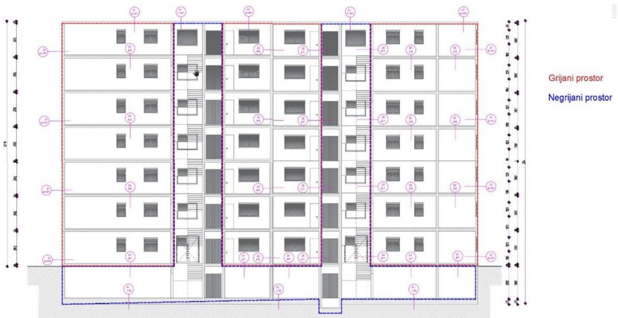
Slika 81. Presjek zgrade sa ucrtanom granicom grijanog/negrijanog prostora
