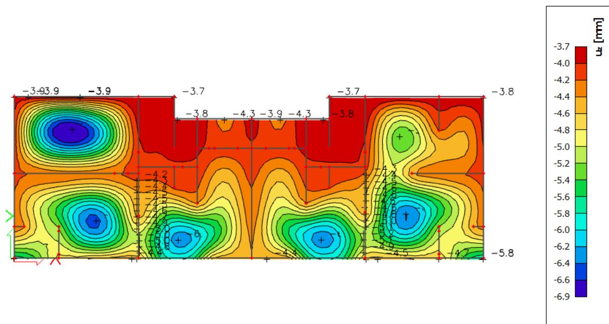
Slika 45. Progib krovne ploče (mm) za kombinaciju GSU2
