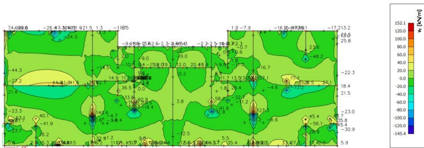
Slika 42. Poprečne sile  $V_{Sd,y}$  [kNm/m] za GSN1
