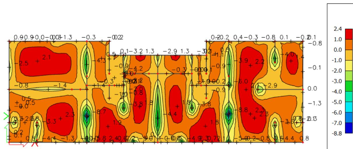
Slika 43. Armatura u ploči smjer  $As,x-x$  ( $\text{cm}^2/\text{m}$ ) za GSNI
