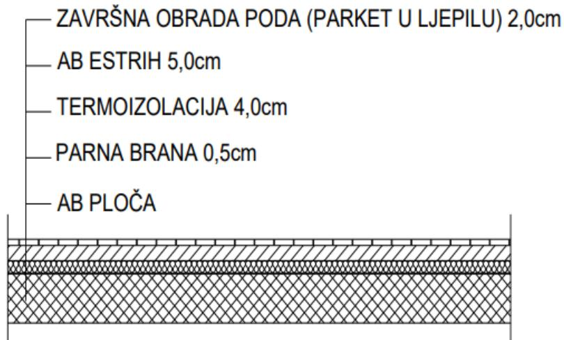
Slika 2.4. Presjek međukatne ploče – prikaz slojeva
