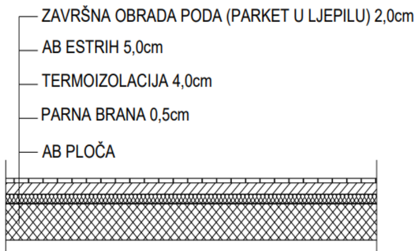
Slika 2.4. Presjek međukatne ploče – prikaz slojeva
