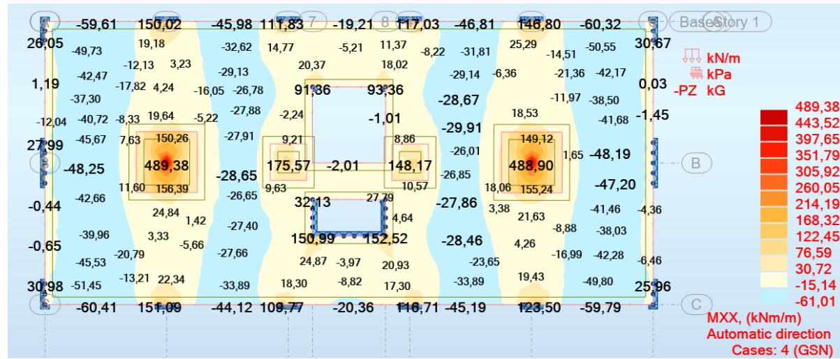
Slika 4.7 Momenti savijanja od mjerodavnju kombinaciju u smjeru X
