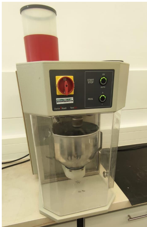
Slika 10, Laboratorijska miješalica [slika zabilježena tijekom ispitivanja]
