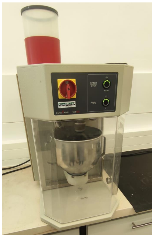
Slika 10, Laboratorijska miješalica [slika zabilježena tijekom ispitivanja]
