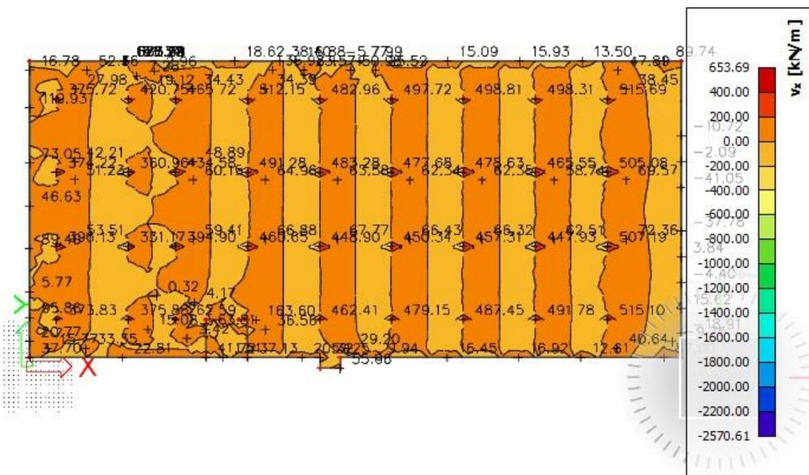
Slika 6.1.1.5 Poprečne sile  $V_{Ed,x}$  ( $kN/m$ ) za GSN-1
