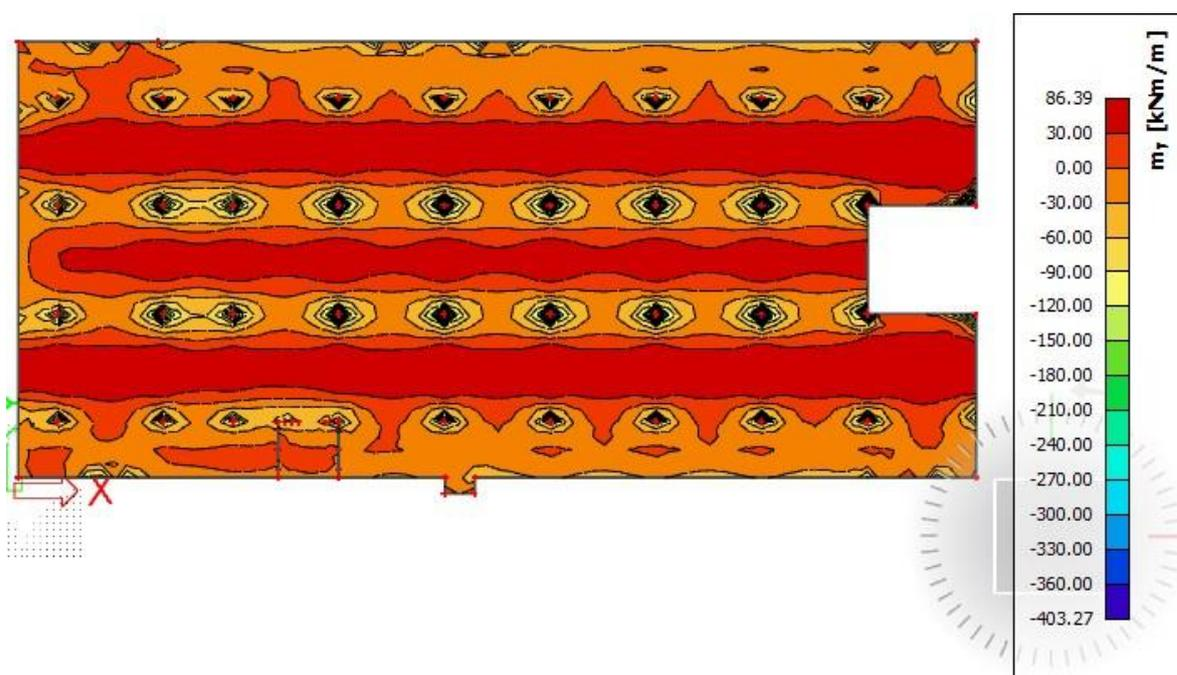
Slika 6.2.4.2 Moment savijanja  $M_{Ed,y}$  (kNm/m) za GSU-1
