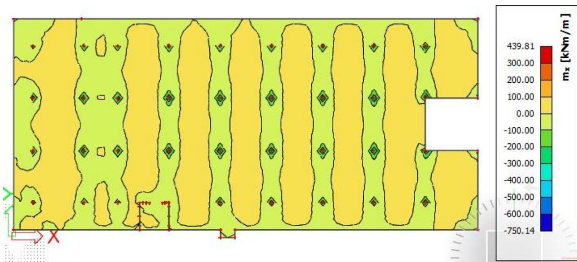
Slika 6.2.4.1 Moment savijanja  $M_{Ed,x}$  (kNm/m) za GSU-1
