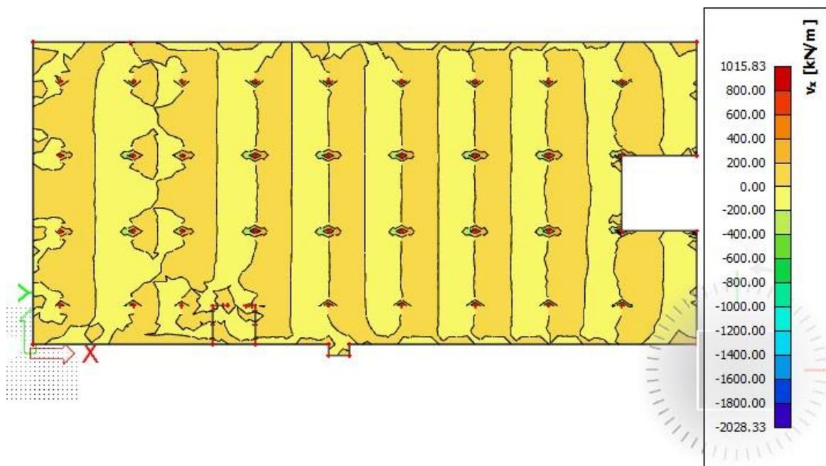
Slika 6.2.1.5 Poprečne sile  $V_{Ed,x}$  (kN/m) za GSN-1
