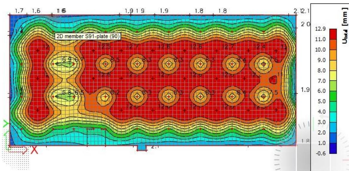
Slika 6.1.2.1 Progib ploče (mm) za kombinaciju GSU-1
