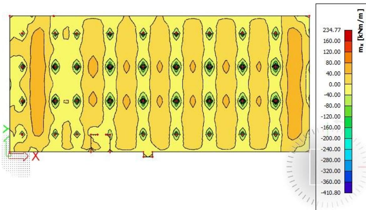
Slika 6.1.2.2 Moment savijanja  $M_{Ed,x}$  (kNm/m) za GSU-1
