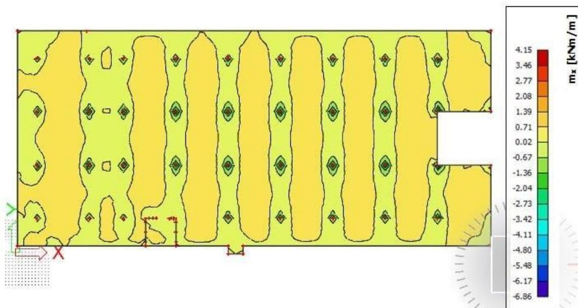
Slika 6.2.1.7 Potrebna površina armature  $A_s$  ( $\text{cm}^2/\text{m}$ ) u x smjeru
