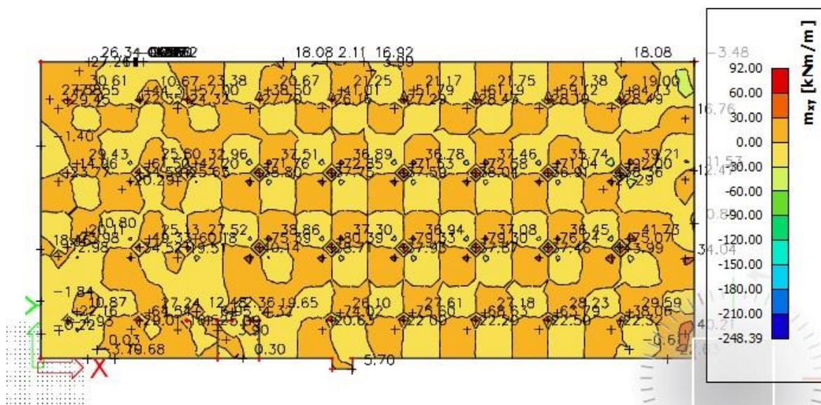
Slika 6.1.1.4 Moment savijanja  $M_{Ed,xy}$  ( $kNm/m$ ) za GSN-1
