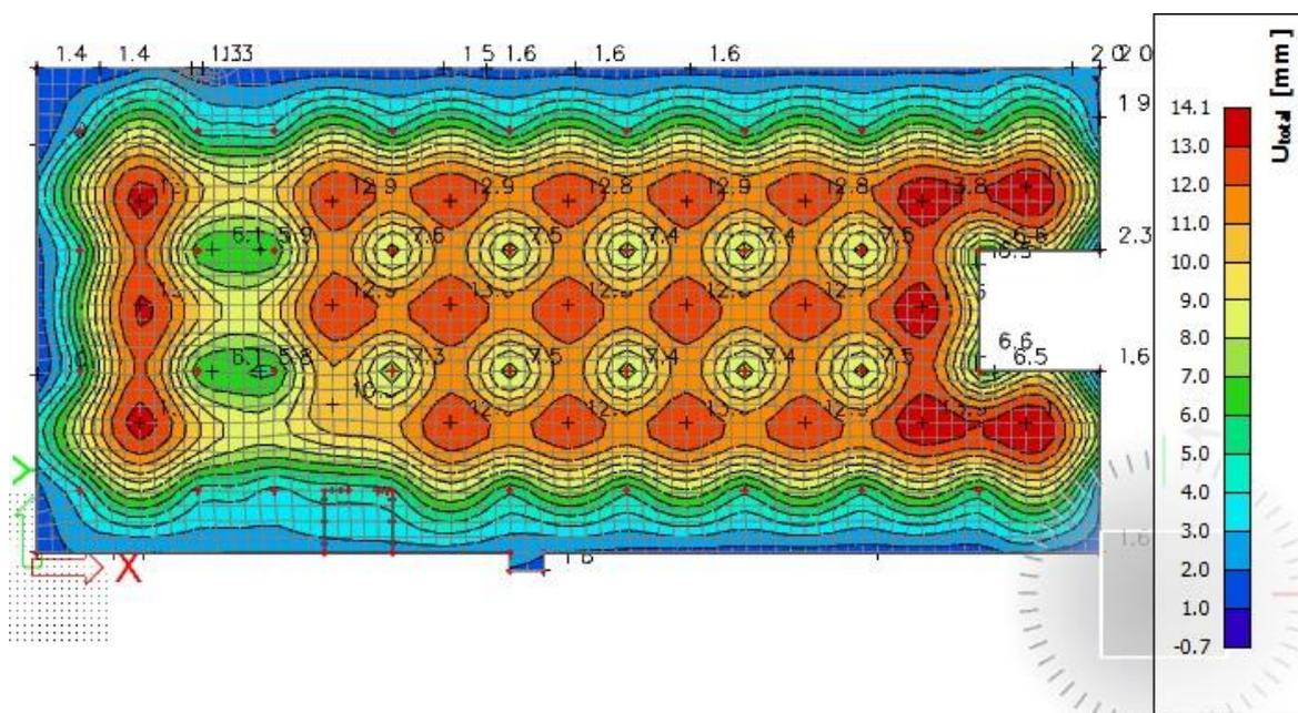
Slika 6.2.3.1 Progib ploče (mm) za kombinaciju GSU-1
