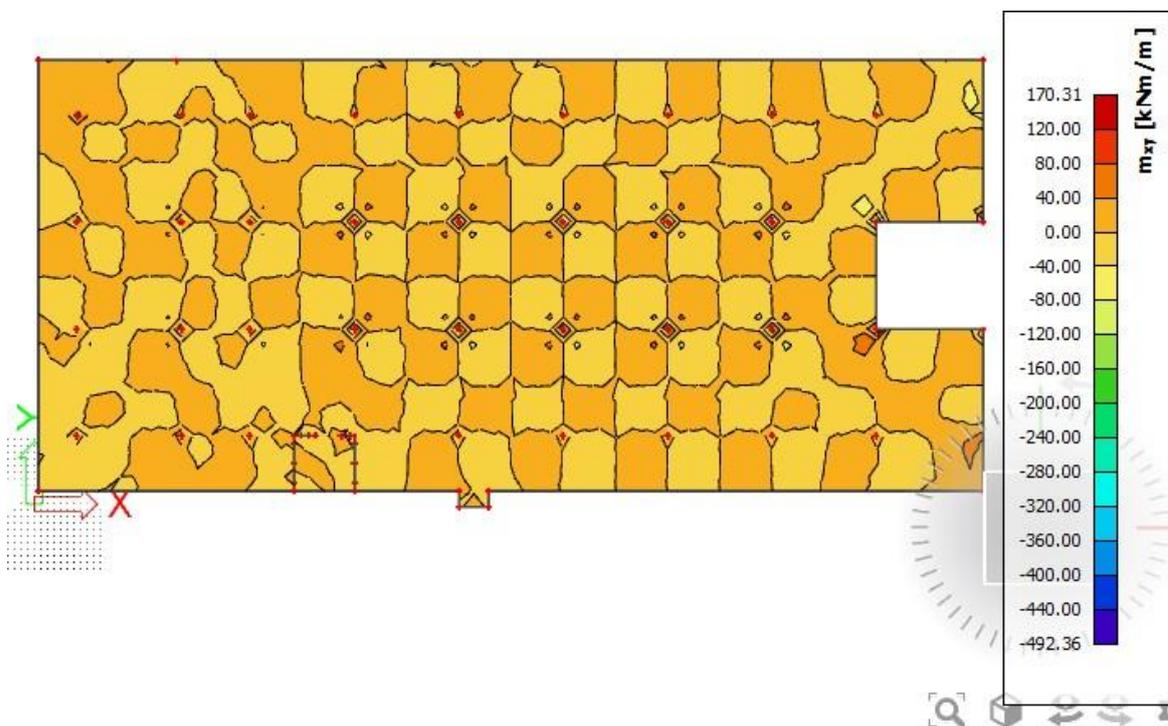
Slika 6.2.1.4 Moment savijanja  $M_{Ed,xy}$  (kNm/m) za GSN-1
