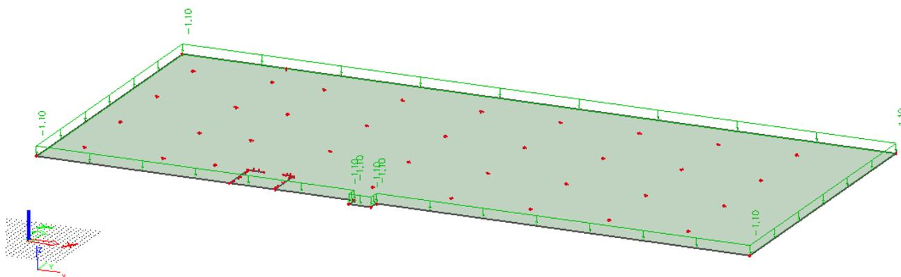
Slika 4.1.1 Dodatno stalno djelovanje  $G_1$  [ $\text{kN/m}^2$ ]
