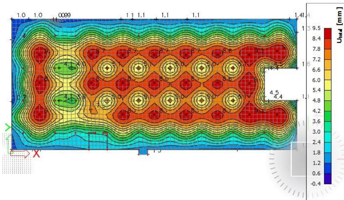
Slika 6.2.3.2 Progib ploče (mm) za kombinaciju GSU-2
