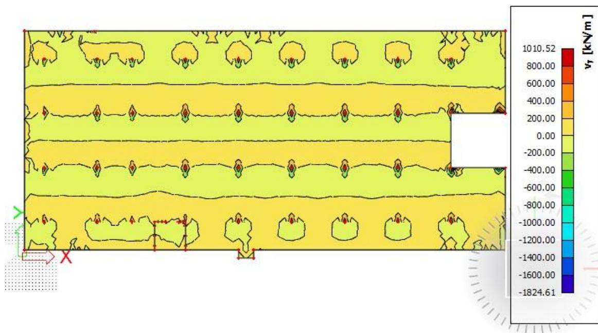
Slika 6.2.1.6 Poprečne sile  $V_{Ed,y}$  (kN/m) za GSN-1
