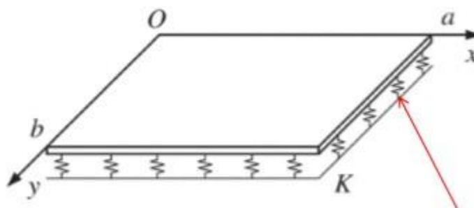
Slika 9.1 Međudjelovanje konstrukcija – tlo modelirano Winkler- ovim modelom
