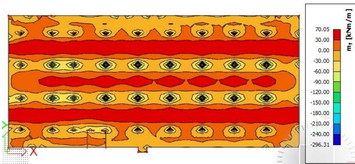
Slika 6.1.2.3 Moment savijanja  $M_{Ed,y}$  (kNm/m) za GSU-1
