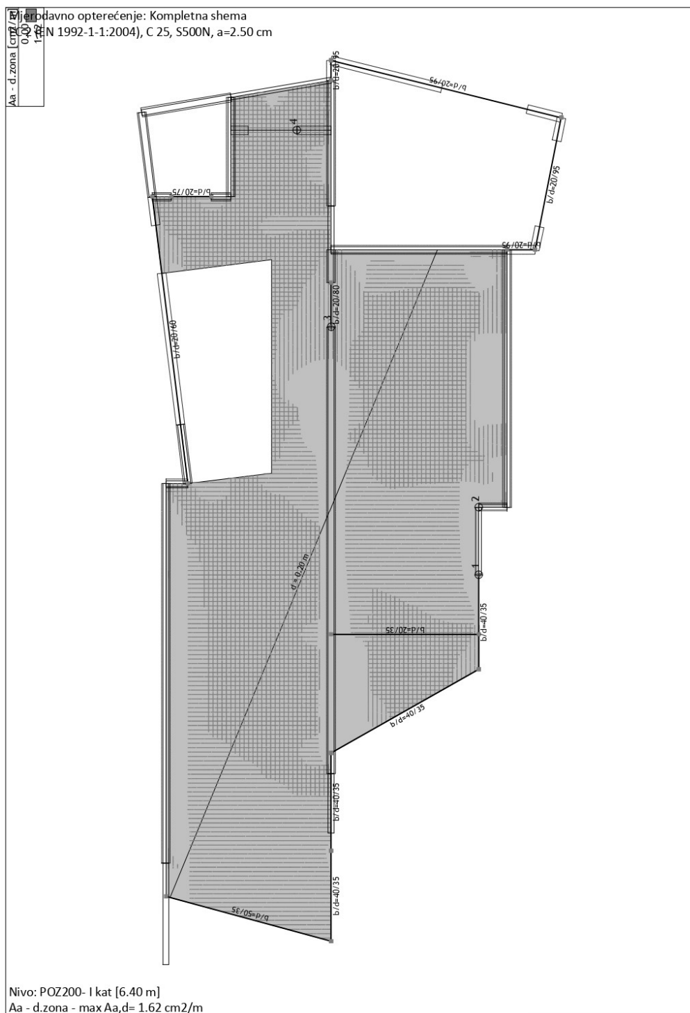
Slika 81. Potrebna armatura za donju zonu ploče POZ200
