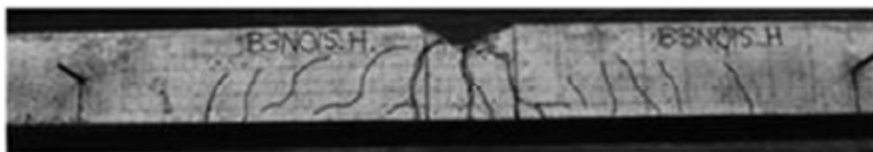
Crtež 6.47 Prikaz pukotina za različite progibe grede dobivene diskretnim modelom te prikaz pukotina dobivenih eksperimentalnim ispitivanjem (dinamički test): a) 1 mm b) 3 mm c) 6 mm d) 12 mm e) eksperiment [98]
