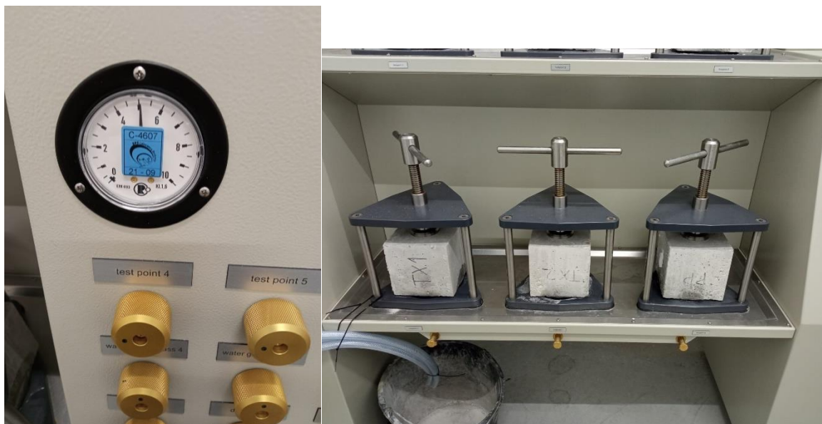
Slika 4.16: Uzorci postavljeni u VDP uređaj pod stalnim tlakom
