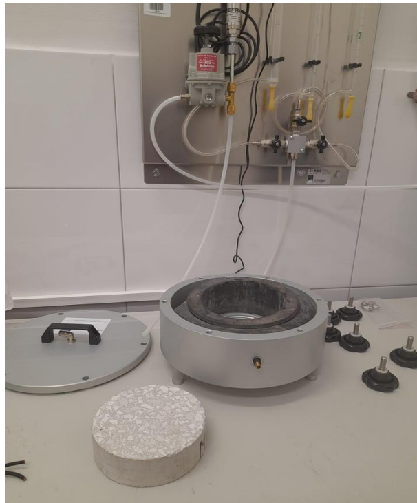
Slika 3.9. Uređaj i ispitni uzorak za ispitivanje plinopropusnosti
