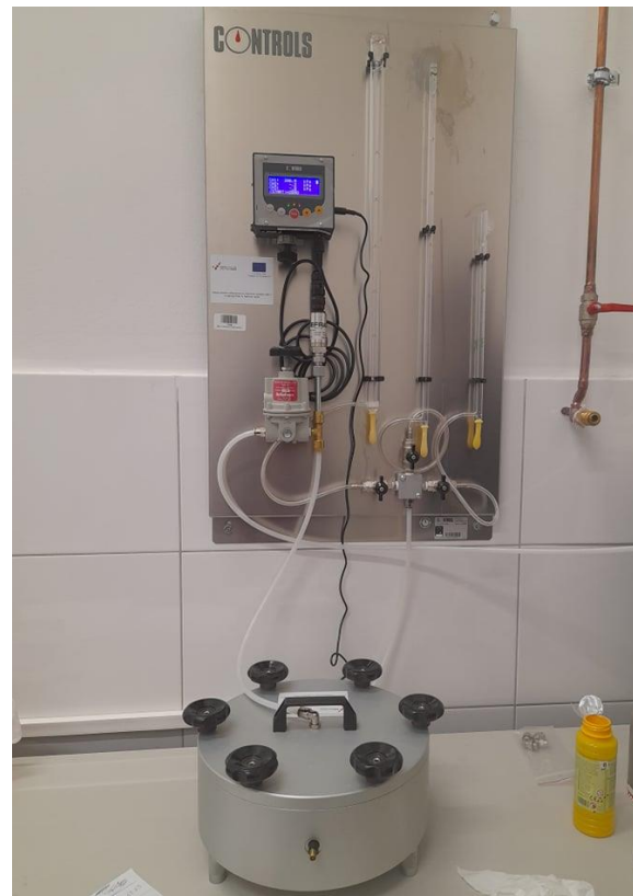
Slika 3.7. Uređaj za ispitivanje plinopropusnosti
