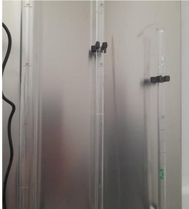
Slika 3.8. Mjehurić u kalibriranoj cijevi
