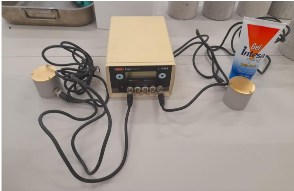
Slika 3.5. Uređaj za ispitivanje brzine ultrazvučnih valova
