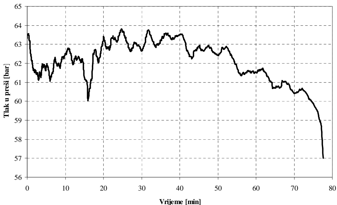
Grafikon 6.8. Prikaz izmjerene veličine tlaka u cilindrima
