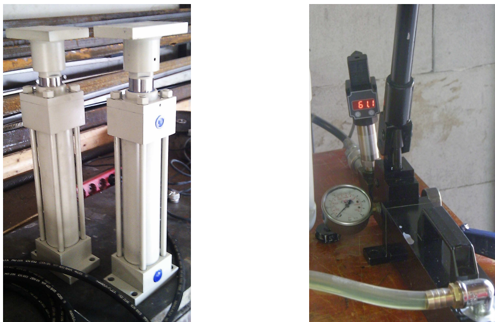
Fotografija 6.3. Prikaz hidrauličnih cilindara (H1) i digitalnog mjerača tlaka
