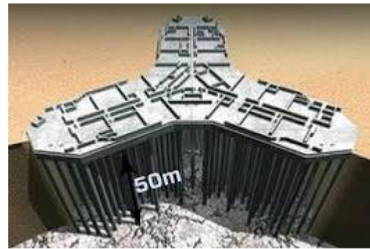
Slika 2.2.2.5 Temelji Burj Khalifa
