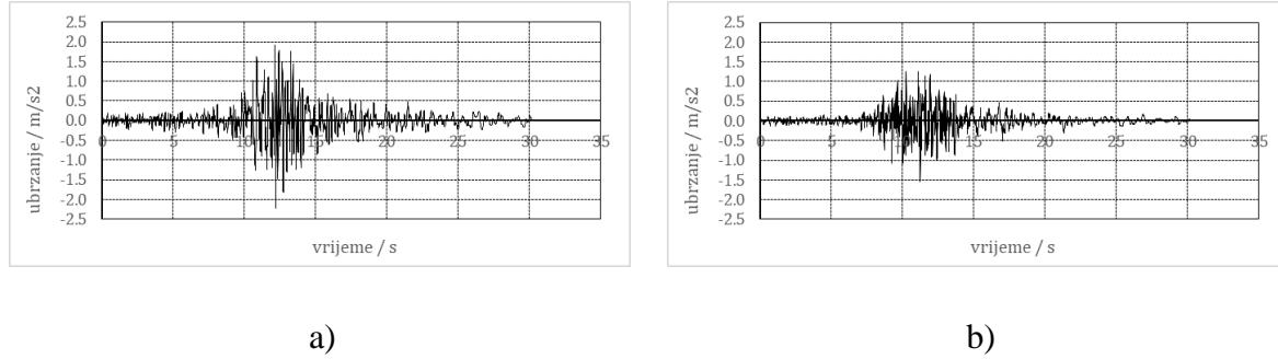
*Slika 5 Akcelerogram potresa Campano Lucano: a) horizontalna komponenta; b)vertikalna komponenta*
