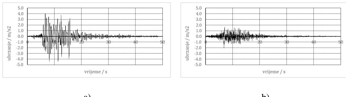
*Slika 6 Akcelerogram potresa Petrovac: a) horizontalna komponenta; b)vertikalna komponenta*
