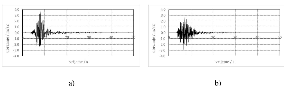
*Slika 7 Akcelerogram potresa South Island: a) horizontalna komponenta; b)vertikalna komponenta*
