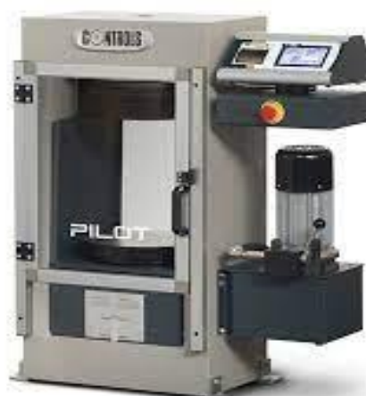
Slika 4.1. Uređaj za ispitivanje karakteristične tlačne čvrstoće
