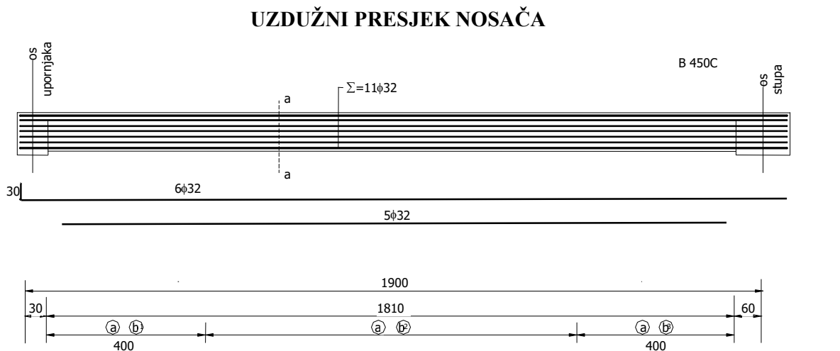
Slika 32. Prikaz armiranja uzduznog nosača u polju
