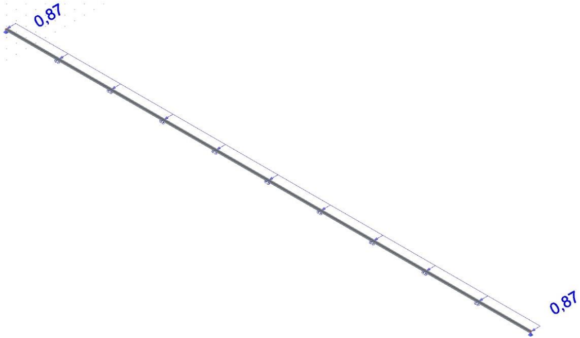
Slika 2.29 Prikaz promjenjivog opterećenja od vjetra ( W_2 )
