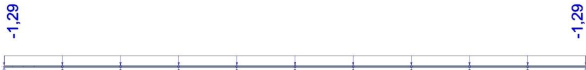
Slika 2.24 Prikaz promjenjivog opterećenja od vjetra ( W_1 )
