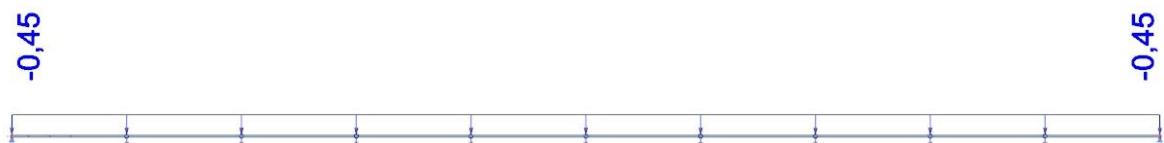
Slika 2.27 Prikaz stalnog opterećenja od sendvič panela ( G_{sp} )
