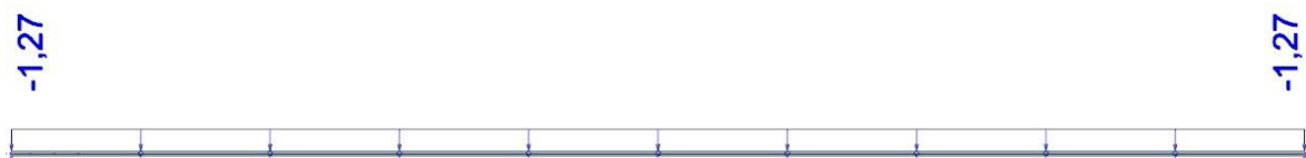
Slika 2.22 Prikaz stalnog opterećenja od krovne plohe ( G_{kp} )
