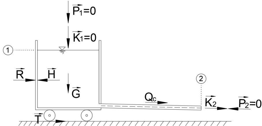
Slika 3. Shematski prikaz vodospremnika i pripadajućih sila
