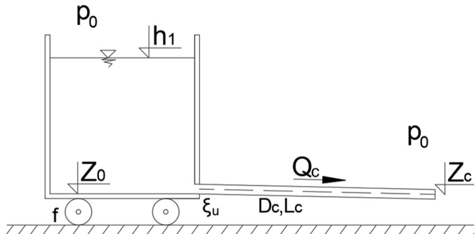
*Slika 1. Vodospremnik s ispustom*
