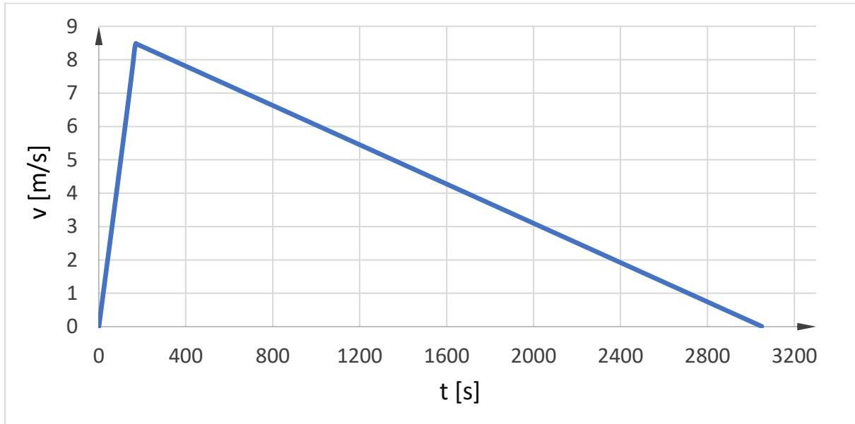
Slika 15. Grafički prikaz brzine vodospremnika za  $D_{c3} = 0,20$  (m)
