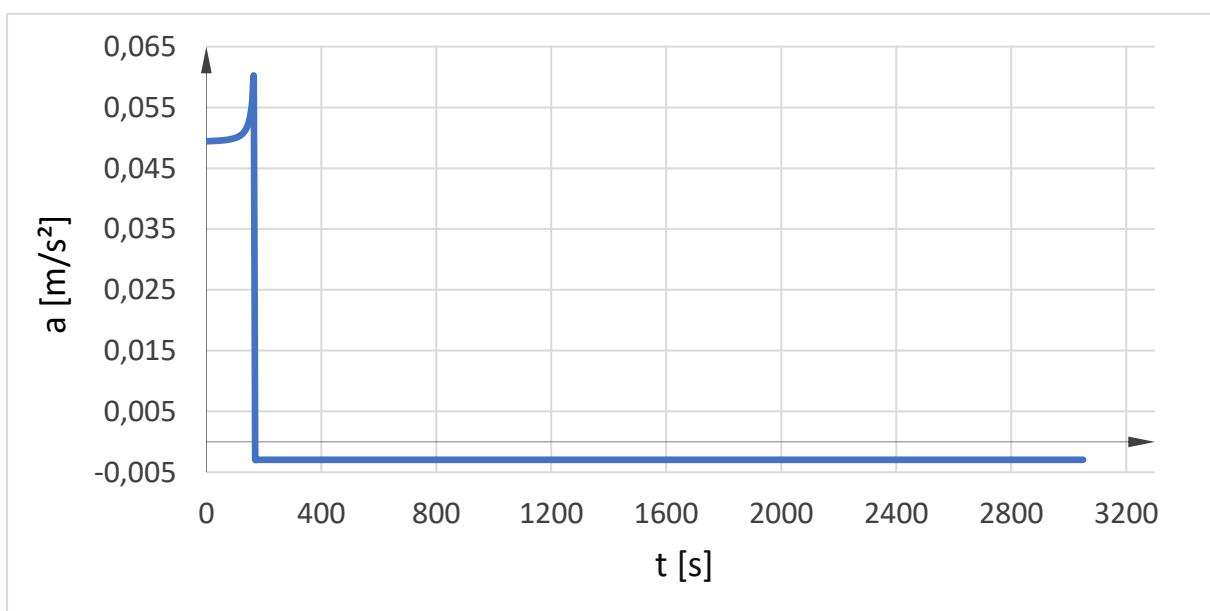
Slika 14. Grafički prikaz ubrzanja vodospremnika za  $D_{c3} = 0,20$  (m)
