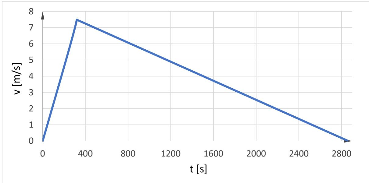
Slika 11. Grafički prikaz brzine vodospremnika za  $D_{c2} = 0,15$  (m)
