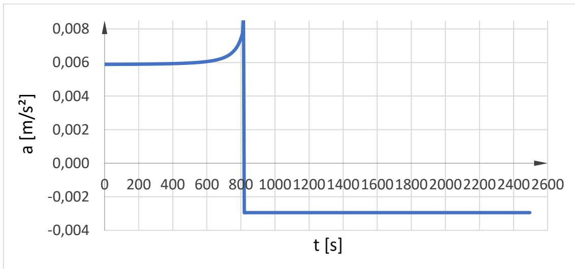
*Slika 6. Grafički prikaz ubrzanja vodospremnika za  $D_{c1} = 0,10$  (m)*
