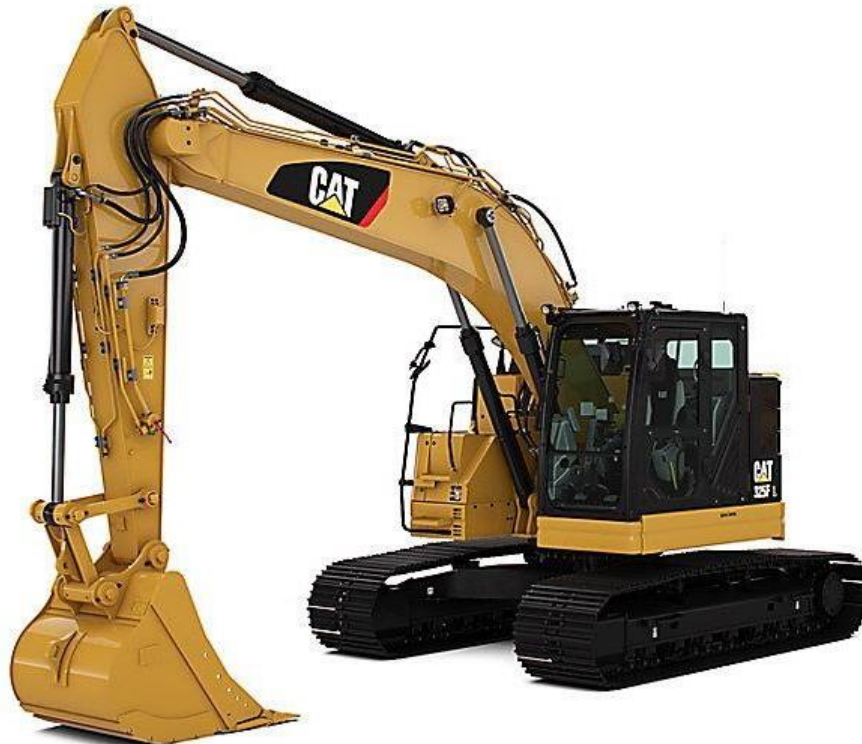
Slika 4.7 Jaružalo s dubinskom lopatom CAT 313GC [7]
