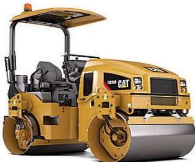
Slika 4.5 Valjak CAT CB36B [8]
