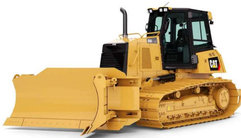
Slika 4.1 Dozer CAT D6K [4]
