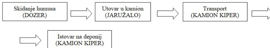
Slika 2.3 Slijed korištenja strojeva za prvu fazu radova
