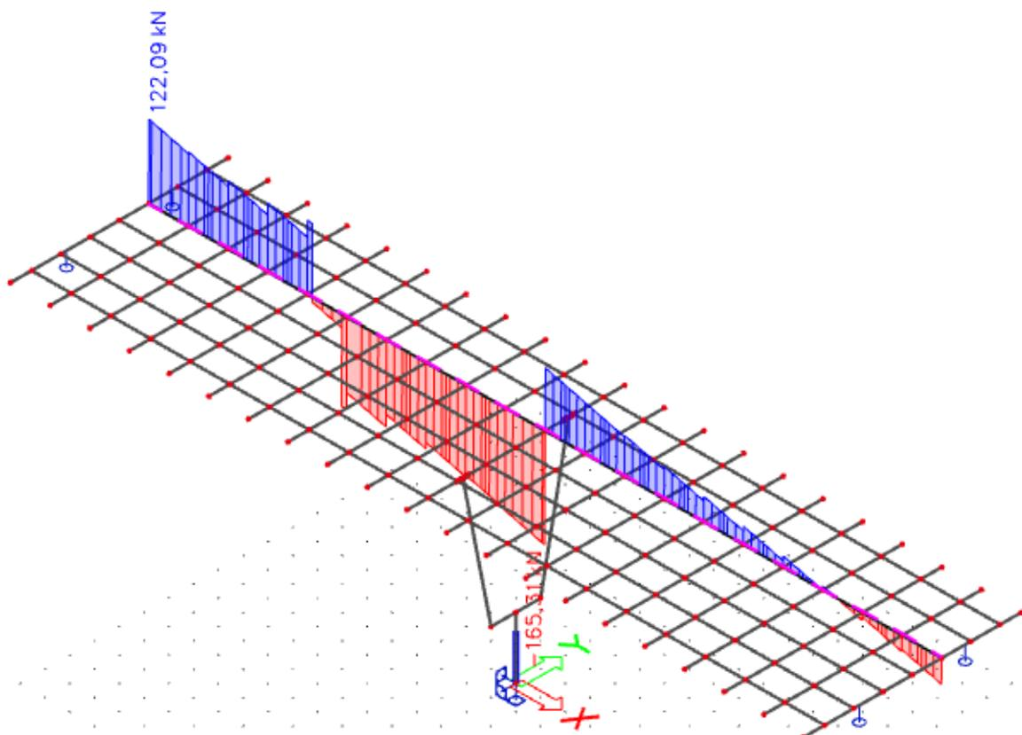
Slika 21. Pokretno - maksimalni moment pri stupu— poprečne sile ( $V_z$ ) u kN
