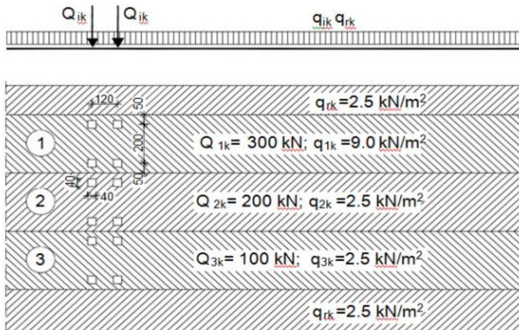
Slika 13. Prikaz načina opterećenja mosta pokretnim opterećenjem
