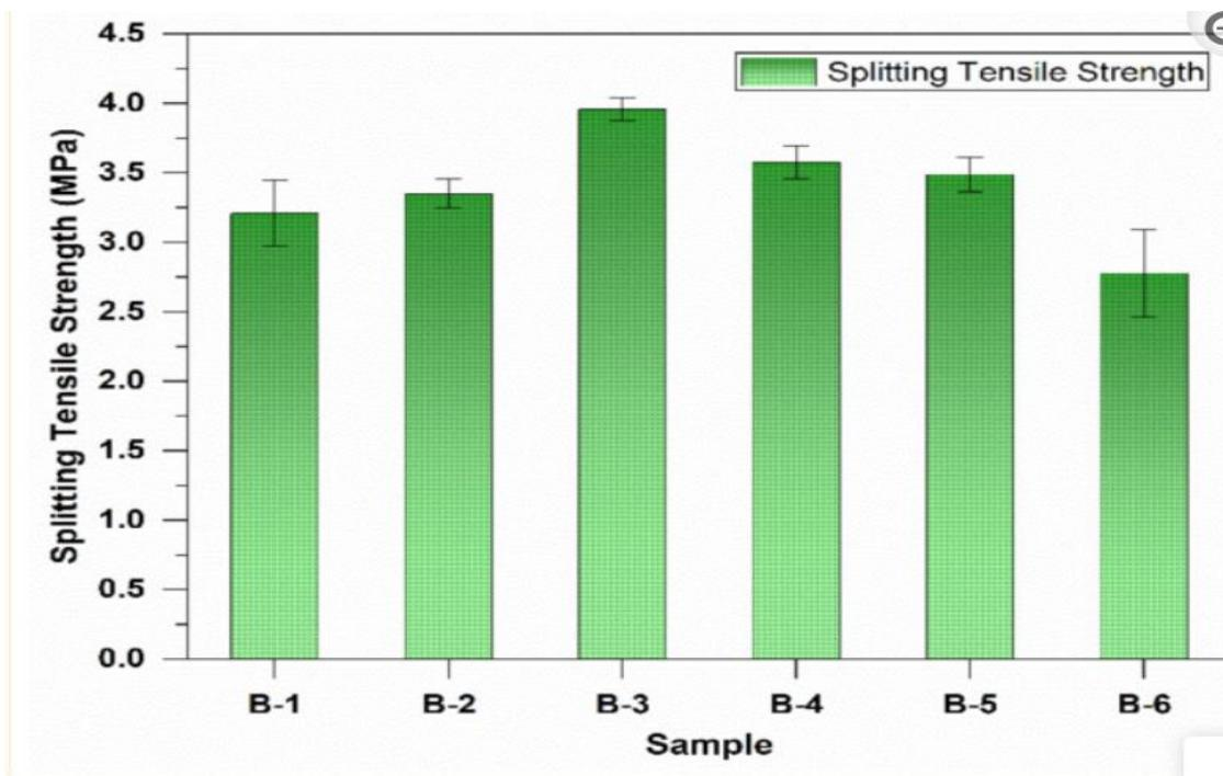
Slika 3.1.3 Vlačna čvrstoća [7]
