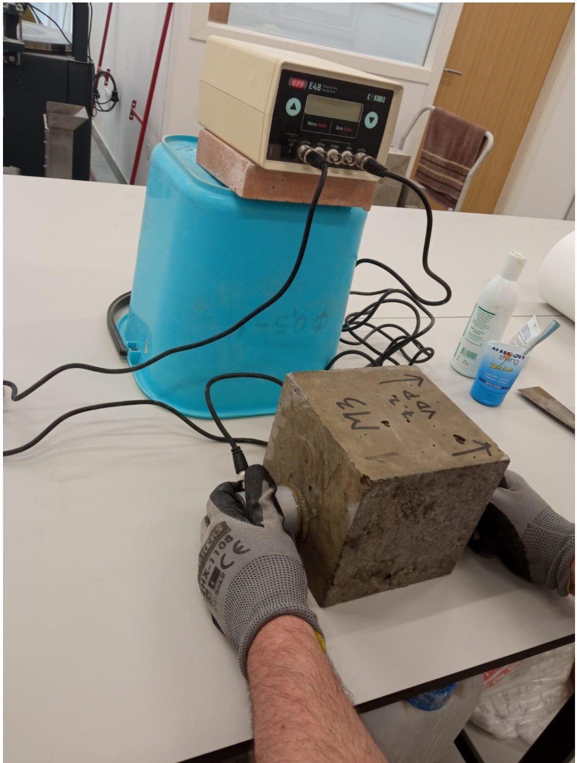
Slika 4.4.7 Ispitivanje brzine širenja ultrazvučnih valova u betonu
