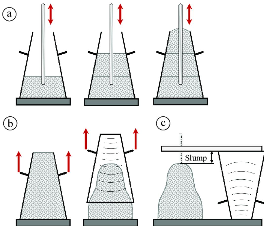
Slika 4.4.4 Prikaz metode slijeganja i tijek postupaka tokom ispitivanja pomoću Abramsova kalupa
