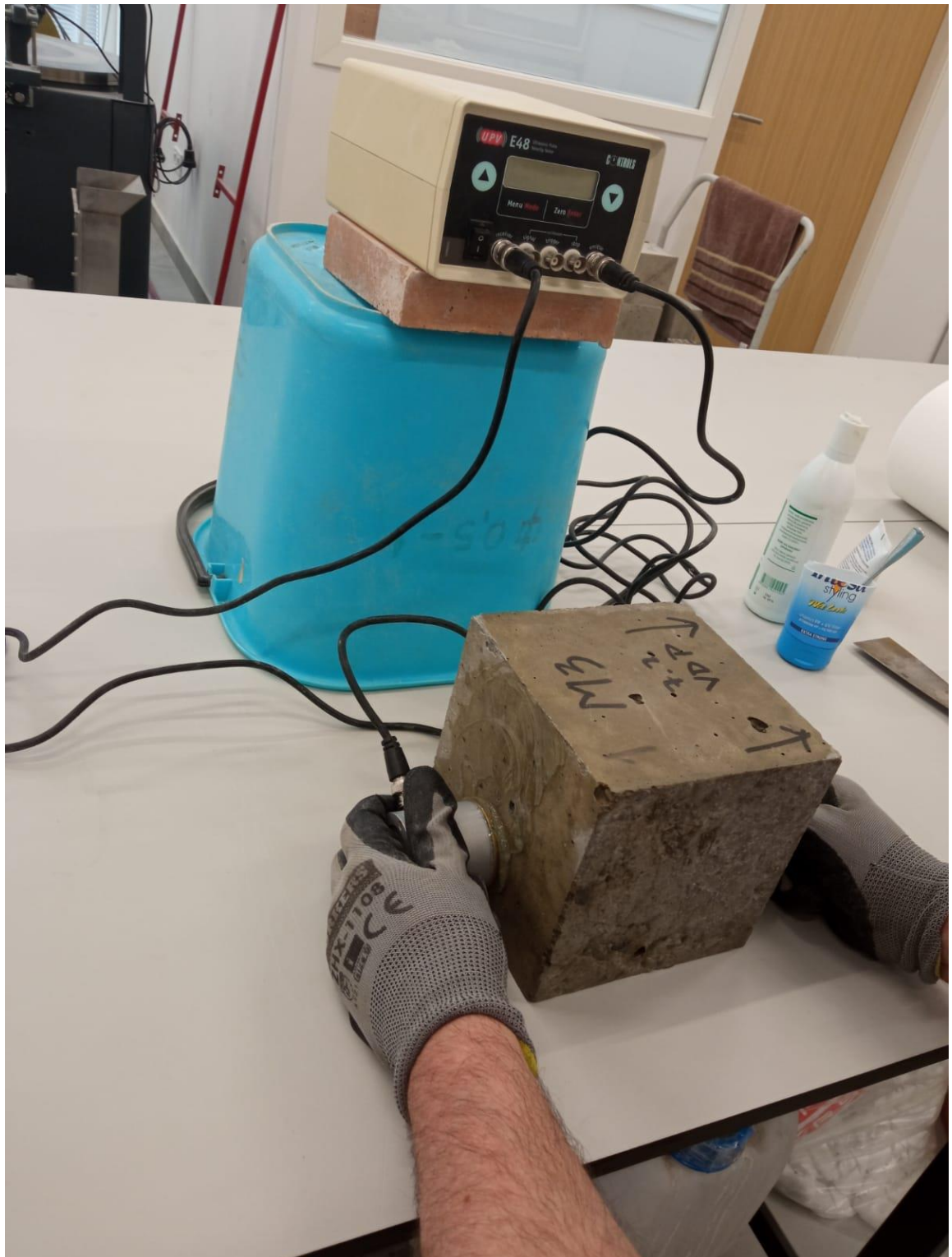
Slika 4.4.7 Ispitivanje brzine širenja ultrazvučnih valova u betonu
