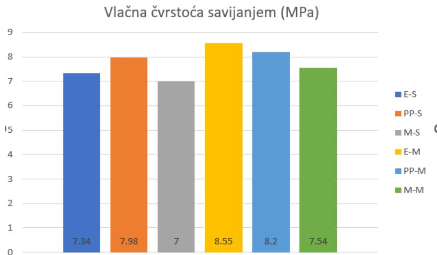
Graf 5.1.6.1 Grafički prikaz rezultata ispitivanja vlačne čvrstoće savijanjem
