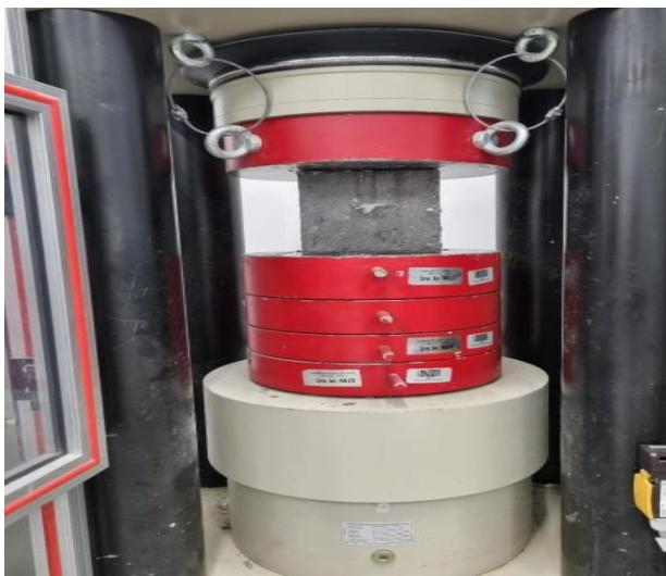
Slika 4.4.5 Ispitivanje tlačne čvrstoće [5]
