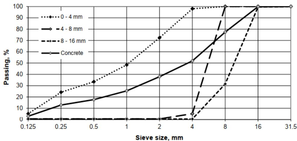
*Slika 4.2.2 Granulometrijska krivulja frakcija agregata i kumulativna krivulja agregata za beton [5]*
