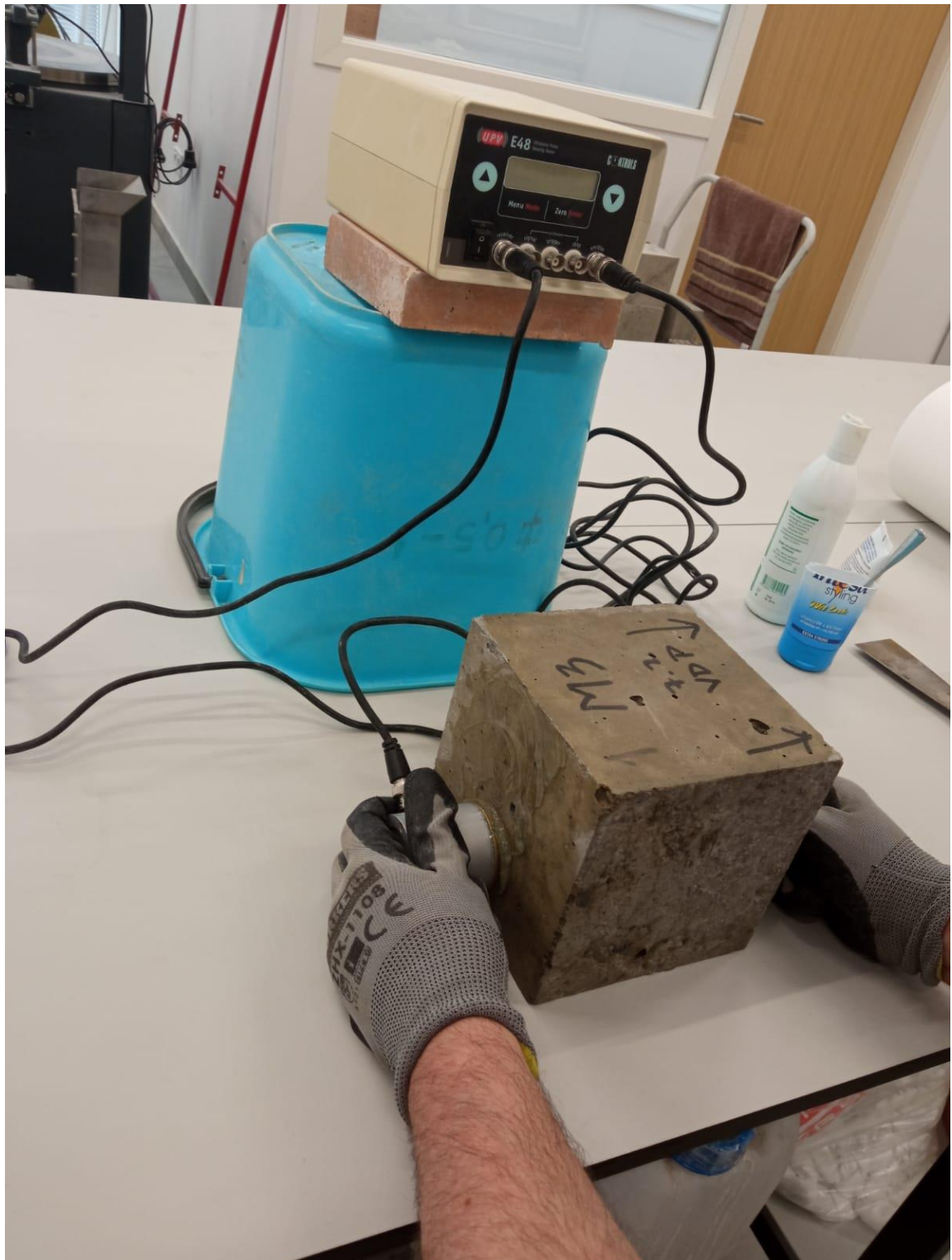
Slika 4.4.7 Ispitivanje brzine širenja ultrazvučnih valova u betonu
