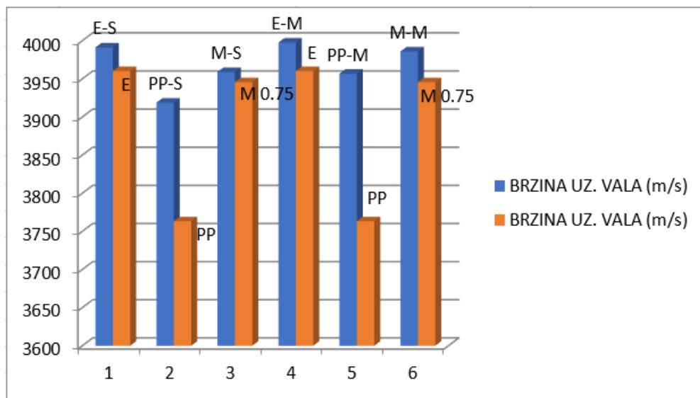
*Graf 5.1.7.1 Usporedba rezultata mjerjenja brzine ultrazvučnog vala s rezultatima iz [5]*
