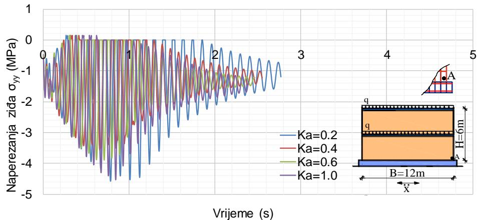
**Slika 41** Vertikalno naprezanje u ziđu u točki A pri dnu nearmiranih zidanih zidova
