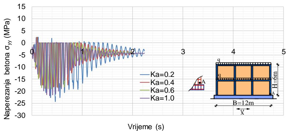
**Slika 45** Vertikalno naprezanje u betonu u točki A pri dnu omeđenih zidanih zidova
