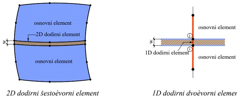
(ii) Dodirni 2D (kontaktni) elementi na spoju temelja i tla ili između morta i zida.
