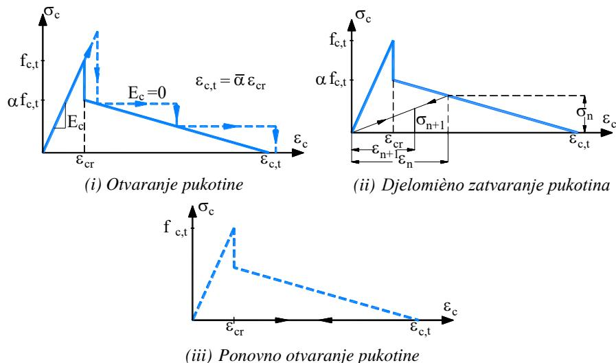
**Slika 7** Veza naprezanje-deformacija za beton nakon pojave pukotine
