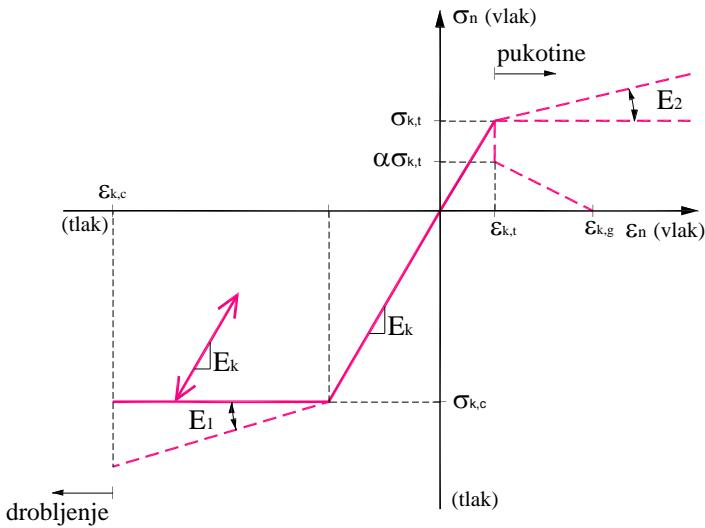
**Slika 17** Modeliranje prijenosa normalnog naprezanja 2D dodirnog elementa
