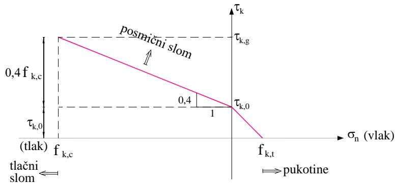
**Slika 18** Grafički prikaz posmične nosivosti 2D dodirnog elementa
