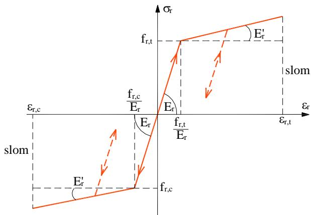
**Slika 10** Veza naprezanje-deformacija za betonski čelik (armaturu)
