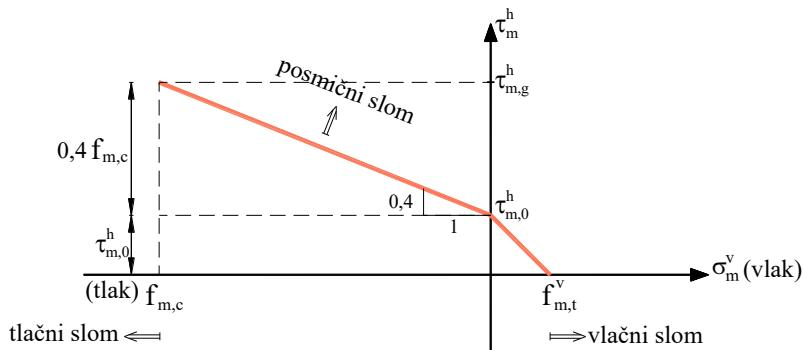
**Slika 15** Grafički prikaz posmične nosivosti ziđa u horizontalnoj ravnini
