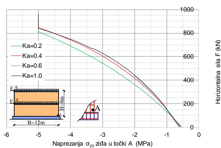
**Slika 29** Vertikalno naprezanje u zidu u točki A pri dnu nearmiranih zidanih zidova
