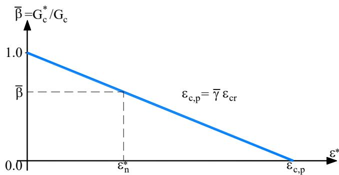
**Slika 8** Model posmične krutosti betona s pukotinama
