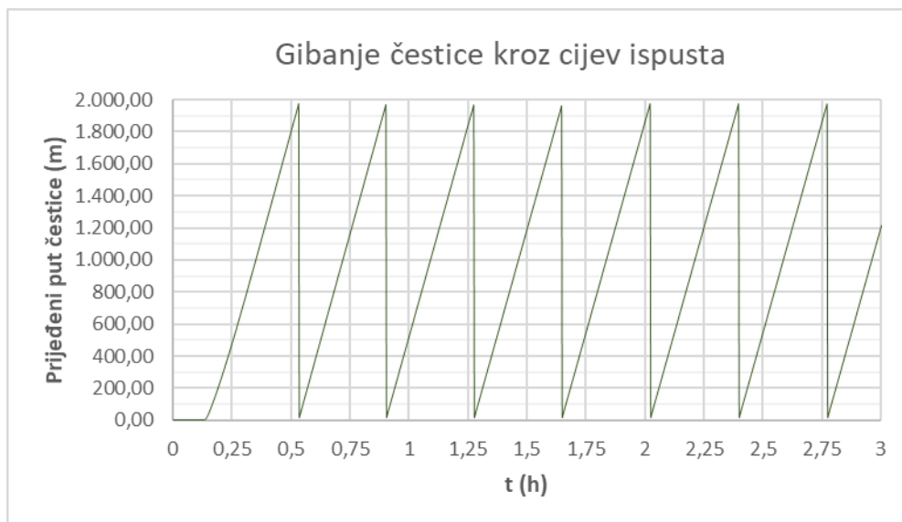
Slika 4.32. Gibanje čestice kroz cijev ispusta za varijantu 5
