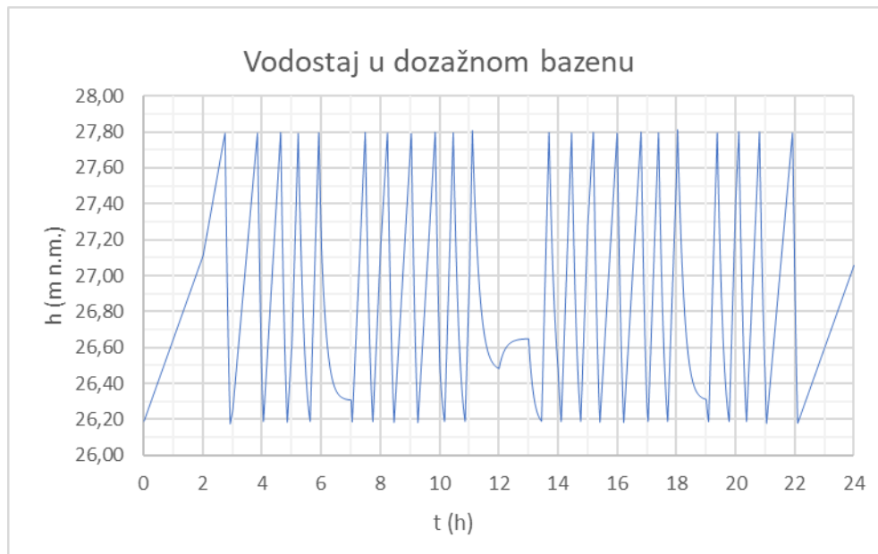
Slika 4.1. Vodostaj u dozažnom bazenu za maksimalni satni protok od 50 (l/s) u funkciji vremena
