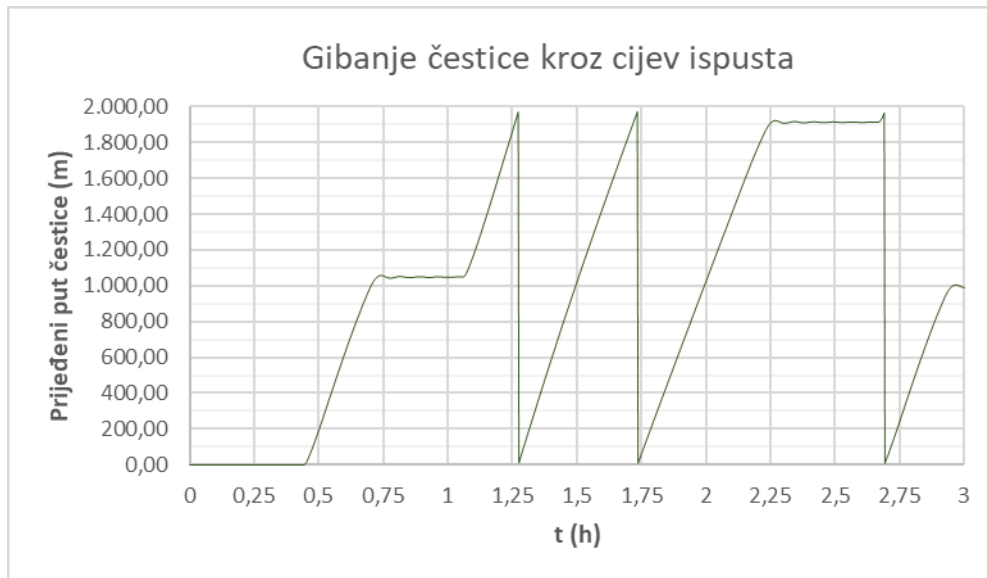
Slika 4.44. Gibanje čestice kroz cijev ispusta za varijantu 7
