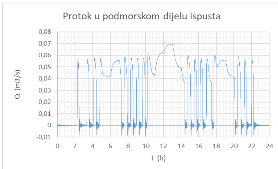
Slika 4.12. Protok u podmorskom dijelu ispusta za maksimalni satni protok od 70 (l/s)
