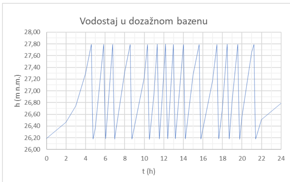
Slika 4.15. Vodostaj u dozažnom bazenu za maksimalni satni protok od 15 (l/s)
