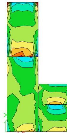
Slika 6.6 Poprečne sile V_{Ed,y} (kN/m) za GSN-1
