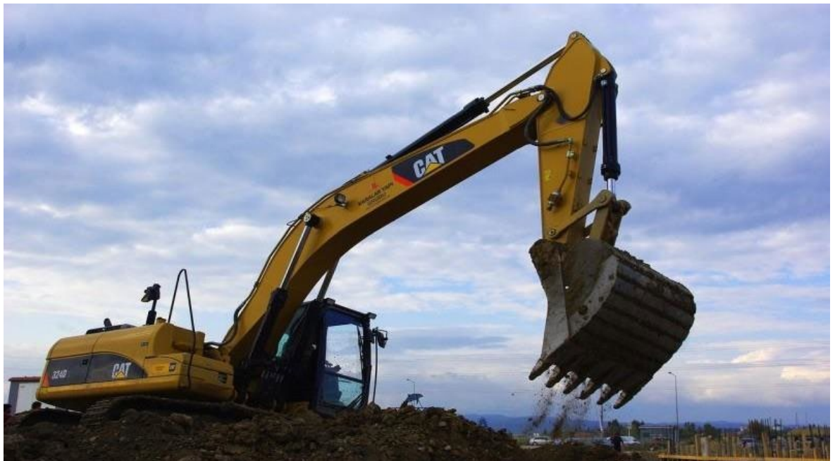
Slika 4.4. Jaružalo s dubinskom lopatom [9]
