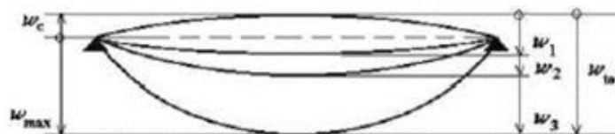
Slika 7.3 Prikaz progiba grede
