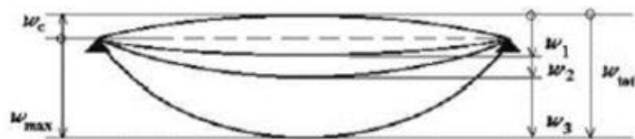
Slika 7.3 Prikaz progiba grede
