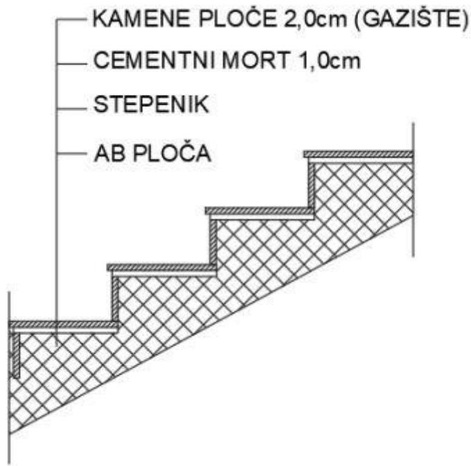
Slika 2.6. Presjek stubišta-prikaz slojeva
