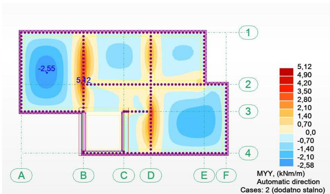
Slika 3.15. Momenti savijanja od dodatnog stalnog opterećenja u smjeru Y
