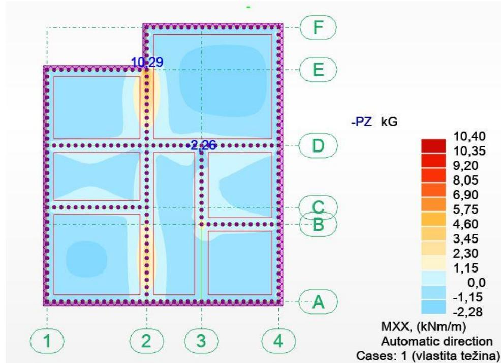
Slika 3.1. Momeneti savijanja od vlastite težine u smjeru X
