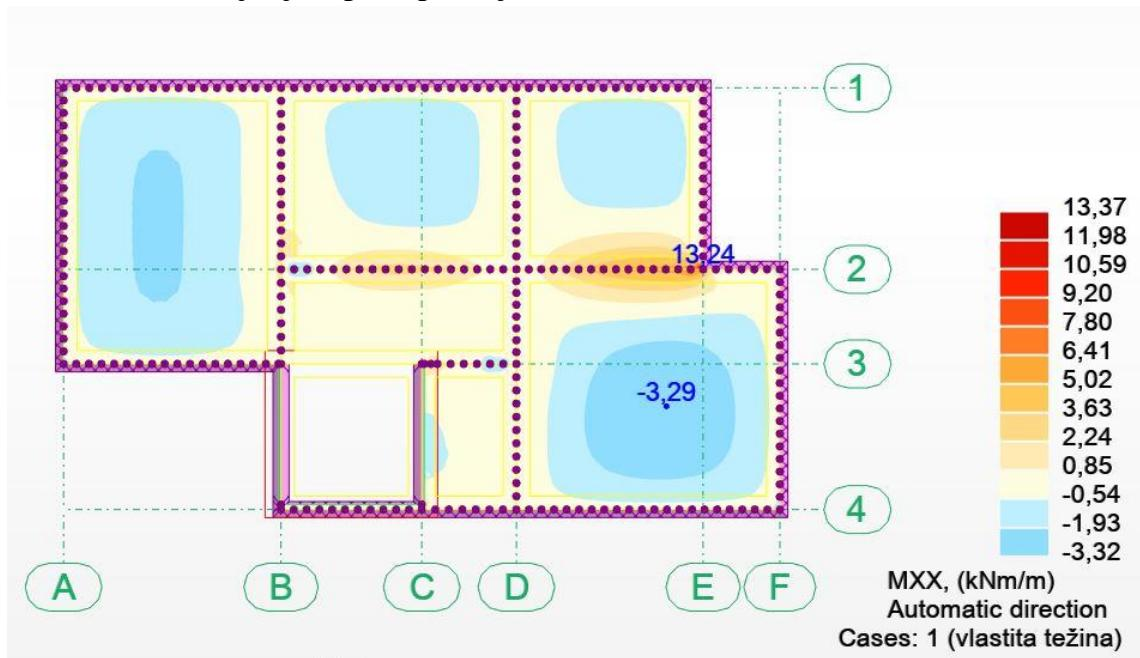
Slika 3.12. Momeneti savijanja od vlastite težine u smjeru X
