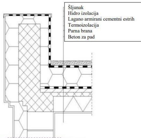
Slika 2.1 Grafički prikaz slojeva konstrukcije neprohodnog ravnog krova
