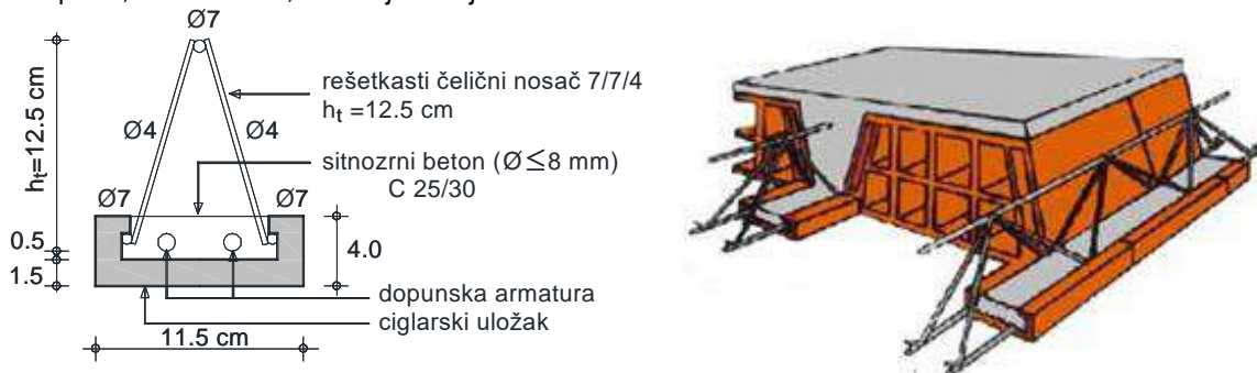
Slika 6.41 – Sustav Fert – Presjek kroz gredicu i aksonometrijski prikaz Fert stropa
