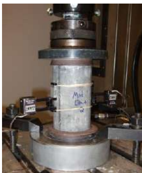
Slika 2.2 – Testiranje uzorka betona
