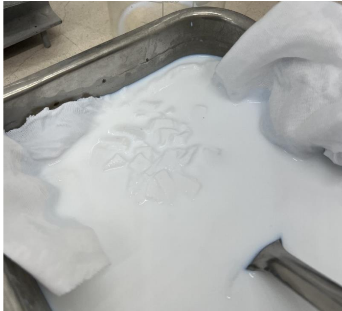
Slika 5.7.2. Tekstilne krpice u vodenj otolini Betona 1
