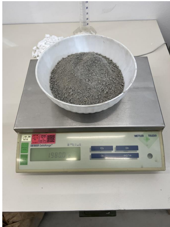
Slika 5.7.1. Suha mješavina cementnog estriha - mjerenje količine
