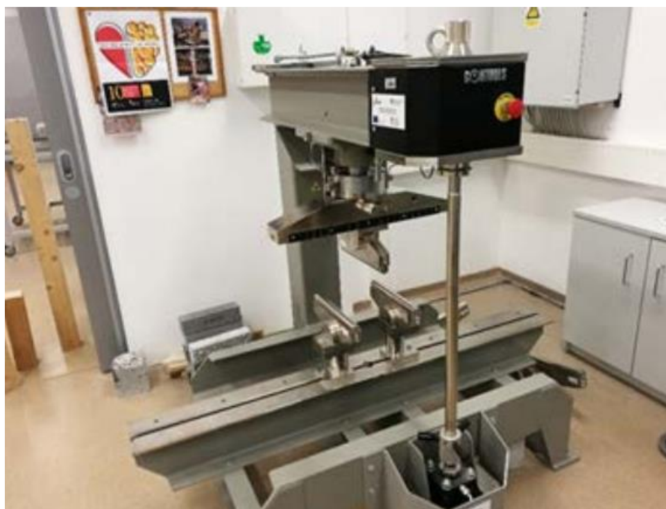
Slika 5.8.1. Okvir za ispitivanje savojne čvrstoće [27]
