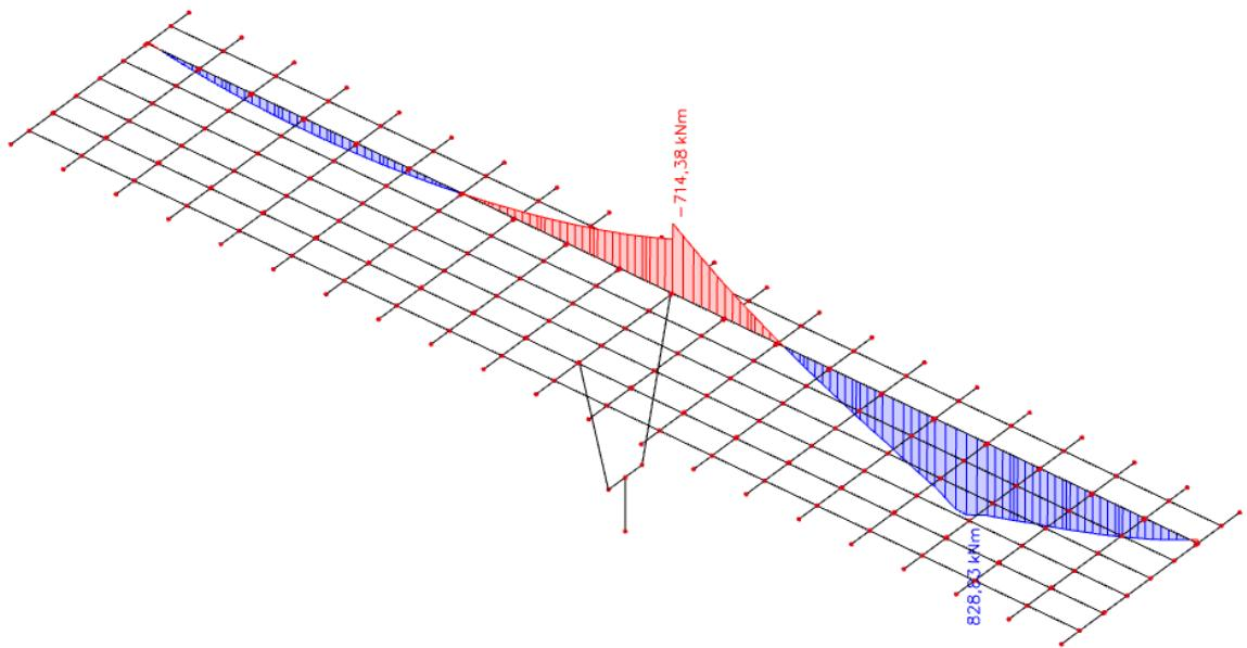
Slika 23. Pokretno opterećenje - maksimalni moment pri stupu - momentni dijagram  $M_y$  ( $\text{kNm}$ )
