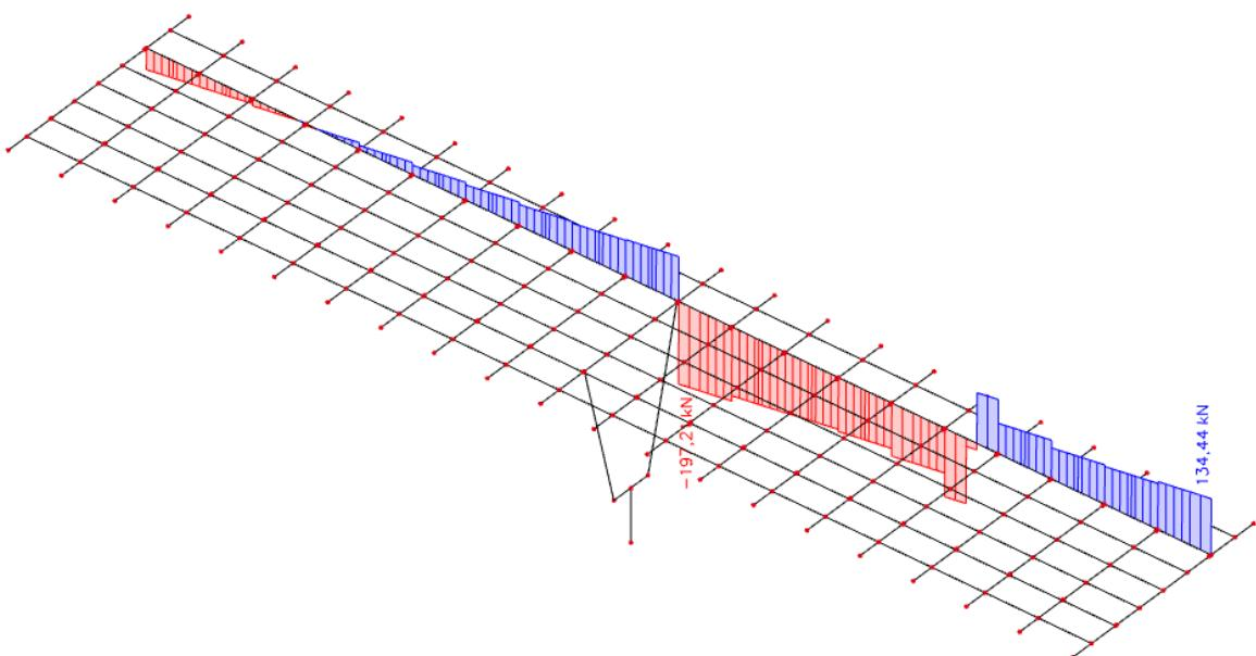
Slika 24. Pokretno opterećenje - maksimalni moment pri stupu – dijagram poprečne sile  $V_z$  ( $\text{kN}$ )
