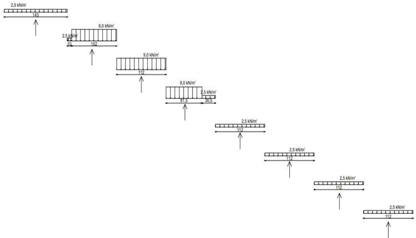
Slika 15. Prikaz raspodjele kontinuiranog opterećenja
