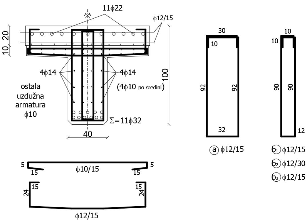
Slika 32. Prikaz armiranja nosača u presjeku a-a
