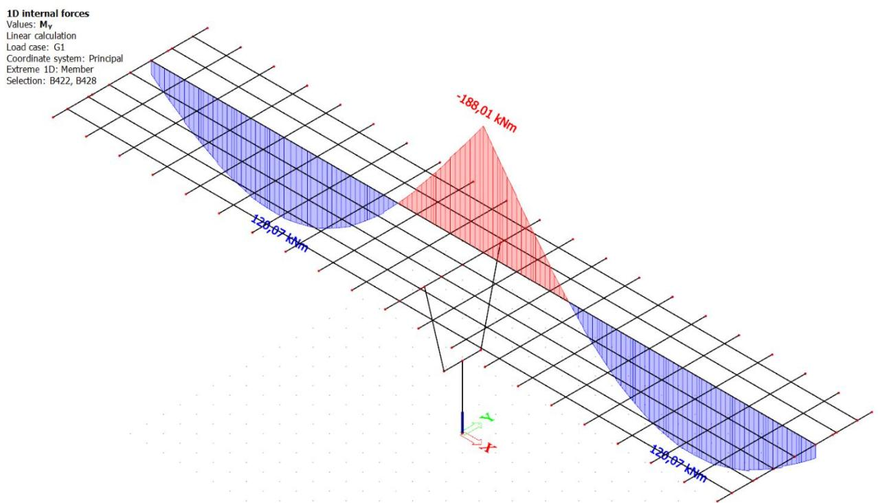
Slika 10. Dodatno stalno opterećenje – momenti ( $M_y$ ) u kNm
