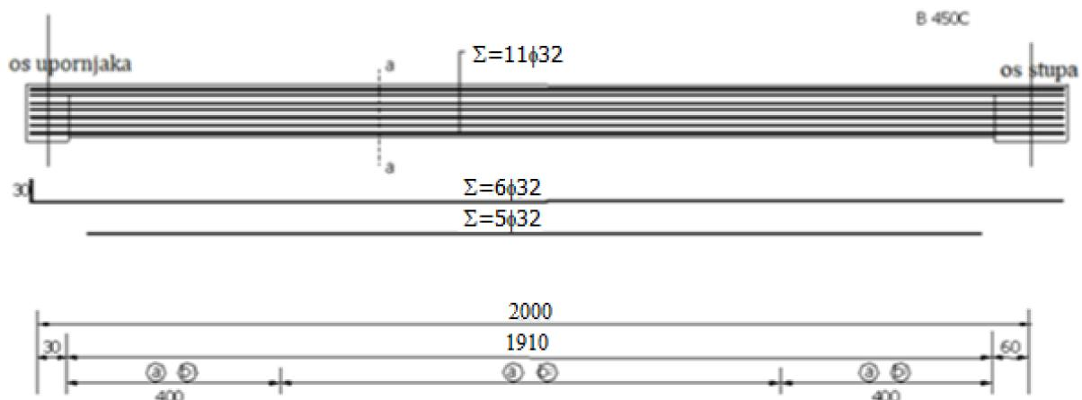
Slika 31. Prikaz armiranja uzdužnog nosača u polju
