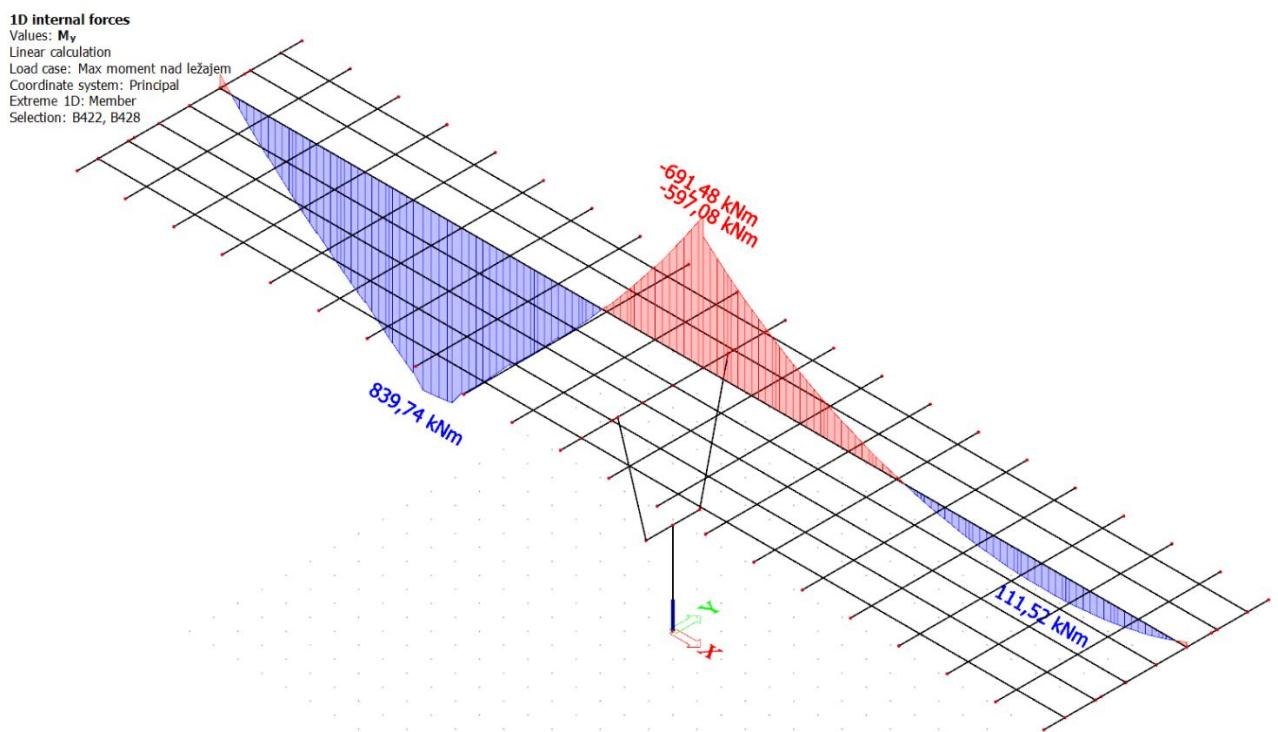
Slika 19. Pokretno – maksimalni moment nad stupom – momenti ( $M_y$ ) u kNm
