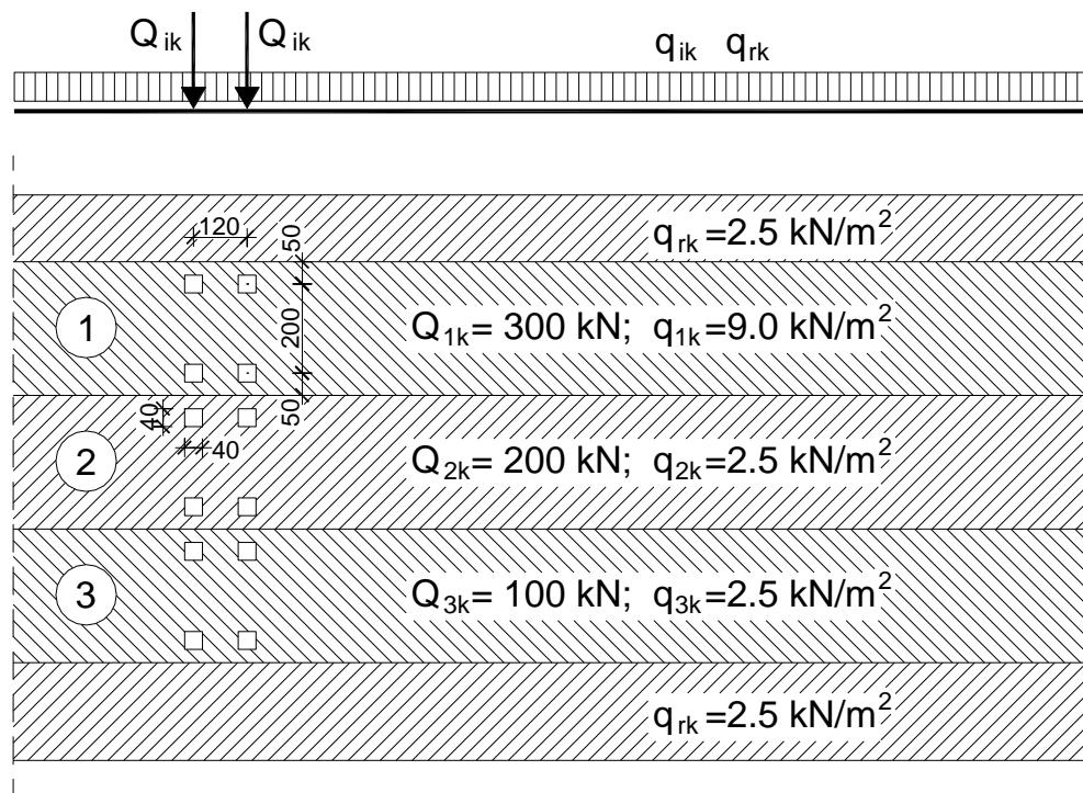
Slika 12. Prikaz načina opterećivanja mosta pokretnim opterećenjem
