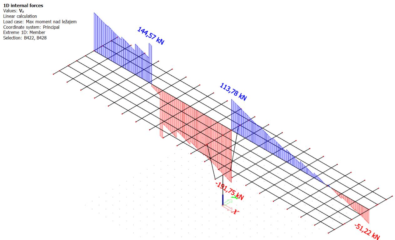
Slika 20. Pokretno – maksimalni moment nad stupom – poprečne sile ( $V_z$ ) u kN
