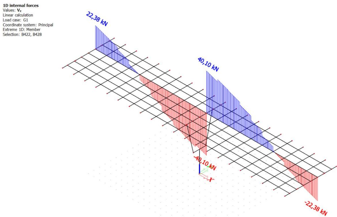
Slika 11. Dodatno stalno opterećenje – poprečne sile ( $V_z$ ) u kN
