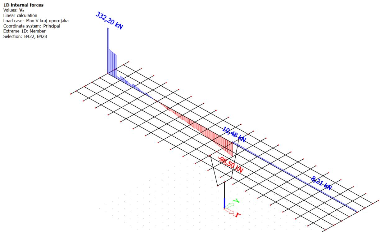
Slika 24. Pokretno – maksimalna poprečna sila pri upornjaku – poprečne sile ( $V_z$ )
