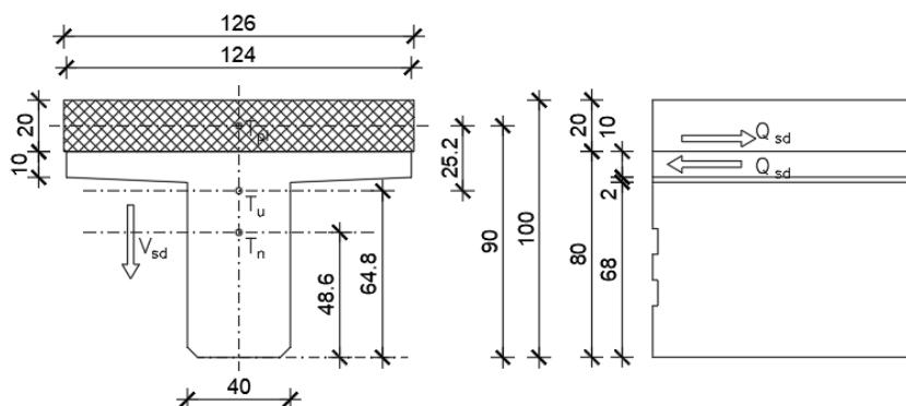
*Slika 30. Poprečni presjek spregnutog T nosača*
