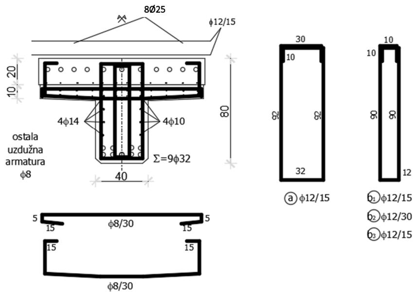
Slika 33. Prikaz armiranja nosača u presjeku a-a
