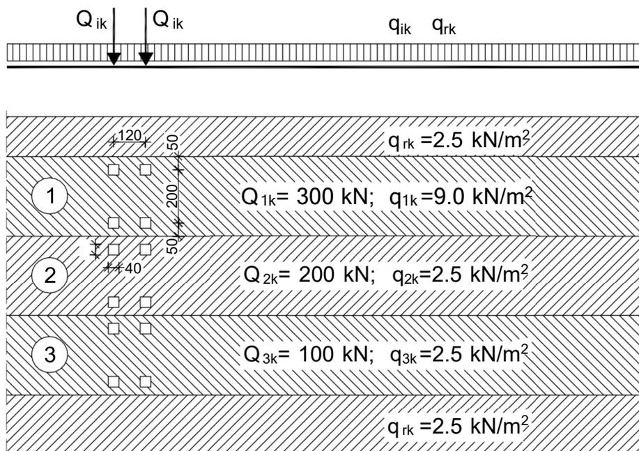
Slika 13. Prikaz načina opterećivanja mosta pokretnim opterećenjem
