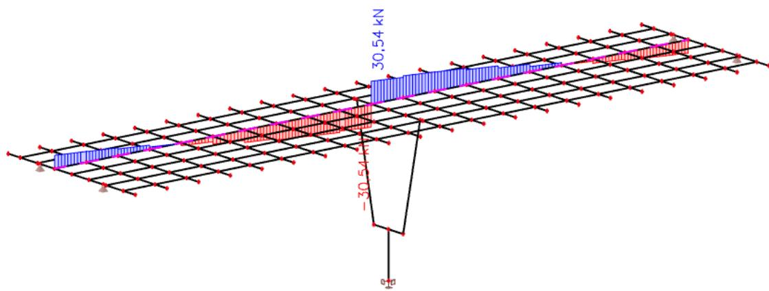
Slika 13: Dodatno stalno opterećenje – poprečna sila ( $V_z$ ) u  $kN$
