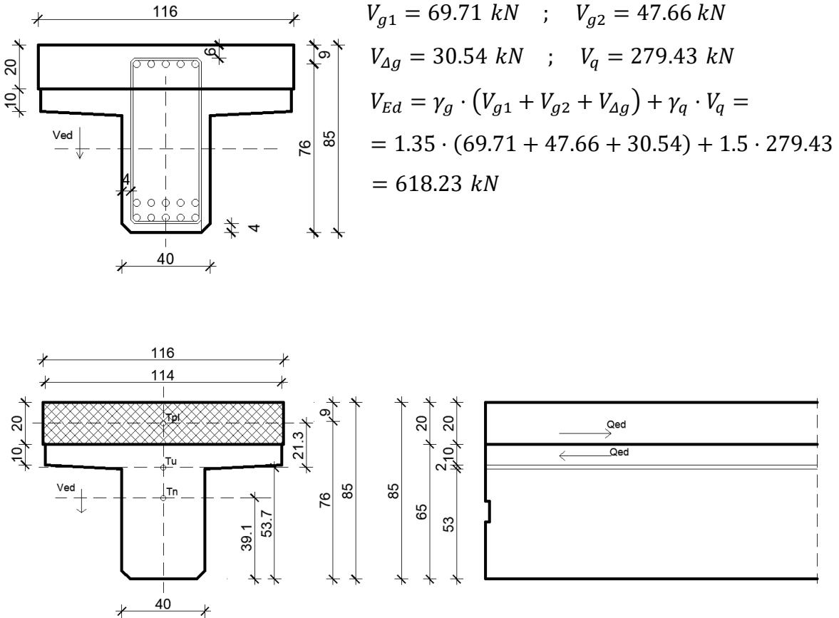
Slika 32: Poprečni presjek spregnutog T nosača
