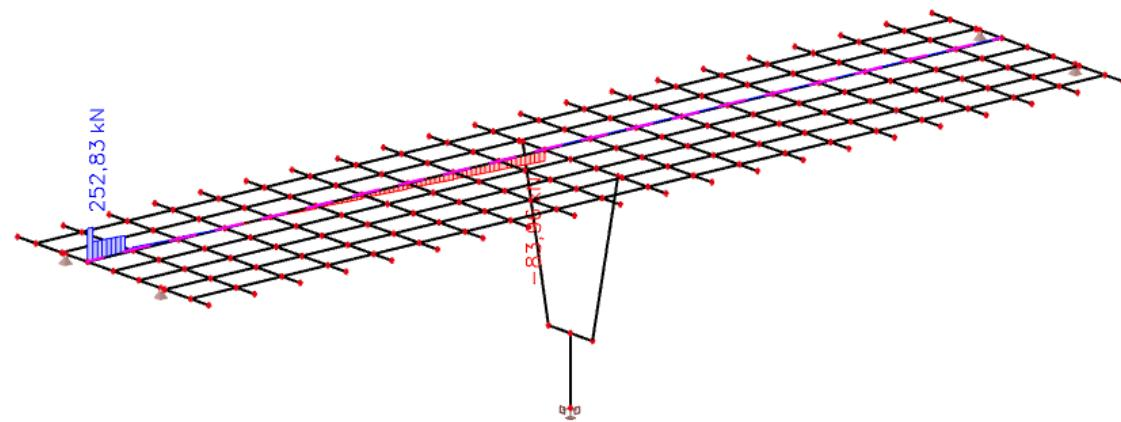
Slika 26: Pokretno opterećenje – maksimalna poprečna sila pri upornjaku – poprečne sile ( $V_z$ )  $\text{kN}$
