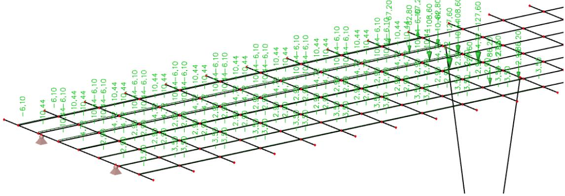
*Slika 27: Pokretno opterećenje za maksimalnu poprečnu silu pri stupu*
