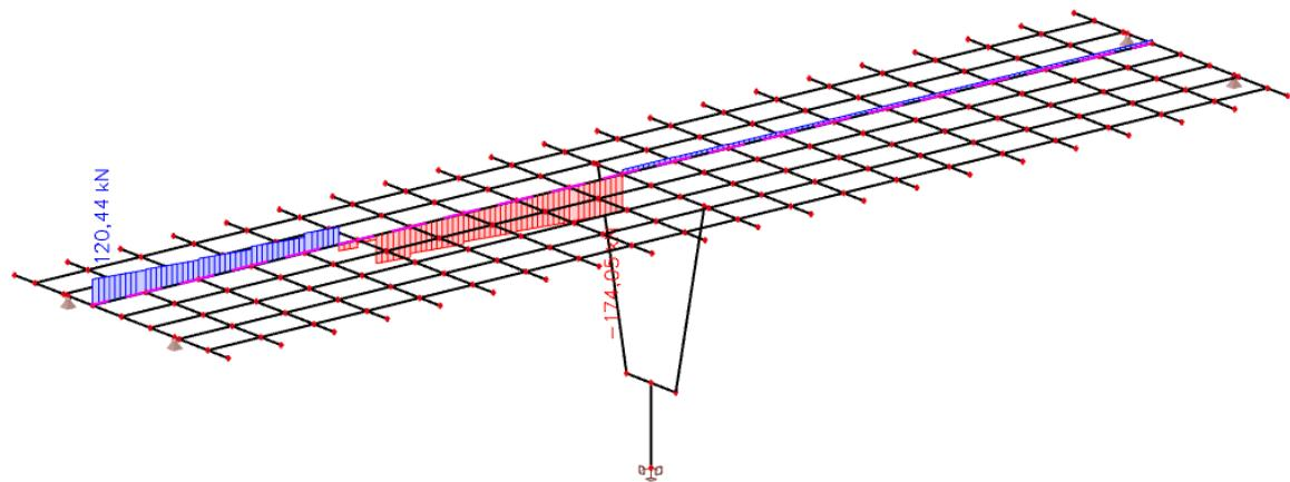
Slika 18: Pokretno opterećenje – maksimalni moment u prvom polju – poprečne sile ( $V_z$ ) kN
