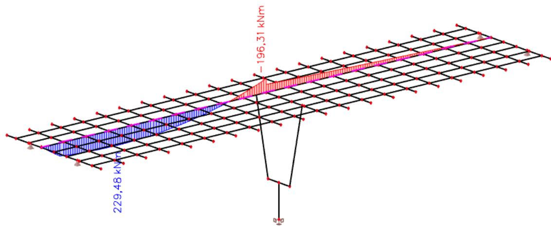
Slika 25: Pokretno opterećenje – maksimalna poprečna sila pri upornjaku – momenti ( $M_y$ )  $\text{kNm}$
