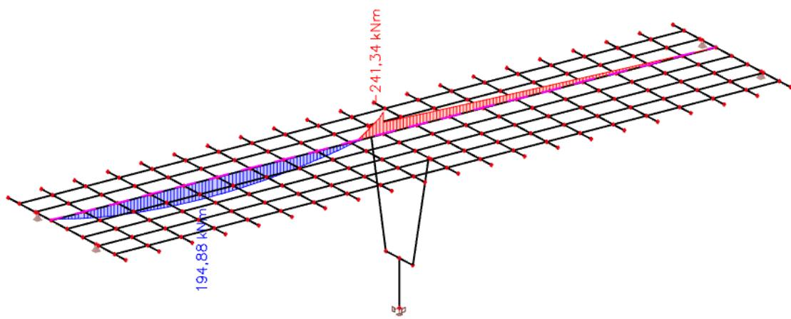
Slika 29: Pokretno opterećenje – maksimalna poprečna sila pri stupu – momenti ( $M_y$ ) kNm
