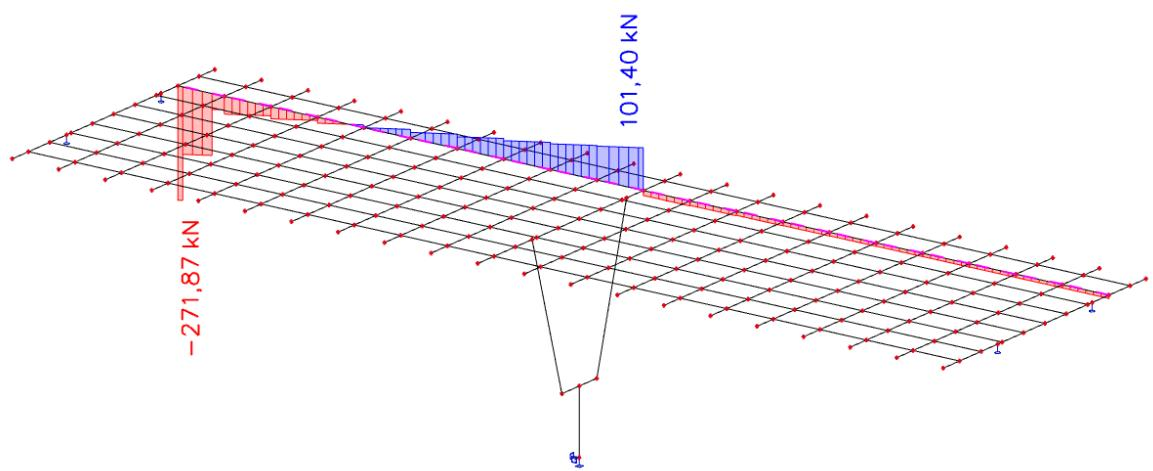
Slika 30. Pokretno opterećenje – maksimalna poprečna sila pri upornjaku – poprečne sile  $V_z$  ( $kN$ )
