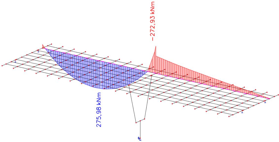
Slika 25. Pokretno opterećenje – maksimalna poprečna sila pri stupu – momenti  $M_y$  (kNm)
