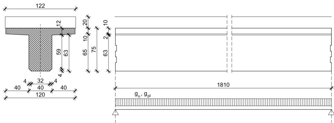
Slika 2. Uzdužna i poprečna dispozicija jednog nosača
