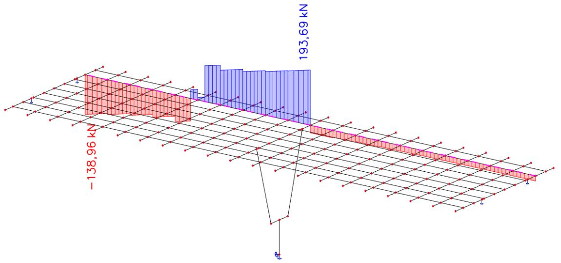
Slika 18. Pokretno opterećenje – maksimalni moment u polju – poprečne sile  $V_z$  (kN)
