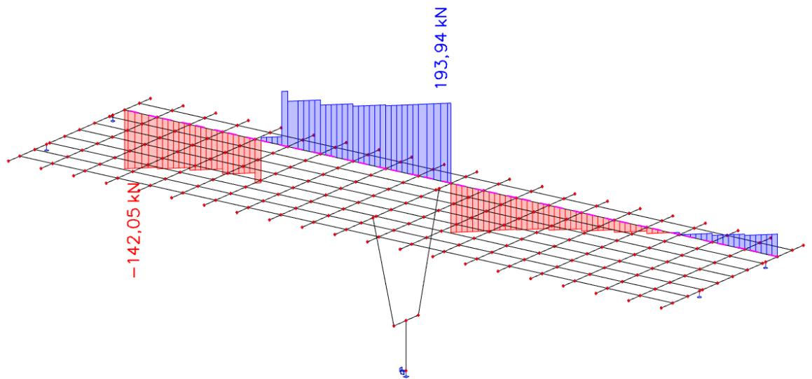
Slika 22. Pokretno opterećenje – maksimalni moment pri stupu – poprečne sile  $V_z$  (kN)
