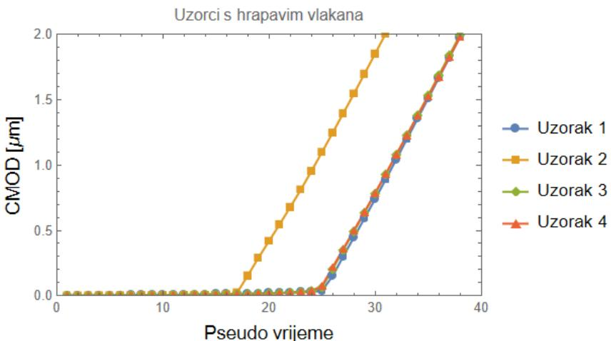
Grafikon 4. Horizontalni pomak otvora pukotine grede za uzorke s hrapavim vlaknima
