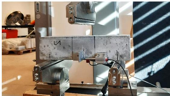
**Slika 1.** Konfiguracija testa savijanja s postavljenim mjeračem pomaka otvora pukotine CMOD je od svih rezultata dobivenih laboratorijskim ispitivanjem jedina veličina koja direktno povezuje poprečni i uzdužni presjek grede. Analizom te veličine moguće je dobiti uvid u utjecaj materijalnih parametara, kao što su oni koji opisuju vlakna u betonu, na globalni odziv grede pri opterećenju.
