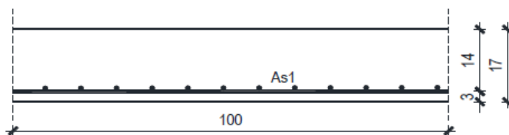
Slika 10.122. Skica armature ploče u polju
