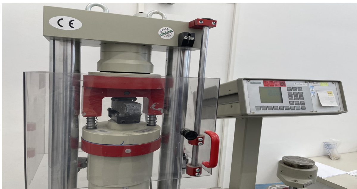
Slika 27. Ispitivanje savojne čvrstoće UHPC betona
