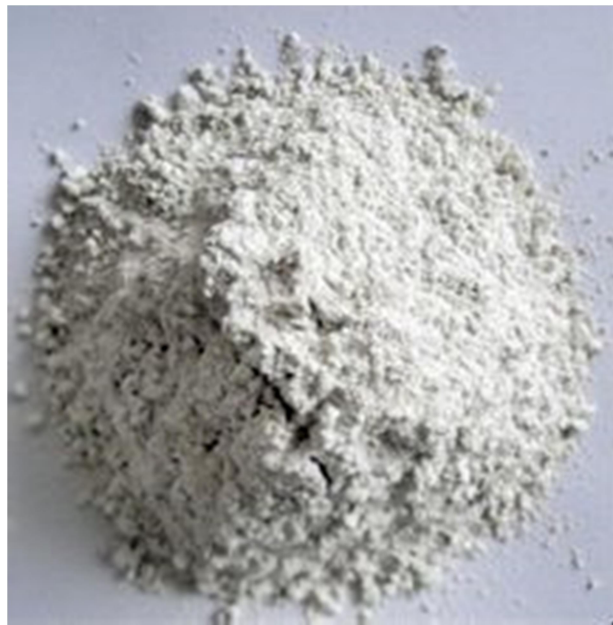
Slika 10. Granulirana zgora visoke peći [18]
