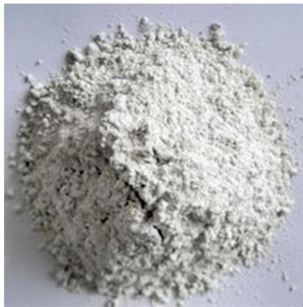
Slika 10. Granulirana zgura visoke peći [18]
