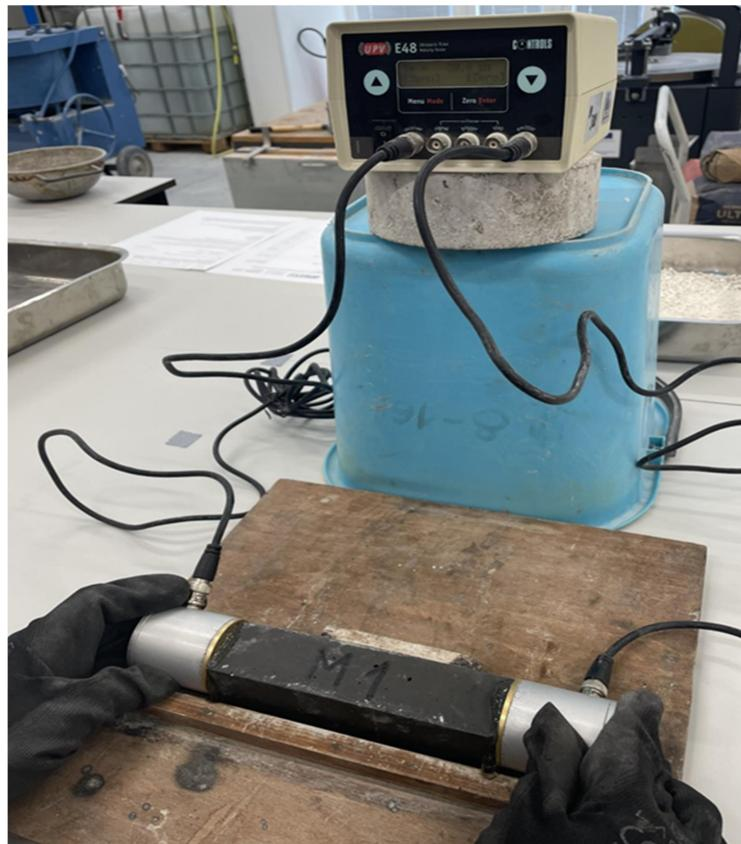
Slika 25. Ispitivanje brzine ultrazvuka
