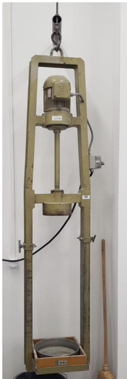
Slika 16. Uređaj za prosijavanje agregata
