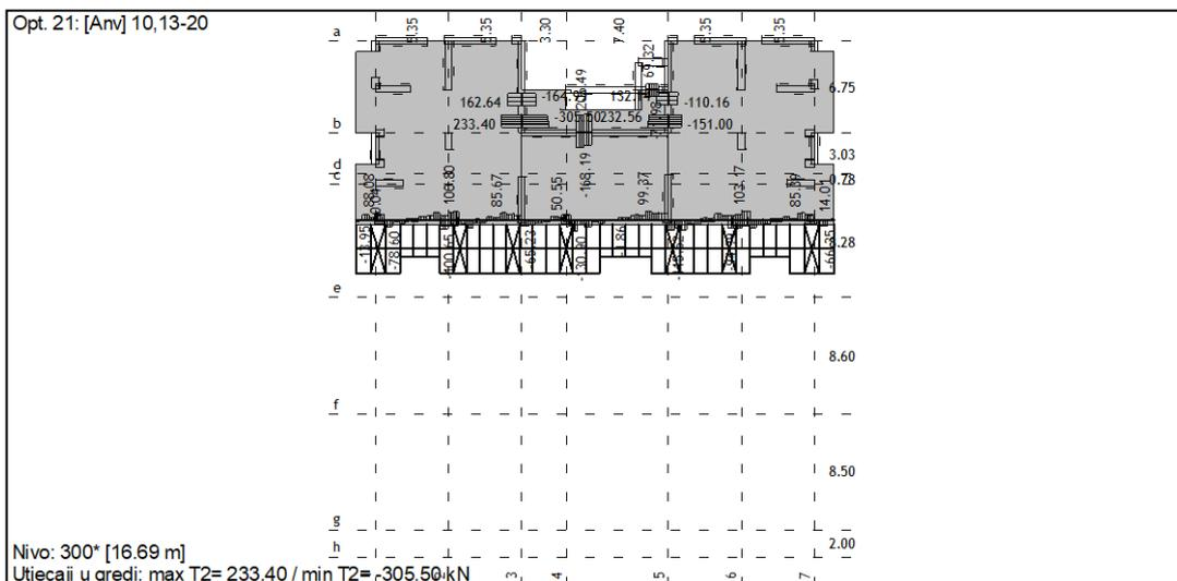
**Grede pozicija 200:  $M_y$  (kNm),  $V$  (kN),  $N$  (kN)**
