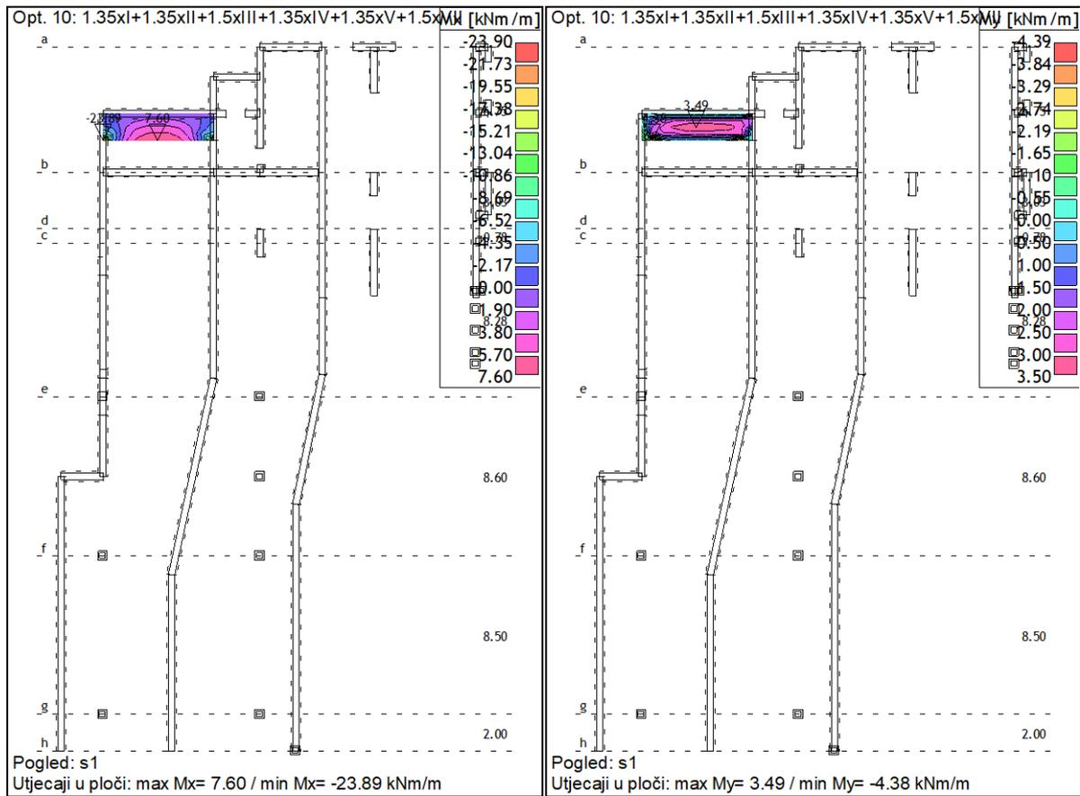
Slika 193, Relevantne rezne sile stubišta s1
