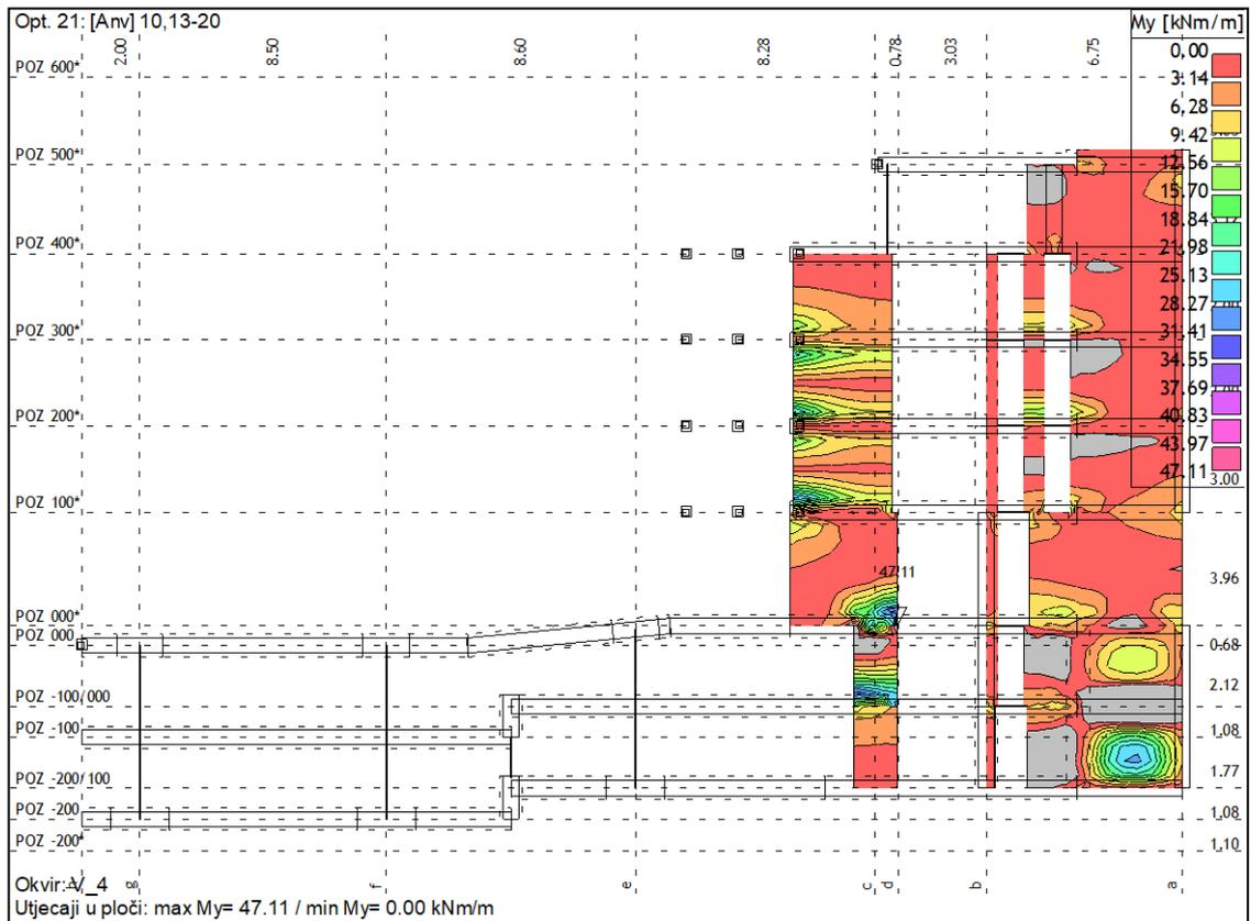
Slika 184, Rezne sile okvir V4
