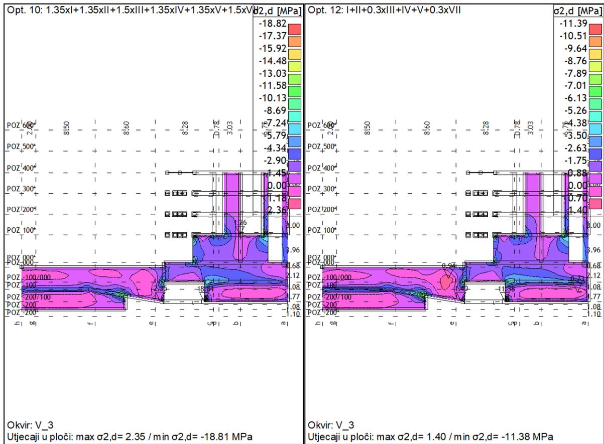
Slika 178, Naprezanja u okviru V3
