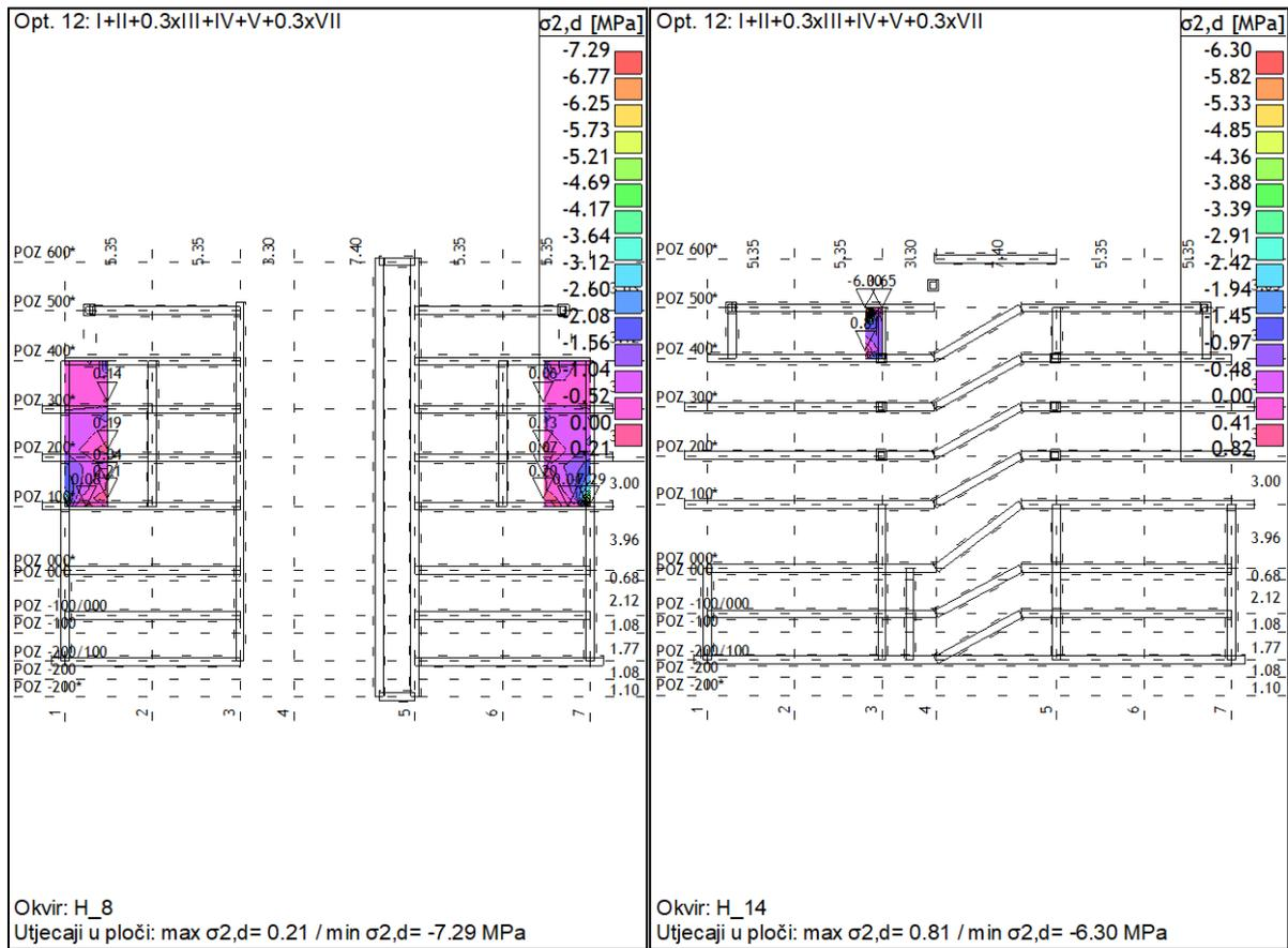
Slika 141, Naprezanja u okviru H8
