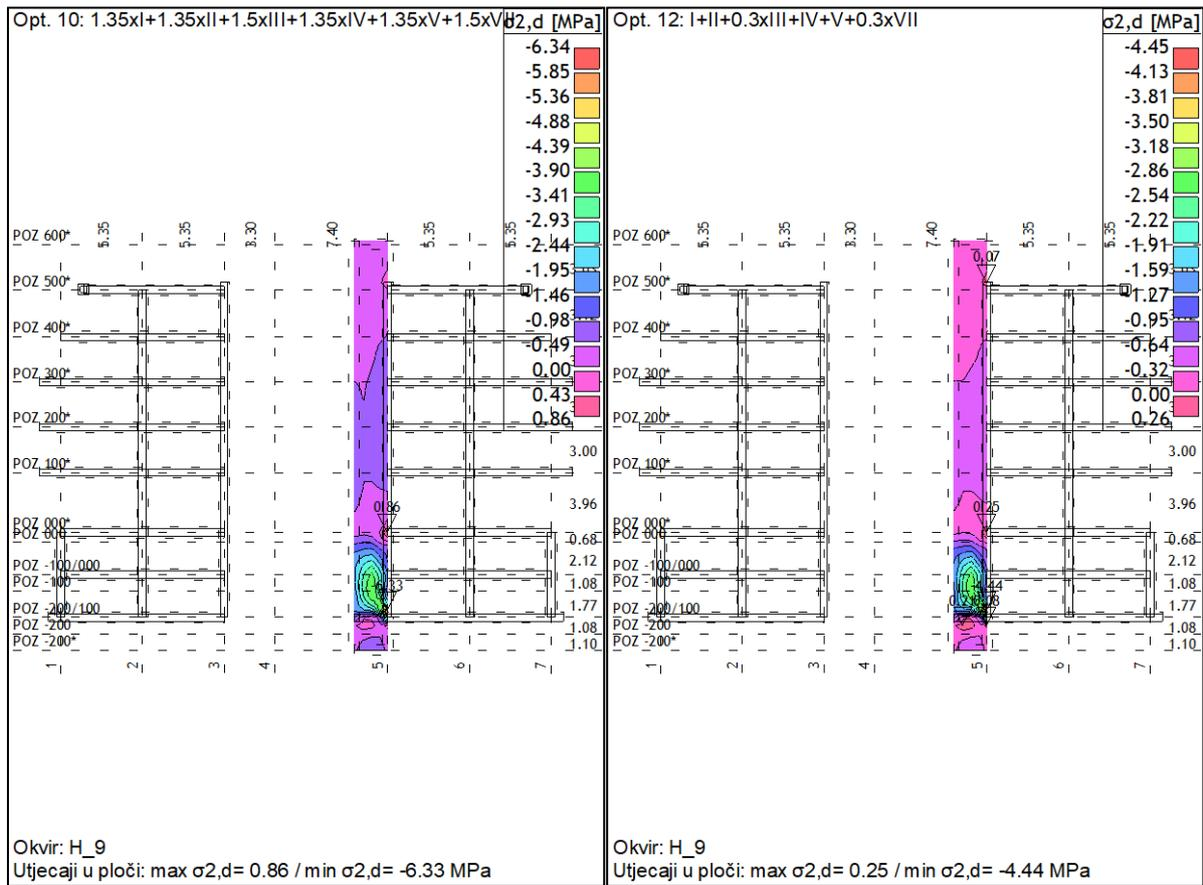
Slika 137, Naprezanja u okviru H9
