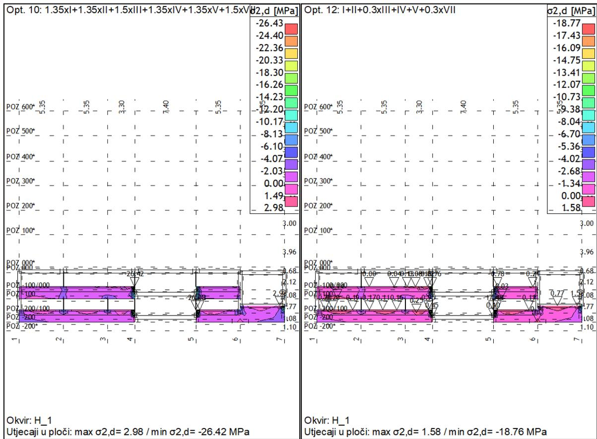
Slika 150, Naprezanja u okviru H1
