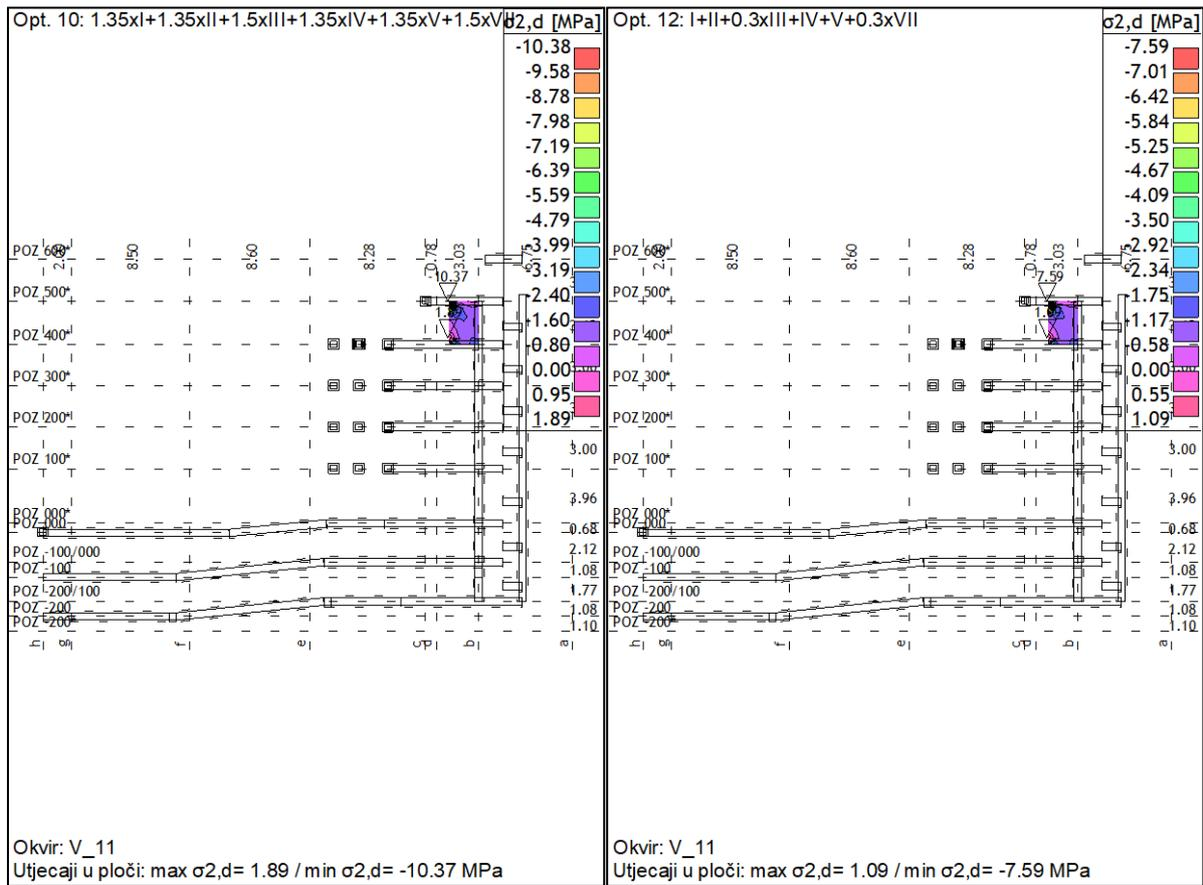
Slika 168, Naprezanja u okviru VII
