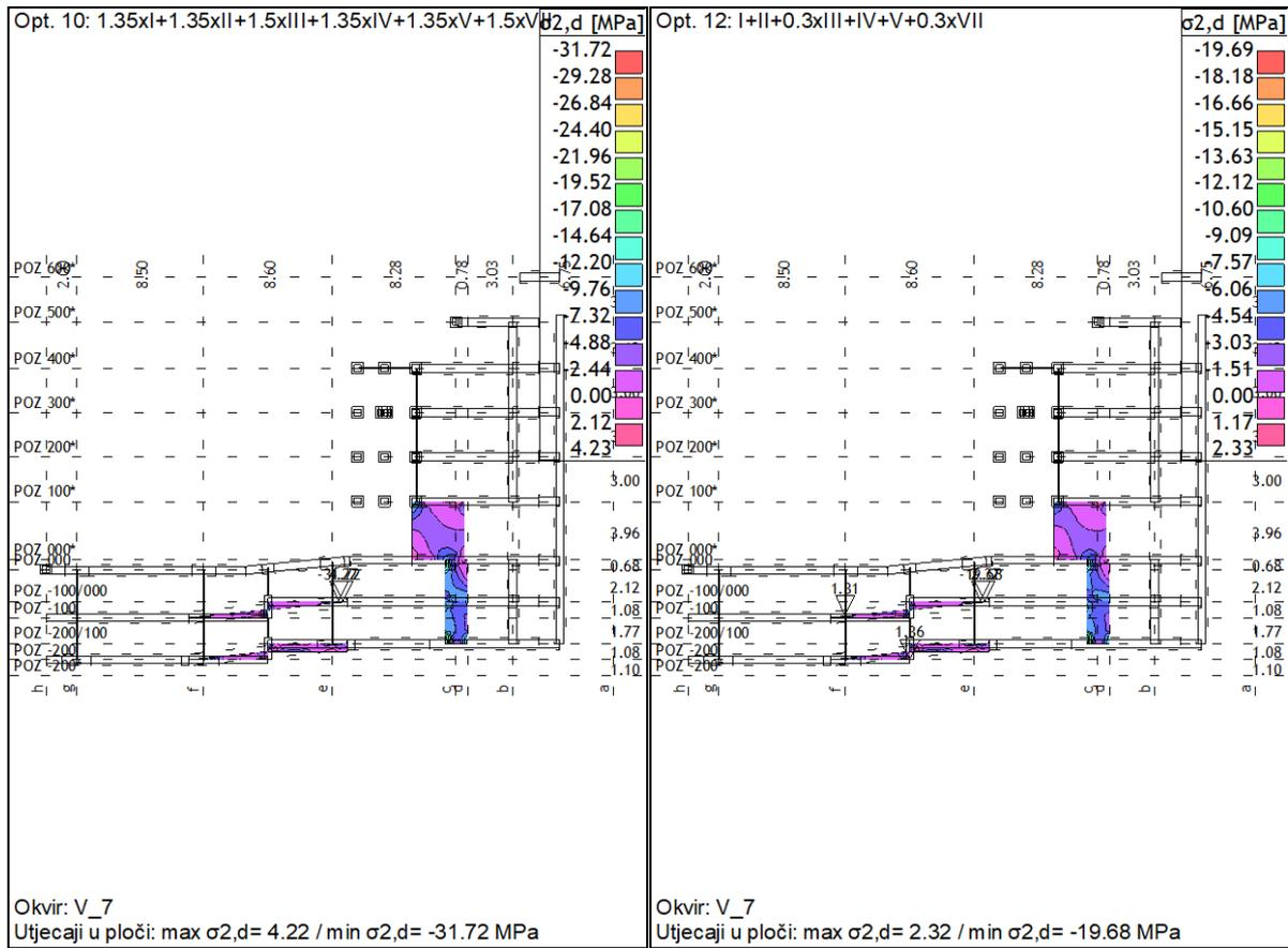
Slika 166, Naprezanja u okviru V7
