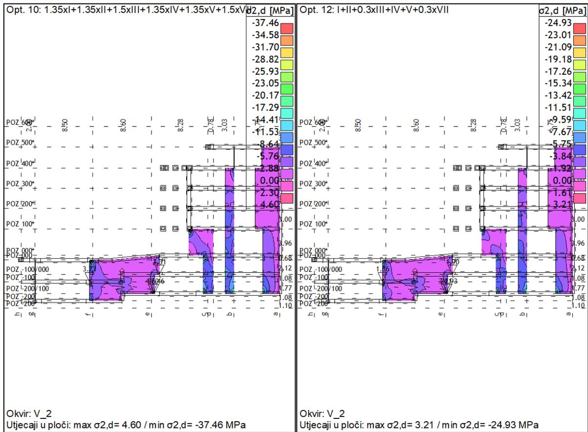
Slika 174, Naprezanja u okviru V2
