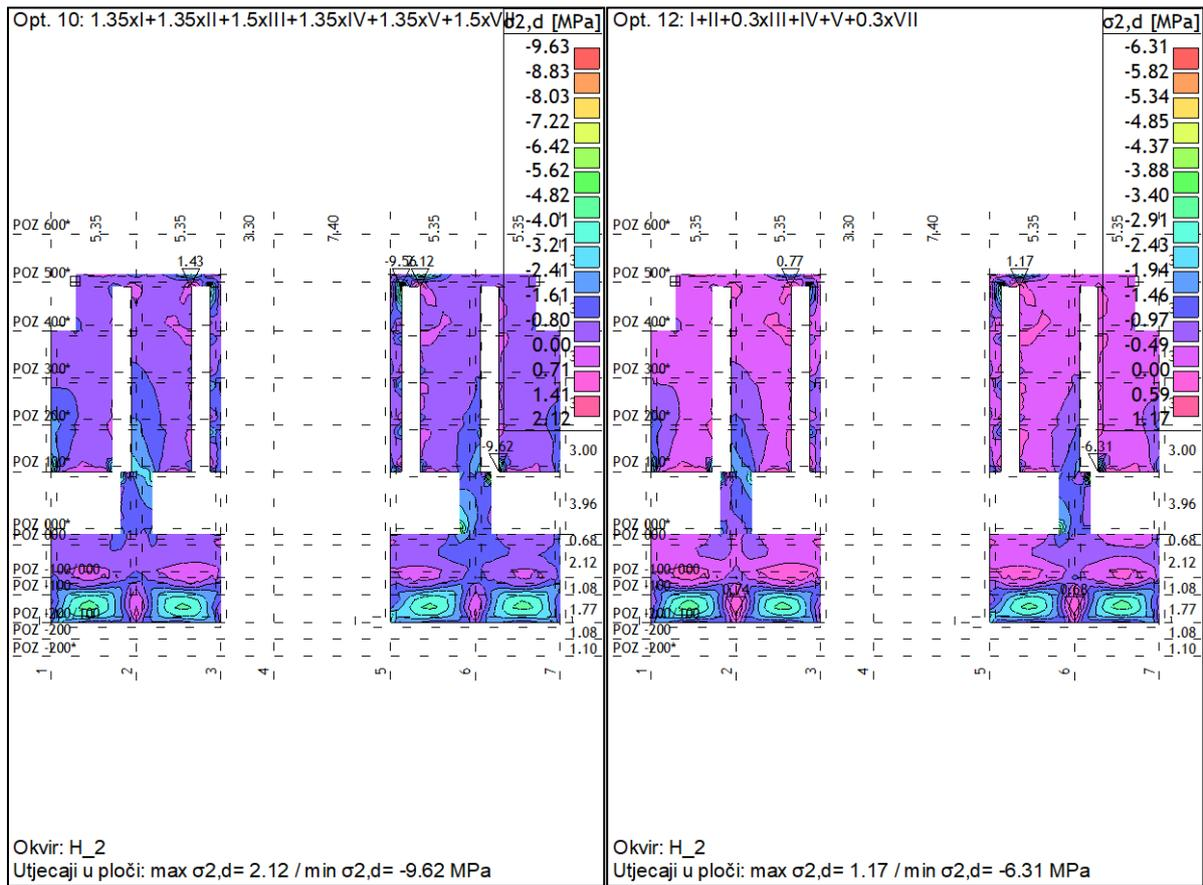
Slika 135, Naprezanja u okviru H2
