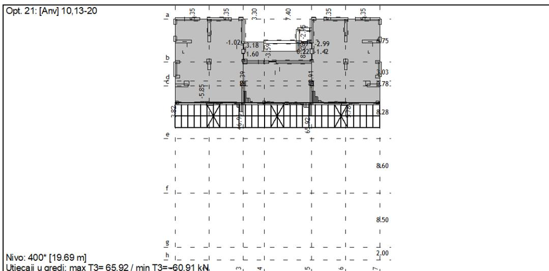
**Grede pozicija 300:  $M_x$  (kNm),  $M_y$  (kNm),  $V_x$  (kN),  $V_y$  (kN),  $N$  (kN)**
