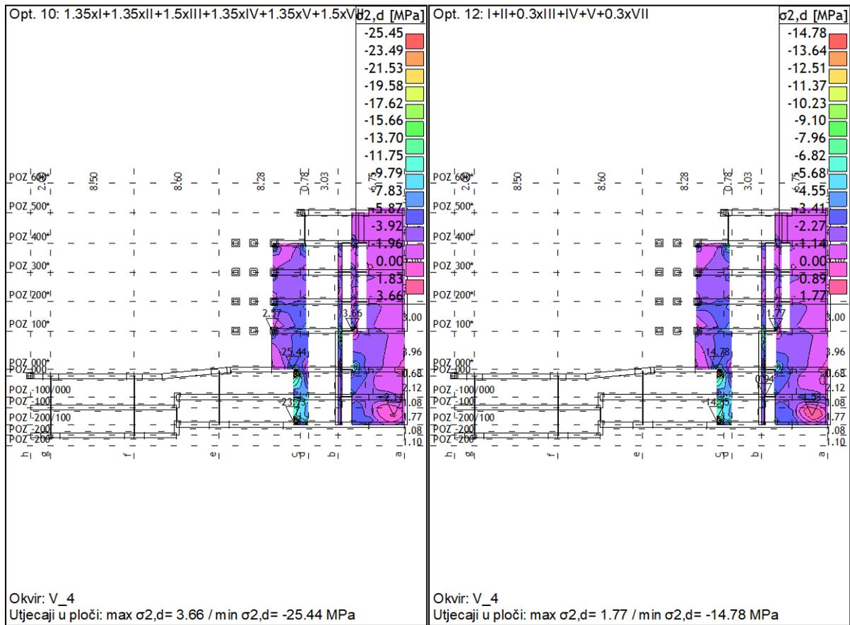
Slika 162, Naprezanja u okviru V4
