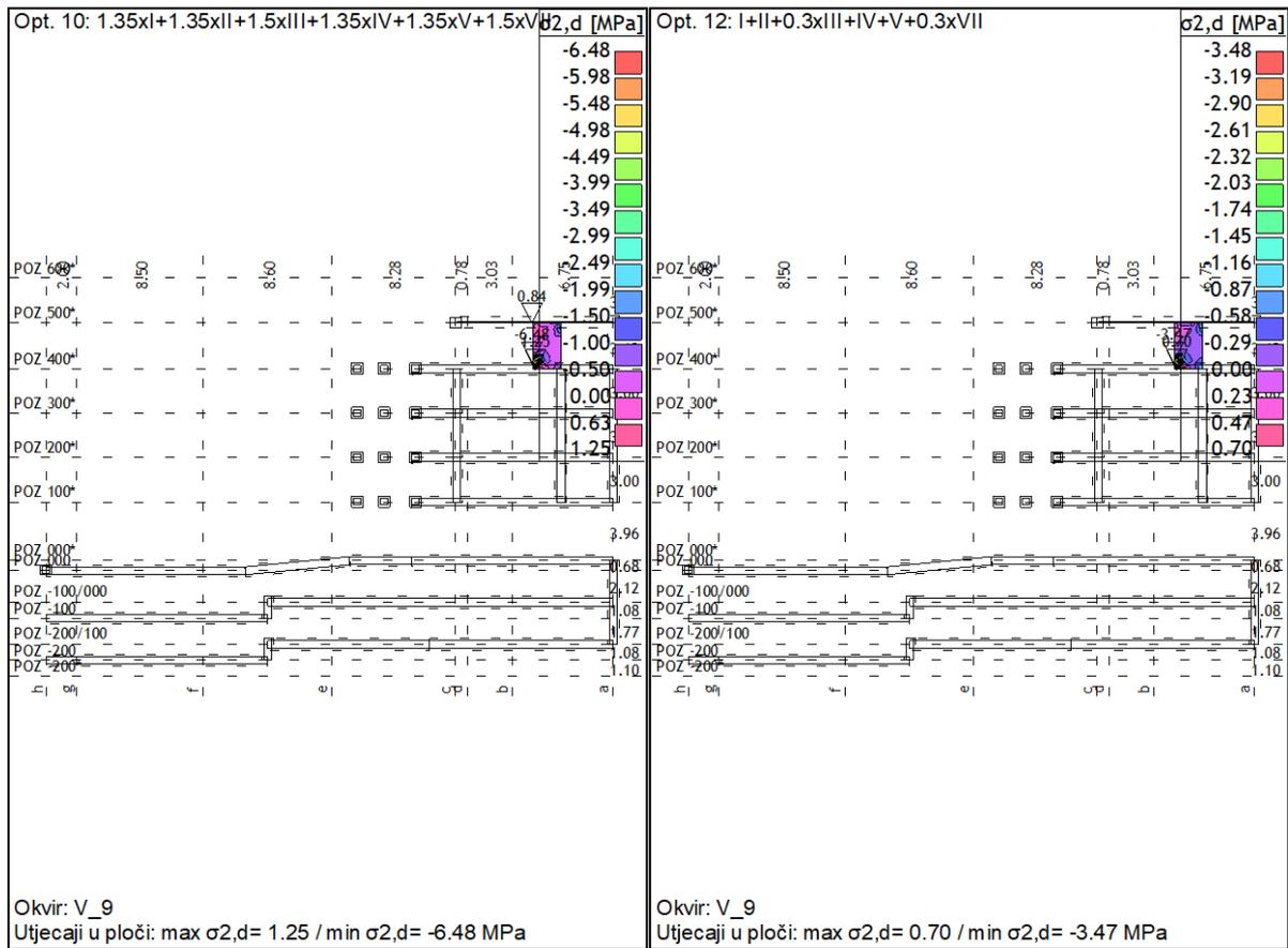
Slika 158, Naprezanja u okviru V9
