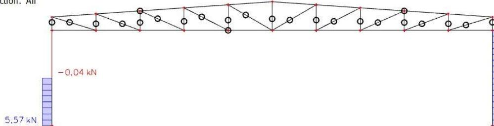
Slika 4.2.2. Dijagram poprečnih sila za 2. kombinaciju
