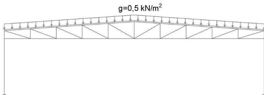
*Slika 2.1.1. Stalno opterećenje od vlastite težine po površini*
