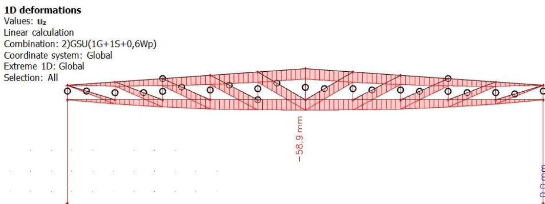
Slika 3.1.1. Vertikalni progib rešetke
