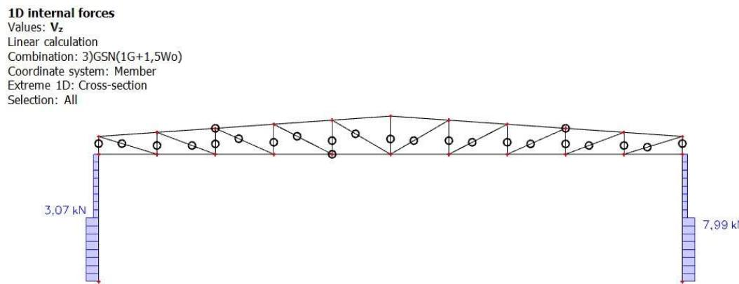
Slika 4.3.2. Dijagram poprečnih sila za 3. kombinaciju
