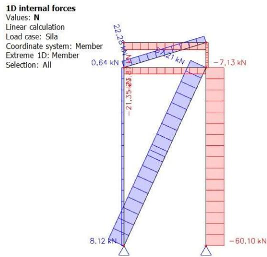
Slika 5.5.1. Dijagram uzdužnih sila kod bočnog sprega
