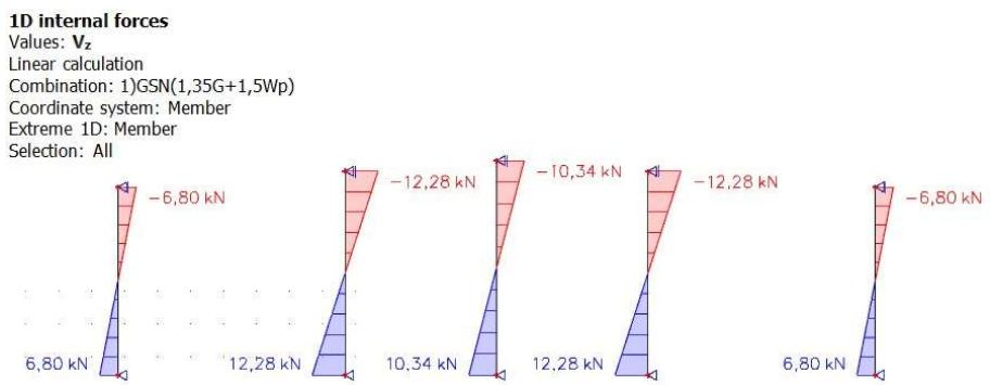
Slika 5.3.3. Dijagrami poprečnih sila u smjeru osi z
