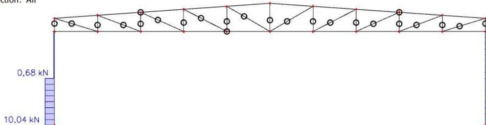
Slika 4.1.2. Dijagram poprečnih sila za 1. kombinaciju
